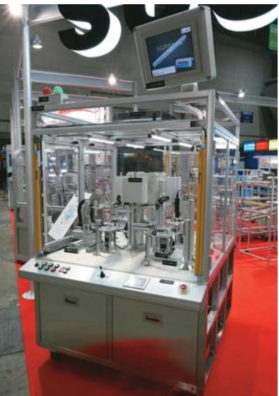
SUSの標準製品を組み合わせたデモンストレーション機。
