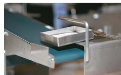
動力なしで実箱を供給コンベアに搭載している
