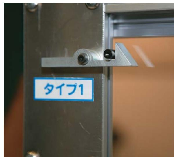
タイプ1は1作目で物の重さのバランスだけでロックしていた為、振動でロックが外れてしまいます。
