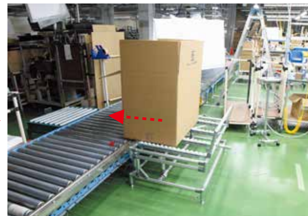
完成した椅子を入れる際は作業側へ傾き、梱包が終わったら手前を持ち上げることで、ダンボールを簡単に奥へ流すことができるシーソー式テーブル。
