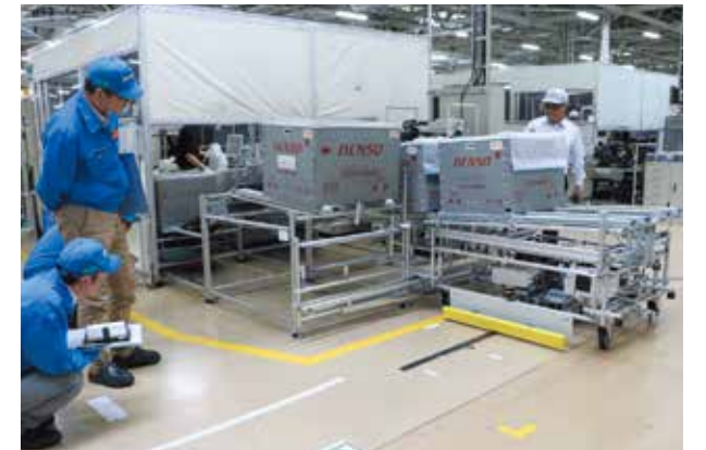
Sing33号でも取材したAGC (Automatic Guided Cart)。からくり機構によりワークを自動で受け渡す仕組みが紹介された。
