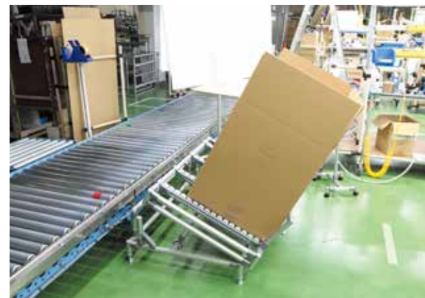
完成した椅子を入れる際は作業側へ傾き、梱包が終わったら手前を持ち上げることで、ダンボールを簡単に奥へ流すことができるシーソー式テーブル。
