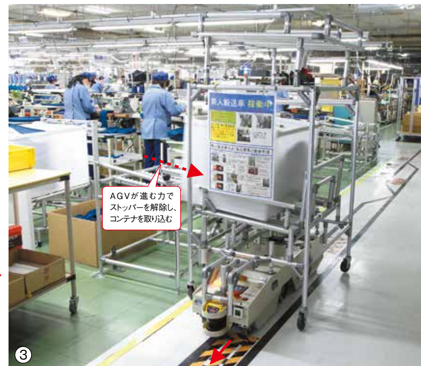
縫製工程の準備が整ったら、スイッチを入れてAGV台車を稼働。台車とシューターの仕掛けが連動し、自動でコンテナの受け渡しを行う。台車は最大で1時間に4回、縫製工程と組立工程を行き来する。
