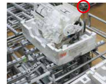
①センサーがテーブル内に流れ込んだ製品を検知。
