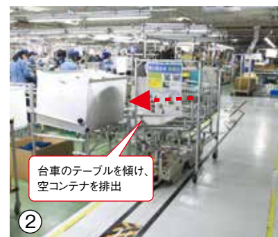
縫製工程の準備が整ったら、スイッチを入れてAGV台車を稼働。台車とシューターの仕掛けが連動し、自動でコンテナの受け渡しを行う。台車は最大で1時間に4回、縫製工程と組立工程を行き来する。
