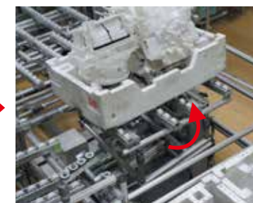
②テーブルを90度旋回し、製品の向きを変える。
