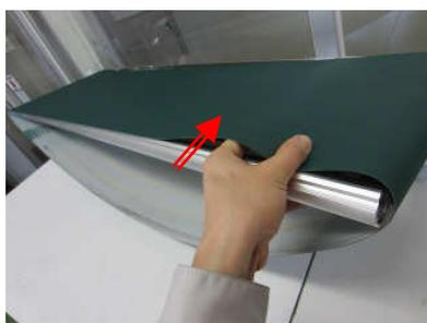
ベルトの表裏を確認し、外した時と逆の手順でベルトを取付けてください。
