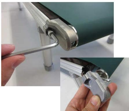
テンション調整ローラを保持しているローラーホルダのうちモータと反対側のローラーホルダを外してください。
