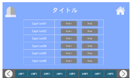
稼働・停止操作画面 (6 個)
