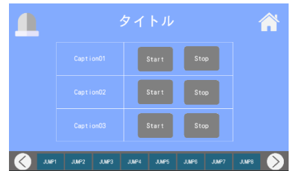
稼働・停止操作画面 (3 個)
