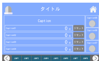
稼働モニタ画面 (カウンタ 4 個, リセットボタン付き)
