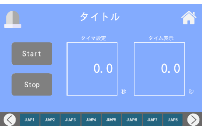
パターン別タイム測定設定画面 シンプルなタイマ設定画面 タクトタイム測定画面
