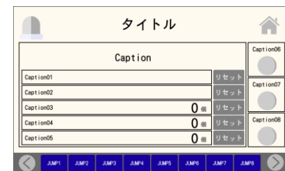
稼働モニタ画面 (バーコード 1 個, 数値表示 1 個, リセットボタン付き)
