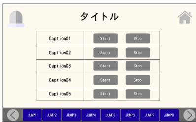
稼働・停止操作画面 (5 個)
