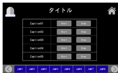
稼働・停止操作画面 (5 個)
