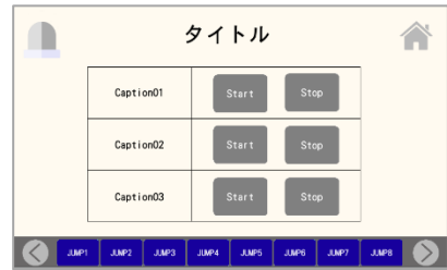
稼働・停止操作画面 (3 個)
