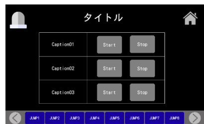
稼働・停止操作画面 (3 個)
