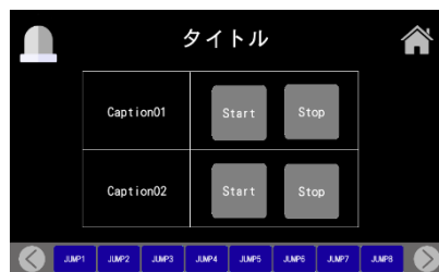
稼働・停止操作画面 (2 個)
