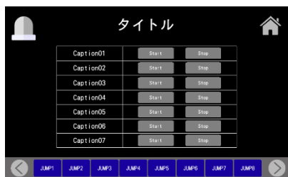
稼働・停止操作画面 (7 個)
