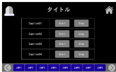
稼働・停止操作画面 (4 個)
