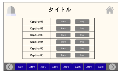
稼働・停止操作画面 (6 個)
