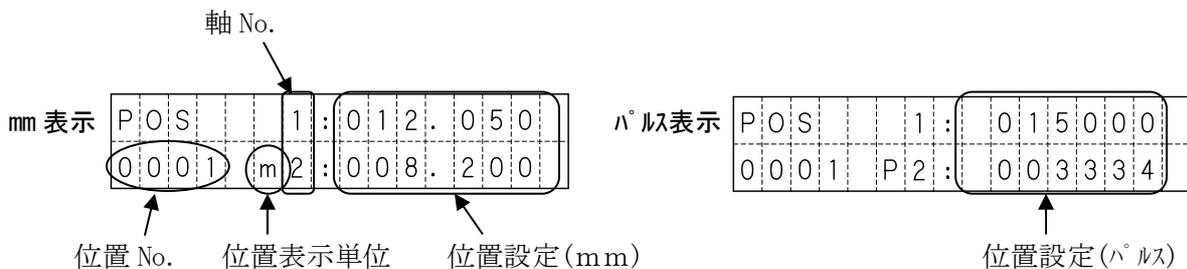
設定値上にカーソルがある際に **ENT** を押すと、1軸→2軸→3軸→4軸→1軸・・・と順にカーソルの位置が移動し、画面も切り替わります。
