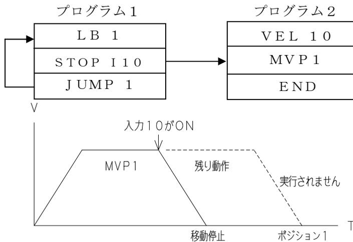
MVP 命令を連続で使用した場合は STOP 命令を実行し移動停止後に次ステップの MVP 命令を実行しますので注意してください。
