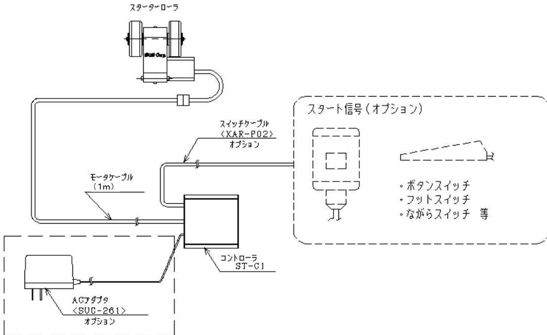
本装置を動作させる信号の配線を接続させます。
