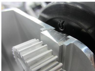
5 : スターターローラカセットとボディの端面を合わせて、六角穴付ボルトM4 x 8で固定します。
