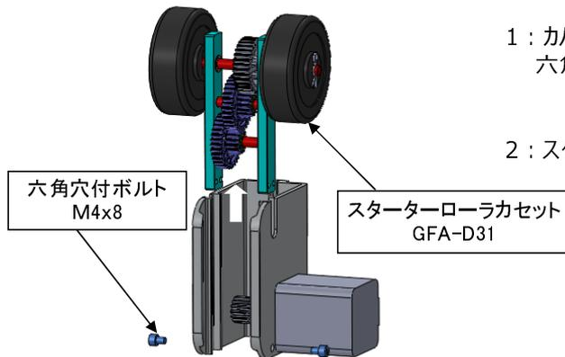
1 : カバーを取り外し、スターターローラカセットを止めている六角穴付ボルトM4 x 8を外してください。
