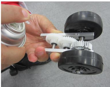
3 : 交換するスターターローラカセットのギアに潤滑油を満遍なく塗布してください。(ローラを回しながら。)
