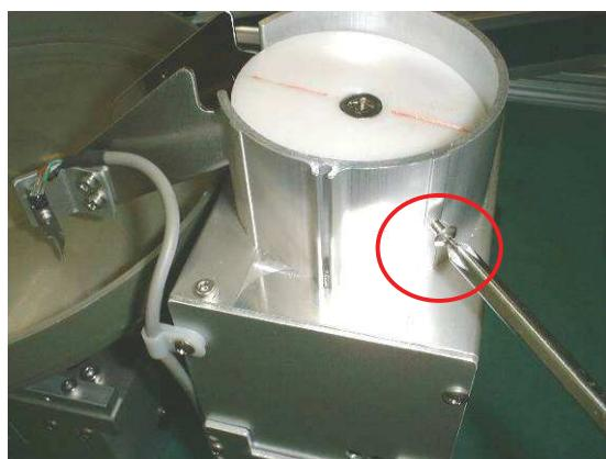
⑥パイプをパイプホルダに差し込み、手順⑤で取り外したトラスネジで固定します。
