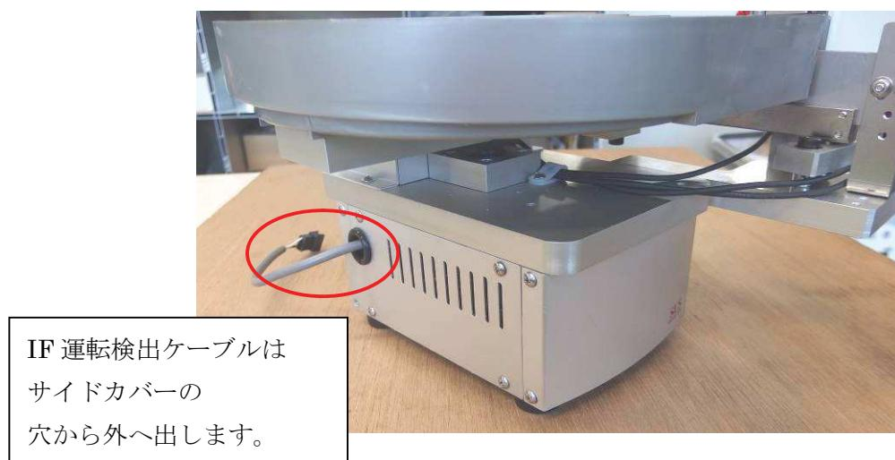
④ IF 運転検出ケーブルの黒いコネクタを本機下側から出ているコネクタに接続します。
