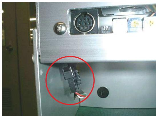
⑥ パイプホルダに付いているトラスネジを取り外します。
