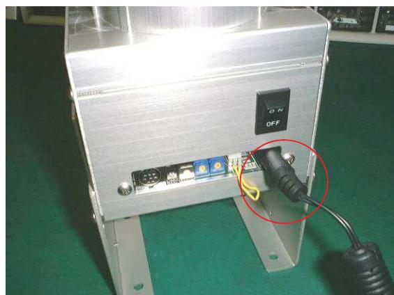
③ワークをパイプに投入し、裏面の電源スイッチと IF の電源を ON にしてください。
