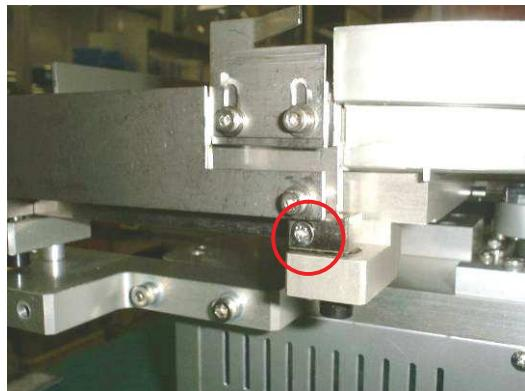
②運転検出センサ ASSY の六角ナットを取り外します。
