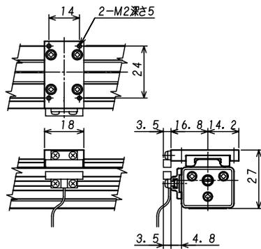
(注) センサユニットを装着した場合、スライダ高さ和工作取り付け穴が変わります。
