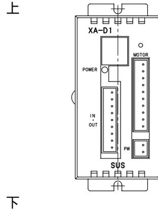
取り付けは鉄板、アルミ板等の熱伝導の良い物にしっかりとネジ止めしてください。
