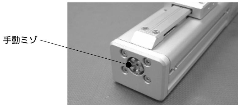
Hタイプのスライダを外力で動かすときは、ストロークエンドにぶつけないように注意して下さい。激しくぶつけるとボールネジの内部が破損する恐れがあります。
