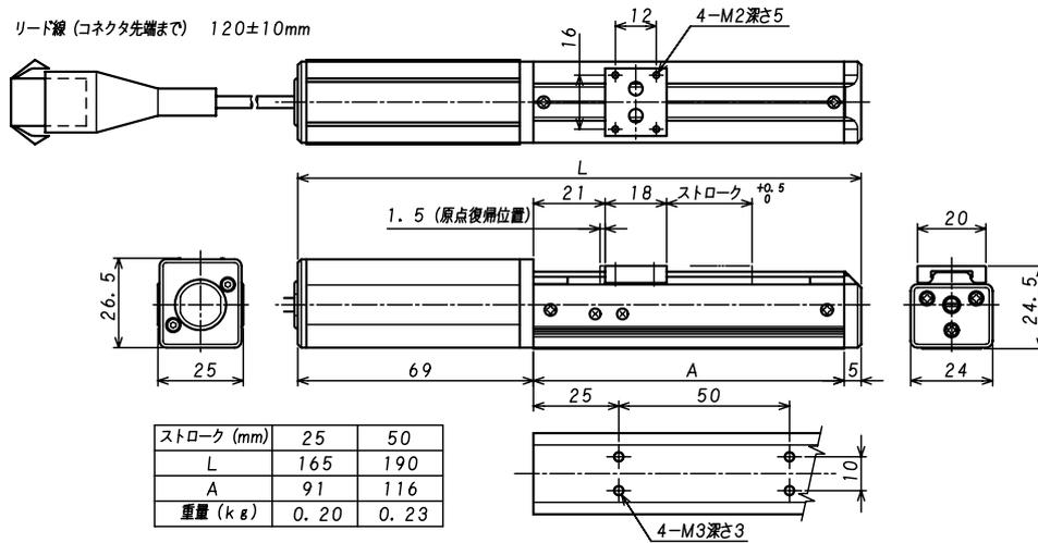
センサユニット (左右いずれが片側に取り付けできます)
