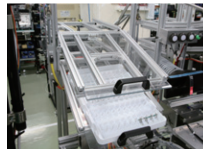
部品棚スライド機構(作業性を考慮して部品棚がスライドする)。
