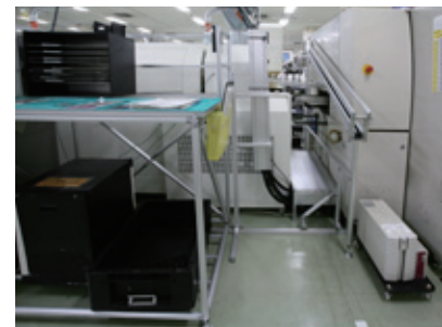
簡易作業台と伝票スライダ。作業伝票が傾斜を滑り落ちてくる。人が行き来できないスペースも見事に有効活用している。
