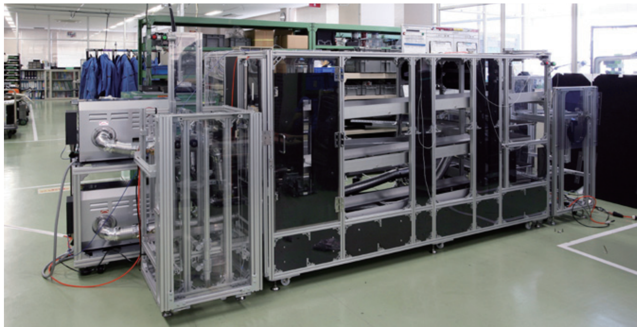
ヒート槽(製品ユニットを一定時間、高温で放置するための設備)
