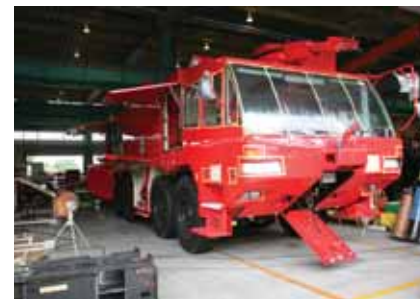
全長約12m×全幅約3m×全高約3.8m、総重量は約43tの空港用化学車。
