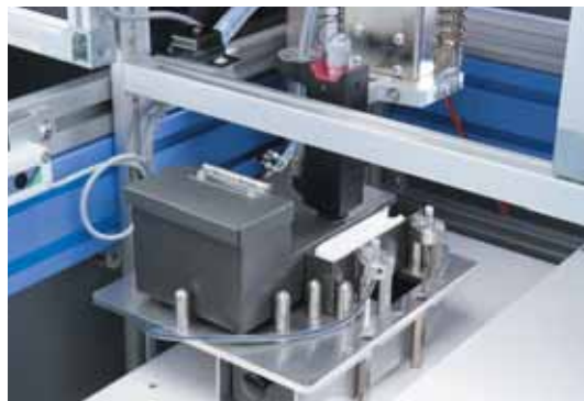
ノズル乾燥防止機能および吐出確認機能を搭載。 (マイクロドットディスペンサ)
