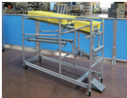
剛性をさらに高めたGFの新フレームで構成された「空箱折り返しシューター」。ペダルを踏むと空箱が返却できる。
