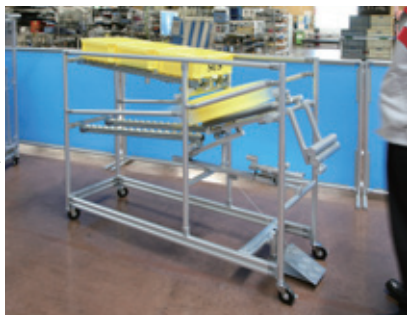
剛性をさらに高めたGFの新フレームで構成された「空箱折り返しシューター」。ペダルを踏むと空箱が返却できる。
