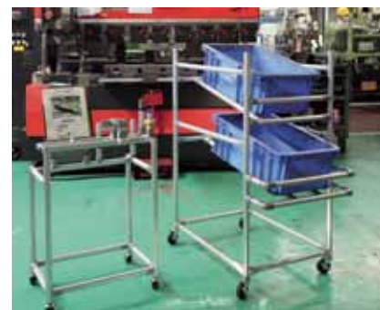
強度を保ちつつ締結部品を最小限に工夫したシューターや作業台。
