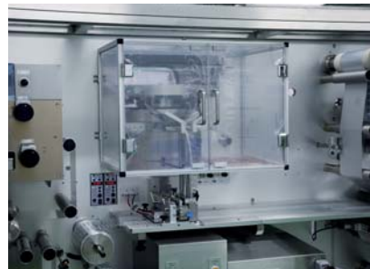
機械内部のカバー部分にもアルミを採用。
