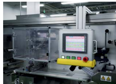
SUSのタッチパネルボックスとアームが採用されている。
