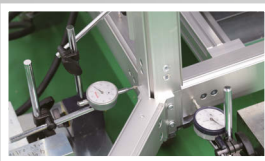
繰返し動作による台車位置ずれを計測
