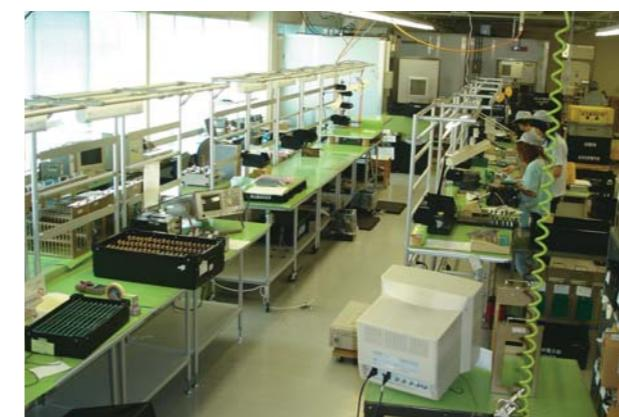
目の高さにコンピューターを取付けることで作業者の負担を軽くしています。
