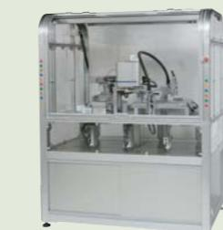
SUS(株)のカタログ製品を使用したマシン。装置カバーを始め移動・搬送・バーツフィーダ等全てカタログで構成。
