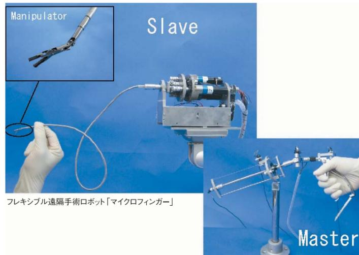
フレキシブル遠隔手術ロボット「マイクロフィンガー」
