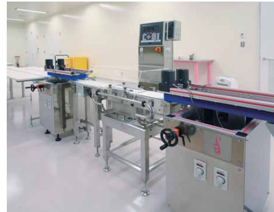
赤いスロットキャップの見える部分がサイドコンベア。
