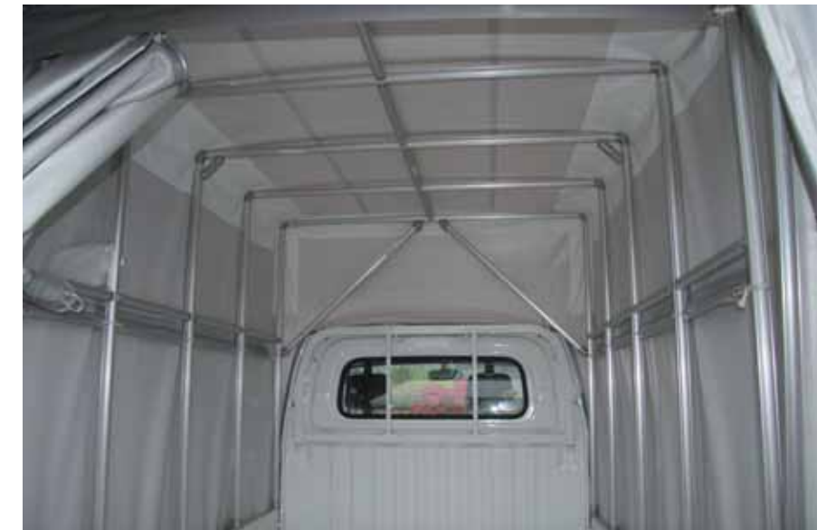
大石社長自らが製作したGFを使ったトラック荷台の幌。
