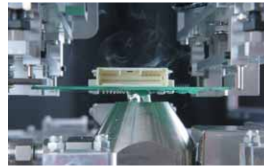
ビールバック効果によりはんだブリッジの発生を抑える。(フレックスポイント溶ダ)
