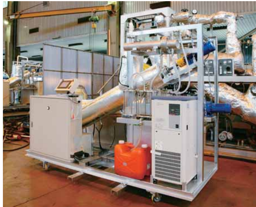
連続式油化装置プレスターminimo 処理能力は2kg/時間。サイズは幅2,400×奥行1,350×高さ2,000mmと比較的小型で移動も可能。イベントなどのデモンストレーションにも活用している。操作するタッチパネルボックスはSUS製品(T-BOX)。
