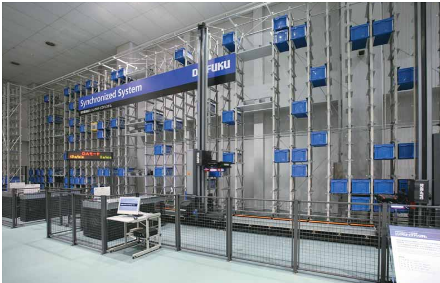
世界最高能力ケース自動倉庫「シンクロナイズドシステム」。秒速で動く倉庫は圧巻。
