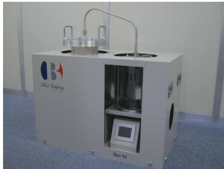
教材・デモ用小型油化装置「Be-H」プラスチックを入れてから1時間ほどで石油が出始める。家庭用100V電源で使用が可能。
