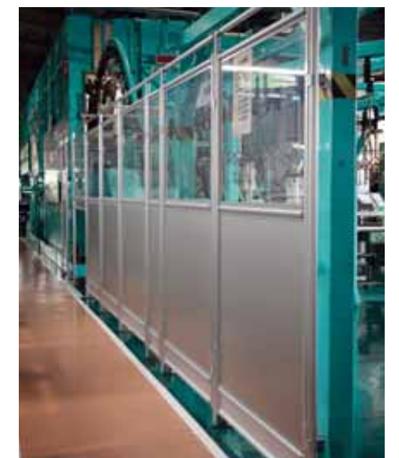
GFを利用したパーティション。
