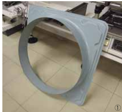
工場用換気扇の外枠。プレス加工1回のストロークで平板から穴明け、パーリング、多段絞り、外周トリムを行う。
