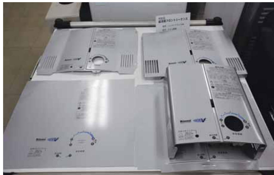
湯沸かし器のフロントケーシング。塗装、印刷した材料を用いて加工。
