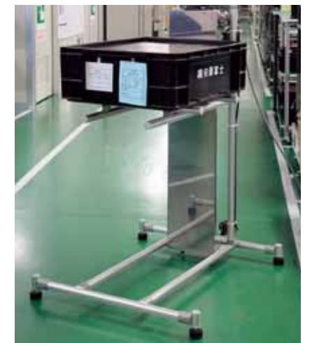
GFを用いた昇降機。重い荷物を作業台まで持ち上げるために作成されました。
