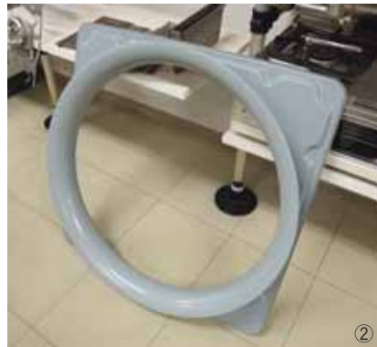
1台の機械で、プレスと回転を行うことで、テーバー成形、端面のカール加工が可能となる。
