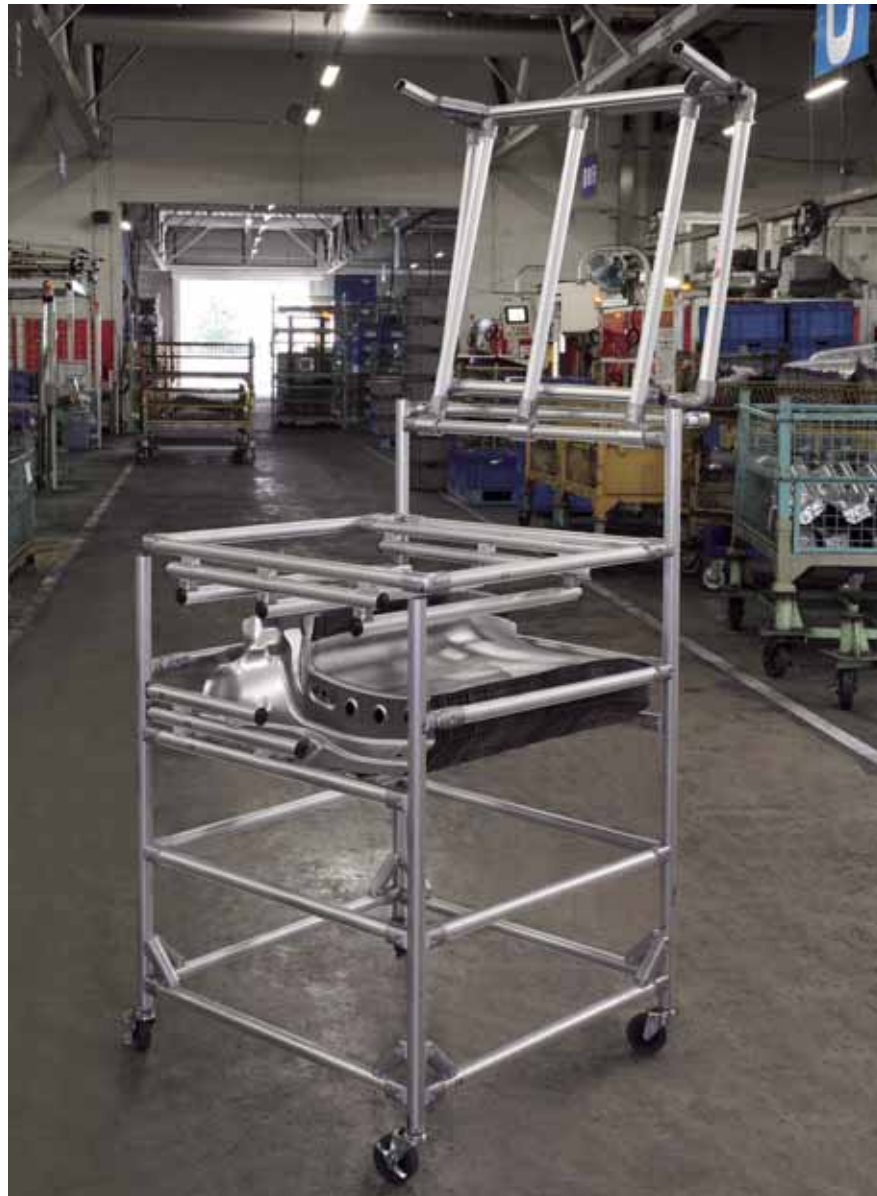
溶接した部品を置いて次工程に効率よく渡す部品台。3段で重ねて置ける省スペースの仕組みになっており、その機構は仲屋さんが設計・製作されました。
