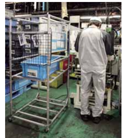
製品の品質確認に用いる作業ラック。使い勝手を考えて、常に組み替え・改造を行っています。
