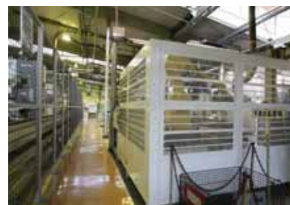
右は鉄製の安全柵。全体が覆われているため重く感じられる。
