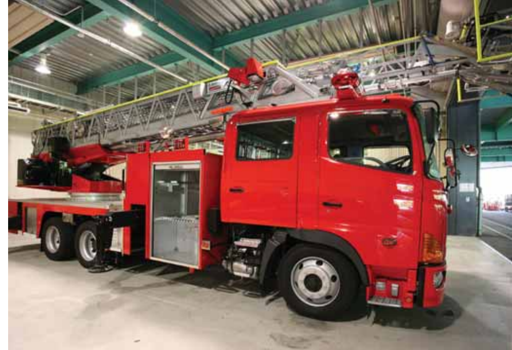
納車を待つはしご車。車輛中心部のロッカーの筐体にアルミフレームが使用されている。
