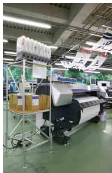
高速高画質昇華転写インクジェットプリンタのオプション架台としてGFが採用されている。
