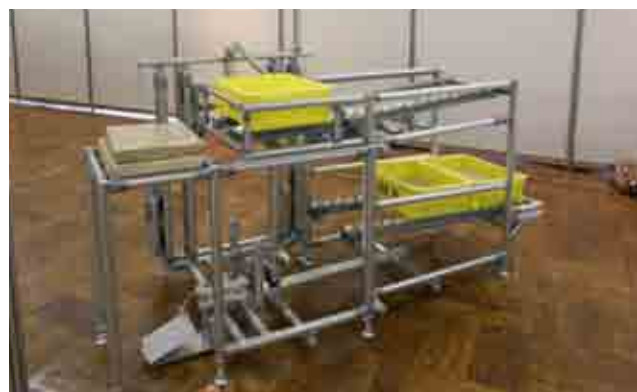
エレベーター 上にあるコンテナが、作業後ペダルを踏むことで、下のシューターに排出されます。
