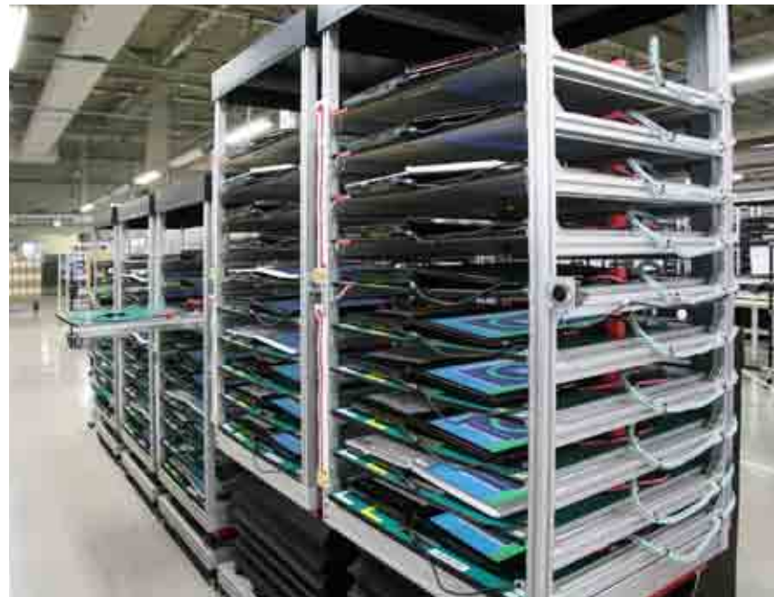
出荷前のランニング試験を行う工程。この筐体にアルミ構造材SFが使用されている。
