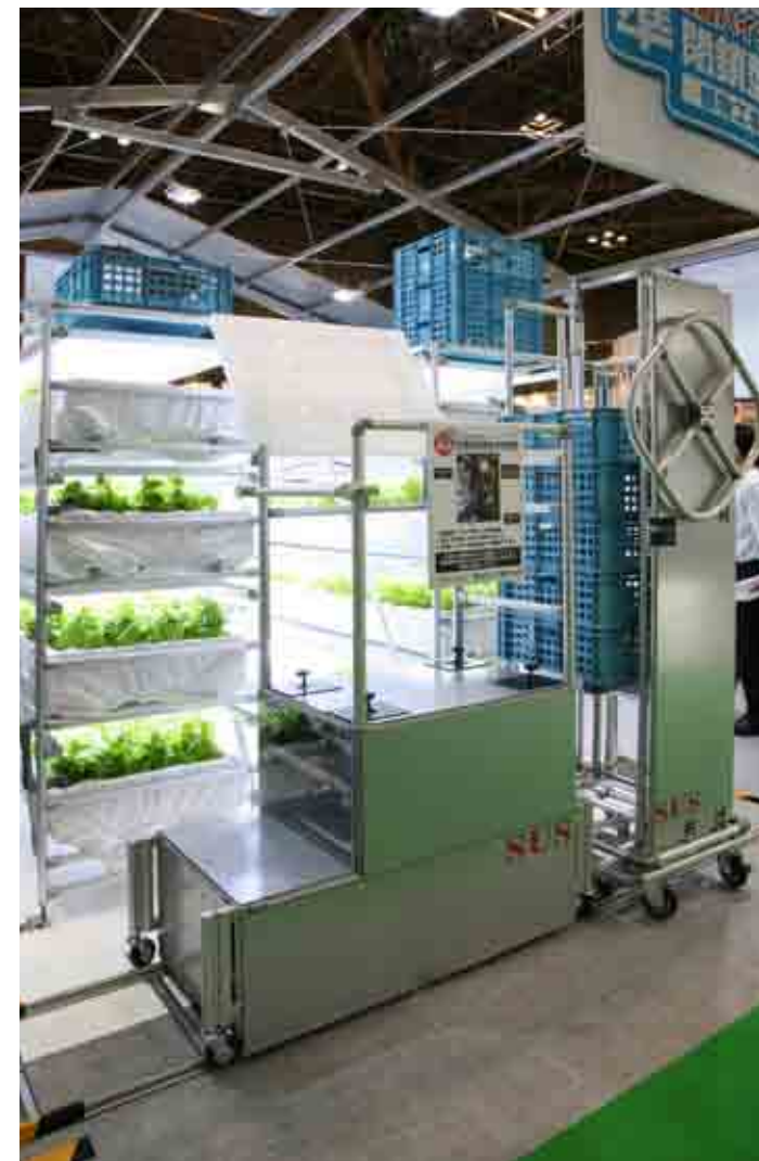
渡辺パイプと共同出展した「無電源足踏み式作業台車」。ペダルを踏んで前進後退させる。
