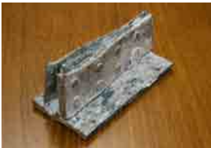
海水から引き上げた零戦の機体の一部（主翼桁）。押出形材と板がリベット留めされている。
