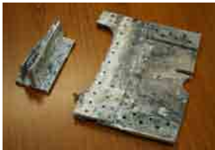
海水から引き上げた零戦の機体の一部（主翼桁）。押出形材と板がリベット留めされている。
