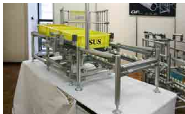
切り出しユニット 前後のストッパーを順次作動させることによりコンテナを1つずつ切り出します。
