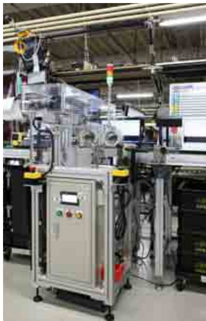
パソコンのラベル貼付けを行う装置の架台(アルミ構造材SF)。
