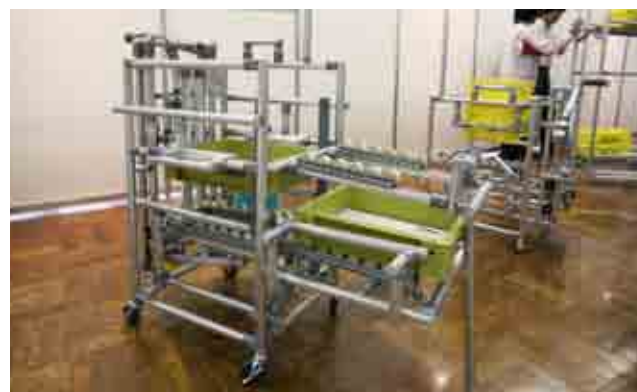
コンテナ積み上げユニット レバー操作で流れてきたコンテナを積み上げます。
