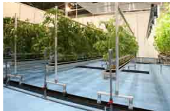
千葉大学の「可動式栽培棚」。トマトの成長に合わせて棚を移動させることができる。
