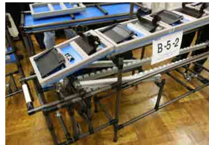
パレット本体に工夫を施し、サイドにガイドをつけなくても落ちないように設計されている。
