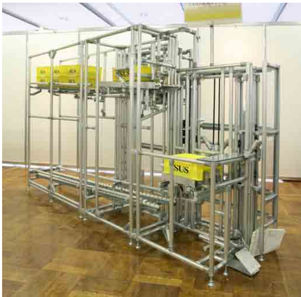
ECOシャトル 段積みされたコンテナを1つずつ切り分け、作業後に再度段積みして返します。
