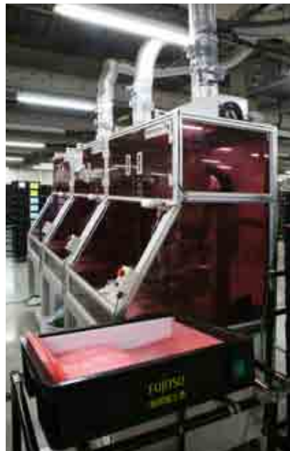
はんだ付けロボットのカバーとしての利用。
