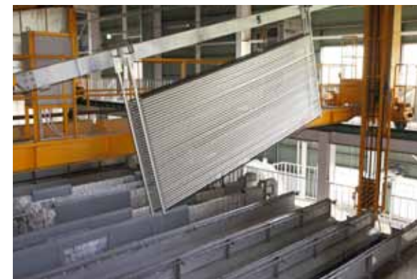
横吊り全自動搬送ラインのアルマイト処理は全8工程で、一連の流れに要する時間は約2時間30分。9μ(ミクロン)の皮膜でマットな仕上がりに。
