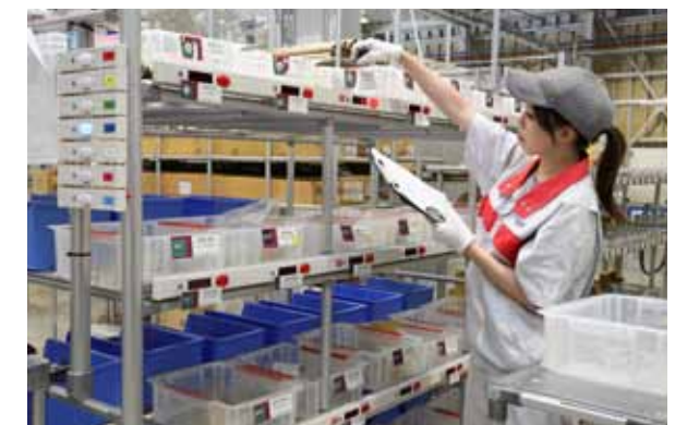
SUSの製造拠点の中でいち早くDPS(デジタルピッキングシステム)を取り入れた滋賀事業所。正確かつ迅速なピッキング作業が日々行われている。
