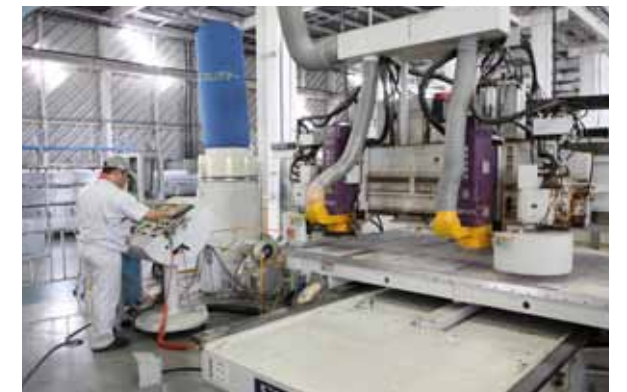
パネル加工作業。樹脂・板金・木製ボード・ビニールシート・アルミハニカム他、ブラダン・鉄・ステンレス金網など、アイテムも豊富に揃っている。
