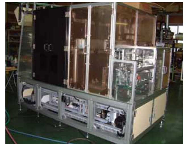
2008年に手掛けたLED照明の溶接機。 筐体としてアルミフレームが使用されている。
