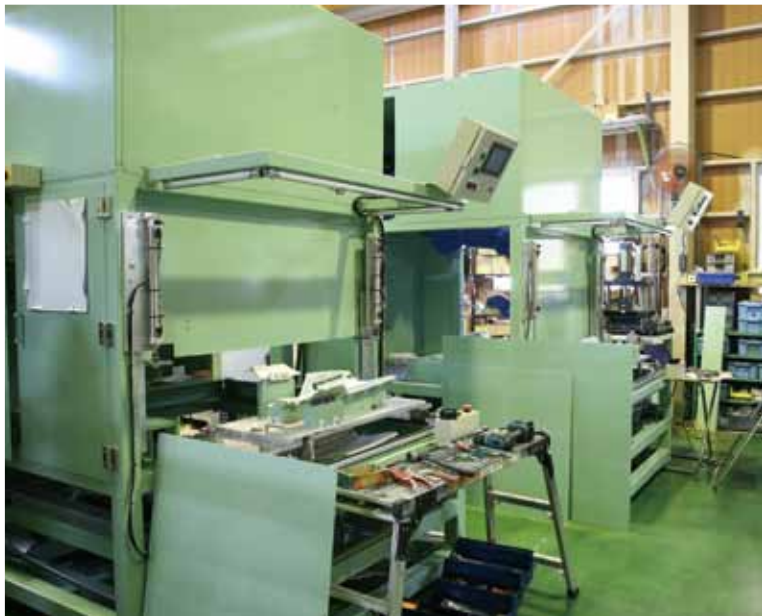
取材時、自動車の製造に用いられる接着剤の自動塗布機製作が、大詰めを迎えていた。
