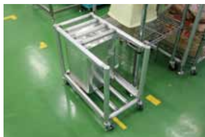
工場内で大量に使用される食用ラードが入った一斗缶もキャスターをつけてスムーズに移動。
