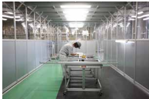
クリーンルーム内で精度の高い組立物件に対応。工場内にアルミフレームを用いたパーティションを設置し、組立専用スペースを確保している。
