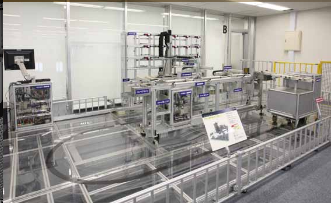
SUSで扱うアクチュエータや制御ボックス、アルミフレームなどで構成した「Small Factory」。SUSが提案する自動化・省力化をカタチにしたデモンストレーションとして人気が高い。
