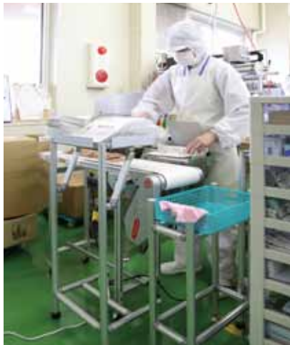
作業動線を邪魔しないコンパクトな作業台。自然な姿勢で梱包作業ができ、効率がアップしたと大好評。
