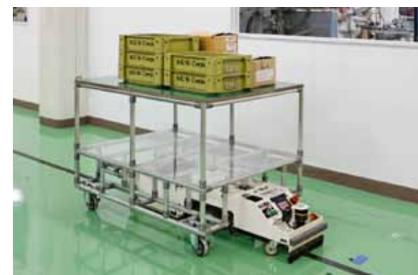
工場内にはAGV(自動搬送車)を設置。物流の自動化を実現したことで、生産効率をさらに高めていく。
