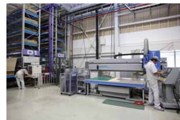
パネル専用の自動倉庫には、パネル用切断機を配置。製品の移動距離をできるだけ短くするために、動線も工夫されている。
