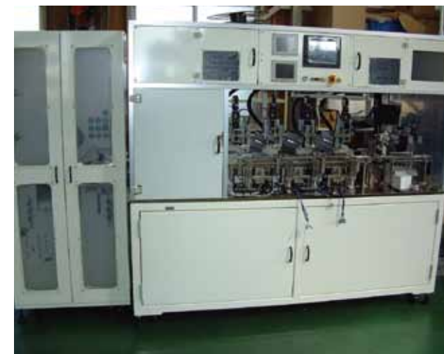
液晶パネル内のチップ保護に用いるポッティング装置。 サイズなどの仕様違いも含め10数台が出荷されるヒット商品となった。
