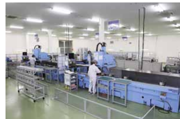
フレームの穴あけ工程。ご要望に合わせて、加工を施していく。
