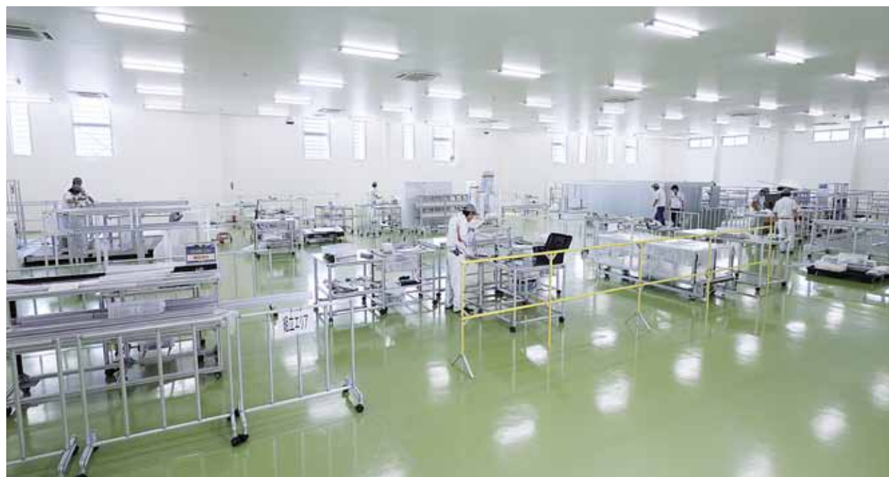
外部からの埃の侵入をブロックしたクリーン仕様の組立エリア。出入口のエアシャワーはもちろん、粘着マットやエアカーテンを完備し、埃の発生を排除する。また品質を徹底管理するために「クオリティーゲート」が3カ所に設けられ、厳しい出荷前検査が行われている。
