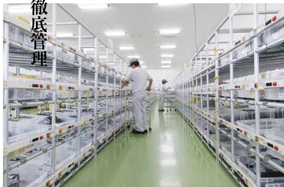
DPS（デジタルピッキングシステム）の導入で、正確なピッキング作業が効率よく行われている。
