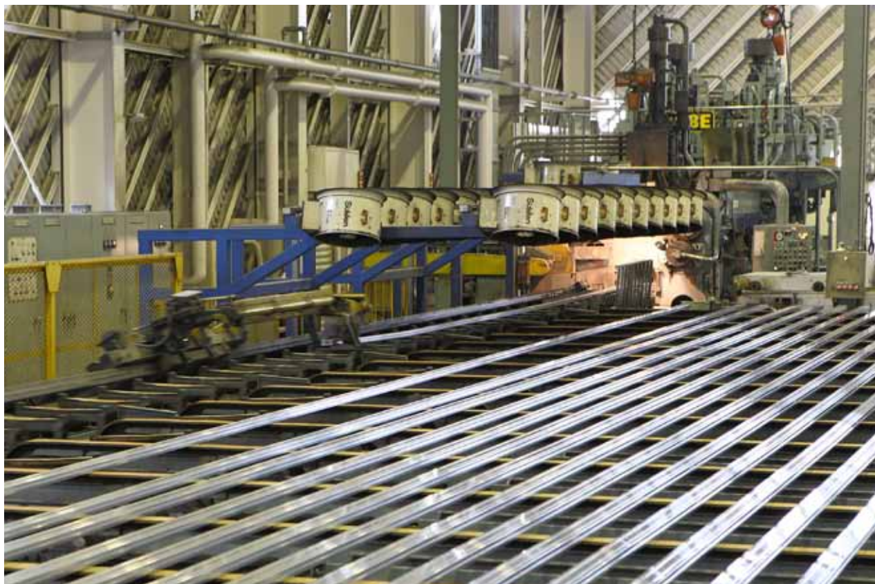
押出機から出てきたフレームはブローで冷却テーブルに並べられ、さらにストレッチャーで歪みを矯正して精度を高める。1本のピレットから押し出されるフレームの長さは最長37m。これを定尺(4m)にカットし、次工程のアルマイト処理へと進む。
