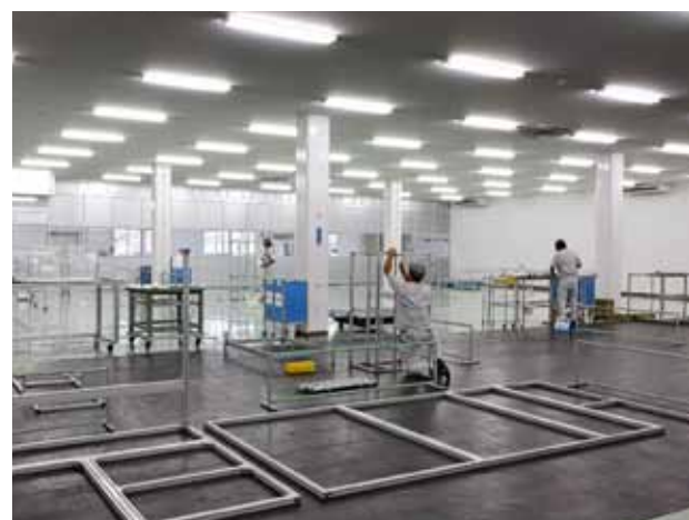
フレームの組立エリア。クリーン度を高めた専用スペースを完備したことで、より高精度が求められる物件にも正確に対応できる。
