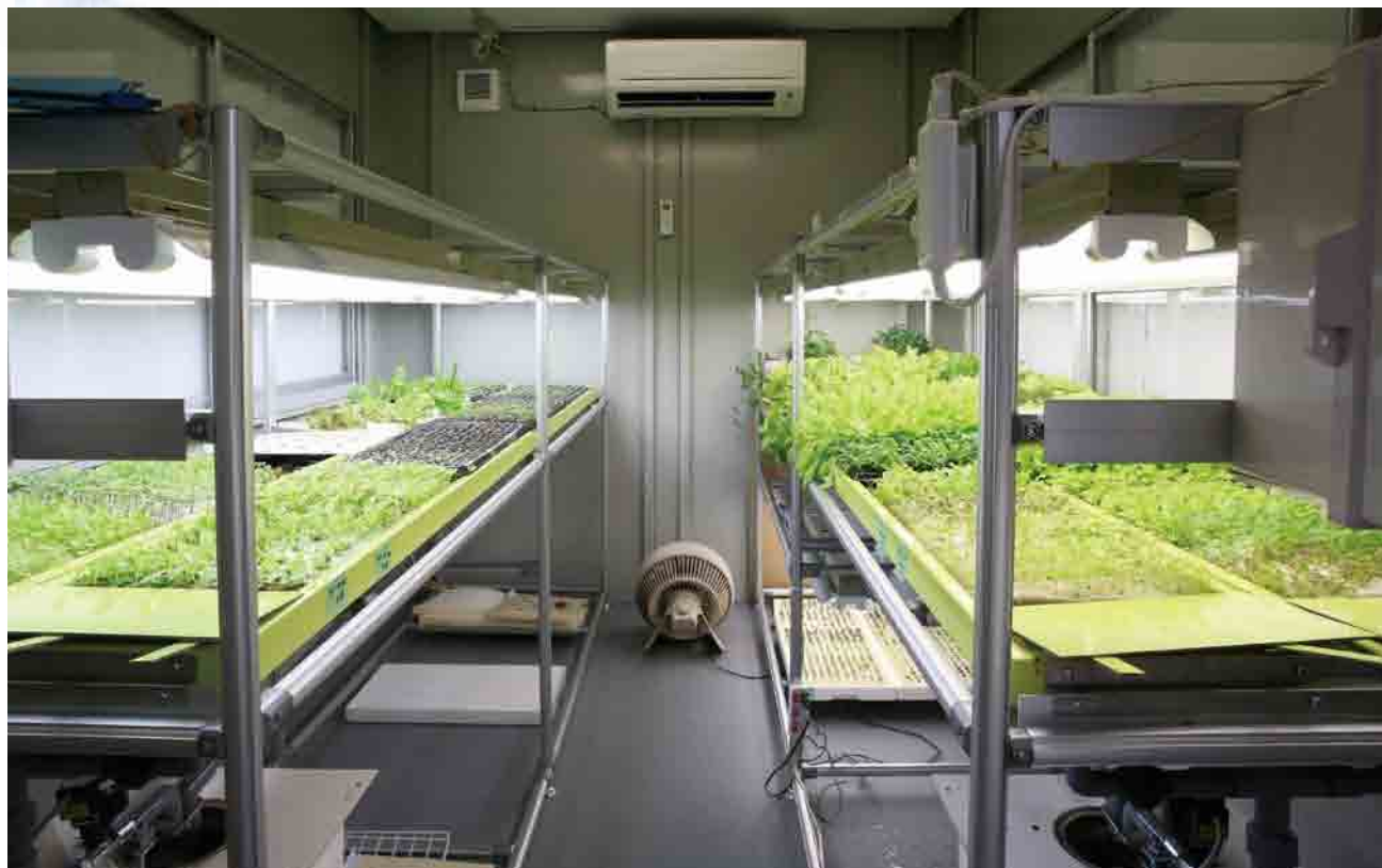
「ホトベジプラス」という有機水耕栽培を行うプランターには、アルミパイプ構造材GFが用いられている。軽量で組み立てやすく、水に強いと高評価。
