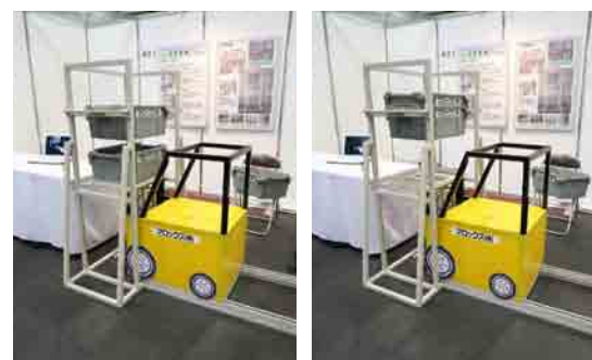
大容量の空箱を下から押し上げて楽に重ねることを実現させたからくり
