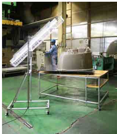
大型プラスチックの特殊成形品を載せた作業台車。照明スタンドにもアルミパイプ構造材GFを使用。
