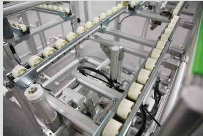
コロコンによる搬送はそのままに90度ターンを電動化。コンテナの重さによる微妙な調整が不要に。
