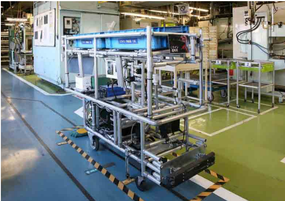
からくり機構を搭載したAGV台車もGFで作成。作業の効率アップに貢献している。
