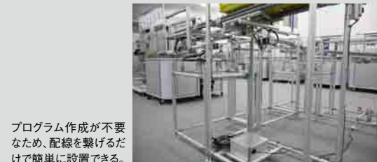
向かって右(緑)がハイブリッド型、左(青)が従来型。電動とからくりの動きの違いを確認できる。
