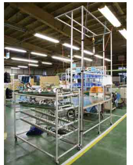
大型建機用成形品の組付工程で使用する作業台。部品の大きさや機能にあわせて設計・製作されている。
