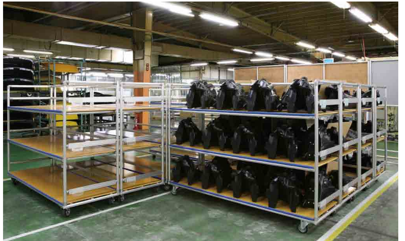
モトクロス用ガソリンタンク成形品専用の運搬および在庫用台車。組付工程で使用する時に、この棚ごと移動させる。
