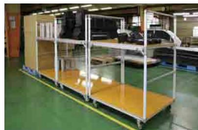
大型建機用成形品専用の運搬及び在庫用台車。こちらも組付工程で使用する時に移動させる。
