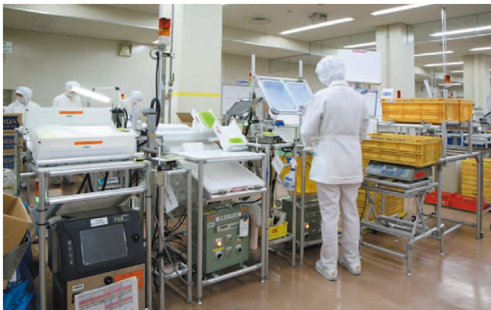
粉末仕上げ工程で製品をケースや外箱に入れる作業工程。資生堂保有の設備とGF作業台が上手く融合されている。
