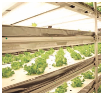
蛍光灯の取り付けには独自設計のチャンネル材を使用。
