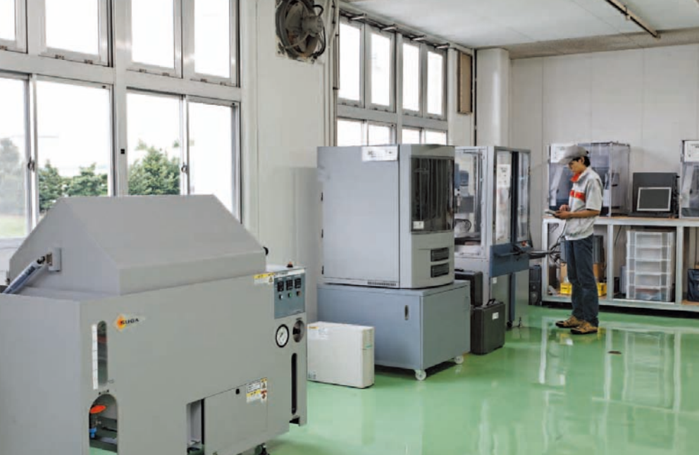
SUS静岡事業所では塩水噴霧試験機を備えており、締結部品の耐食性に関する研究も進めている。
