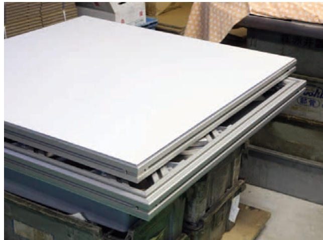
2012年2月に完成した最新機種MT-III型。天板の構造材には40角の高剛性アルミフレームを採用。
