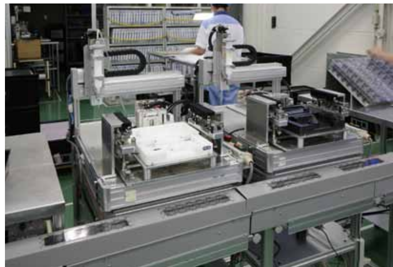
意匠部品にグリスを塗布するための自動機。2種類のモデルを交互に流す生産形態のため、それぞれの製品を自動判別して異なる作業を行う。これらもXAコントローラを上位として、I/Oでの通信で全てを行っている。
