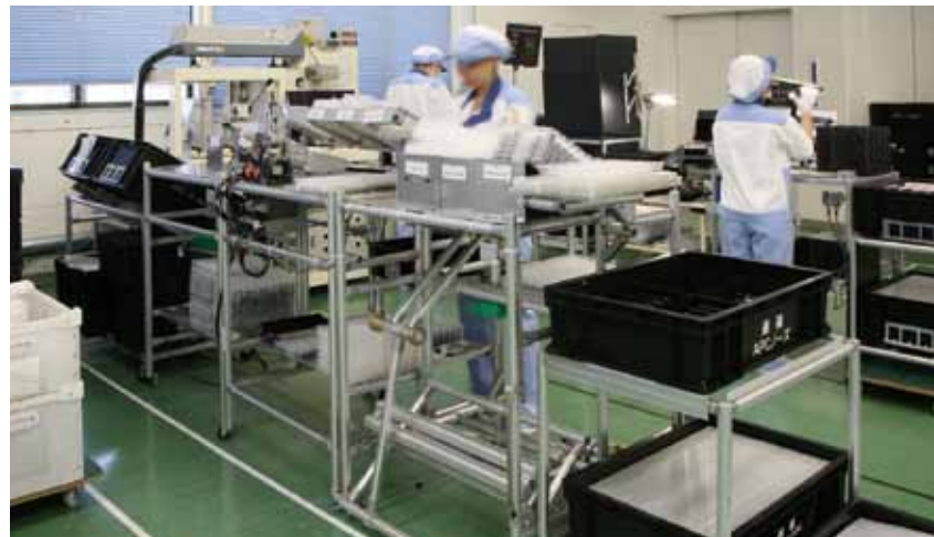
カーオーディオ外観品の組立ラインで、治具ごと次工程へ手送りし、空になった治具を斜面と足踏み式リフトで回収するからくりライン。
