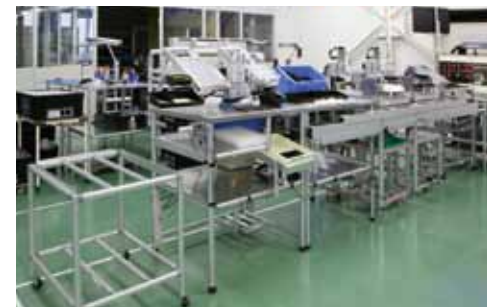
グリス塗布機を導入している組立ラインの一部。GFフレームとの組み合わせにより構成され、混流生産の形態をとっている。
