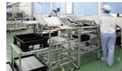
治具ごと左→右へ手送りし、作業台下側斜面によって治具を回収する。
