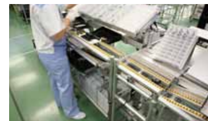
治具を手送りさせるのに作業台側にコロコンを設置、こうすることで治具側にローラーを付けるより作業台間の位置決め精度が不要となる。
