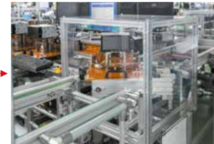
コーナー部で90度ターンし、次の検査工程へ自動搬送される。
