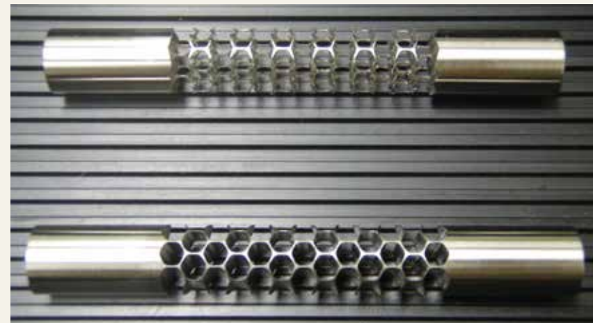
株式会社森精機主催のコンテストで金賞を受賞したφ12インコネル600バー材の切削加工。まず1方向から加工を行い(写真下)、90度回転させて加工(写真上)。残した肉厚はなんと0.2mm。
