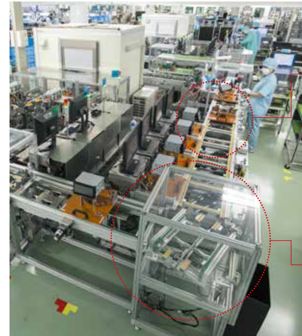
カーナビの検査工程 製品搬送はコロコンを利用してパレットで 行われている。（パレットはモーター駆動による自動搬送）
