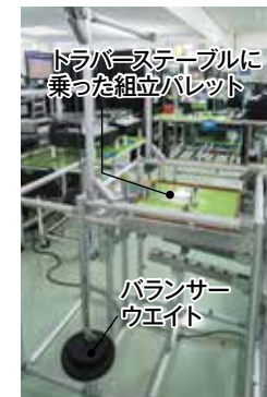
からくりトラバース（動力を使わないパレットリターントラバース） 組立パレットがトラバースに入ると、その重さによりテーブルが下降し、返送レール部でテーブルが傾き組立パレットが返送レール側に流れ出る。パレットが排出されると、balancerウエイト（錘）によりテーブルが元の位置に戻る。
