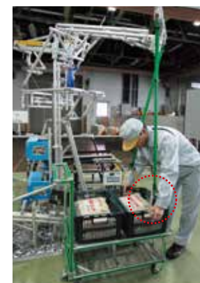
リングを親指と人差し指の間に挟むだけで取っ手をワークに簡単装着できる。
