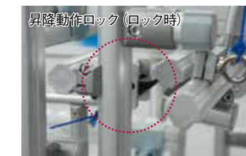
フレームの突起部分が昇降動作ロックの爪に引っかかり、折り返しテーブルは停止状態を保つ。
