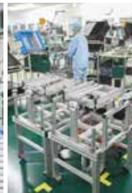
組立て治具と工程間の搬送を兼用する複合治具。
