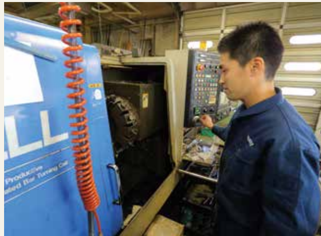
マシンニングセンタで喧嘩ゴマを加工した八木さん。タングステンは重い素材の振れを抑えるために、切削抵抗を極力小さくして削っていった。
