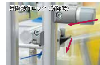
コンテナがテーブルに流れきるとパワーユニットのスイッチが入りロックを解除。テーブルが傾斜しコンテナが流れる。
