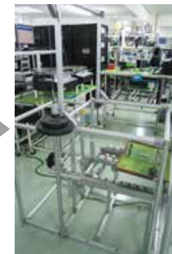
からくりトラバース（動力を使わないパレットリターントラバース） 組立パレットがトラバースに入ると、その重さによりテーブルが下降し、返送レール部でテーブルが傾き組立パレットが返送レール側に流れ出る。パレットが排出されると、balancerウエイト（錘）によりテーブルが元の位置に戻る。
