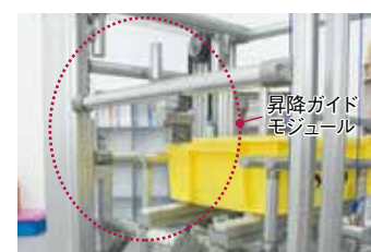
ロッドが動き（後退）、昇降ガイドの滑車機構を介してテーブルの上昇をアシスト。
