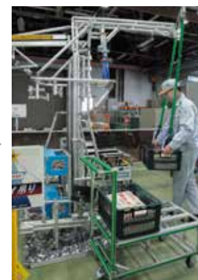
5kgの力で持ち上げ、移動。おもりはセンター上下方式を用いているため、アーム慣性による振れを防止している。
