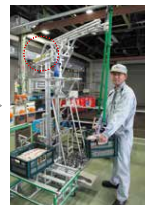
アシスト可変機能が働き、20kgのワークに対し、15kg分の重さを「SKY吊り」が負担。
