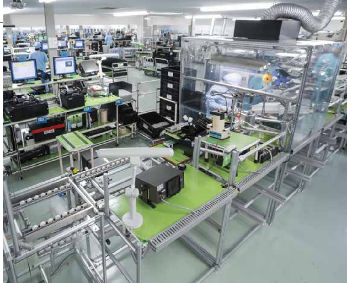
カーナビのディスプレイ部 組立工程 作業はパレット上 で行われ、搬送はコロコンを 利用。使い終わったパレットは 重力を利用して戻される。
