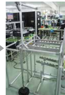
からくりトラバース（動力を使わないパレットリターントラバース） 組立パレットがトラバースに入ると、その重さによりテーブルが下降し、返送レール部でテーブルが傾き組立パレットが返送レール側に流れ出る。パレットが排出されると、balancerウエイト（錘）によりテーブルが元の位置に戻る。
