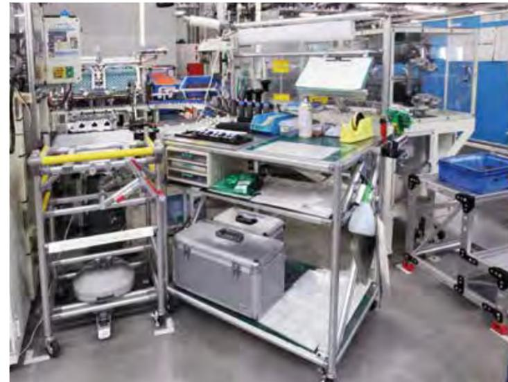
工場内の検査工程で使用されている作業台もGFで作成。キャスター付きなので移動もできる。
