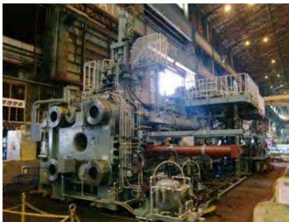
福島事業所に設置される4,000t直接単動式アルミ押出機(製造元での撮影)。手前側、中央の穴から押し出形材が出てくる。
