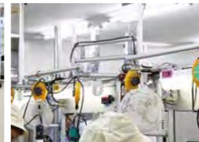
組立ラインはGFで構築。リングを用いて工具を左右に動かせる仕組みになっている。
