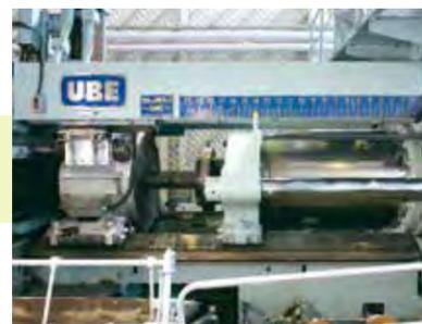
ビレットを押出機に挿入。SUSで使用している横型油圧式押出機は、直接押出法(固定した金型に加熱したビレットを押し付けて押し出す方法)で、最大2,350tの圧力を掛けることで、最長37mのアルミフレームを押し出しています。
