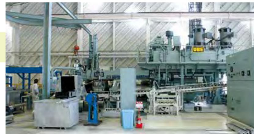
SUS福島事業所で保有するプレス能力2,350tの押出機の全景。
