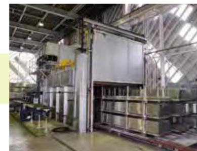
アルミフレームに強度や硬さを与えるために熱処理(T5処理/人工時効硬化処理)を行います。アルミパイプ構造材GFの場合は、200℃前後で2時間程度加熱しています。
