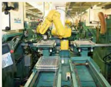
2次加工エリアのNC切削機。ワークの供給、排出もすべて自動化しパーツフォーマー同様24時間運転している。
