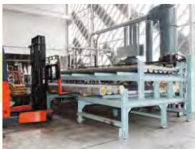
長尺ビレットは歩留まりを考慮し、専用カッターで必要な長さに切断します。例えばアルミパイプ構造材GFなら約600mm、太陽光発電パネル用アルミ架台(P25~P28)なら500~600mmの間で、ミリ単位で正確にカットされます。
