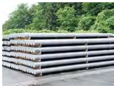
ボーキサイトを加工し、抽出されたアルミナを電気分解することで作りだされるアルミ。押出材にはビレットと呼ばれる円柱形の鋳塊を用います。カットする前のビレットの長さは5,800mm。1本の重さは、なんと500kgもあります。
