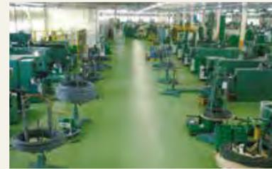
マザー工場となる和知工場の冷間鍛造エリア。4段から8段の高精度パーツフォーマーが導入されており、24時間運転している。
