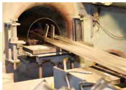
押し出されたアルミフレーム。アルミパイプ構造材GFの場合、1度に4本を押し出すよう金型を設計し、生産性を高めています。金型から出てきた直後は500℃以上のアルミフレームも、クーリングテーブルに載せられた時点で約230℃にまで下がっています。テーブルの下にはいくつものファンが回っており、移動する間に急速に低下した温度は、切断されるころには室内温度と同等の30℃前後に。この間、わずか20分足らず。アルミの特性の1つである「放熱性の高さ」が顕著に表れています。
