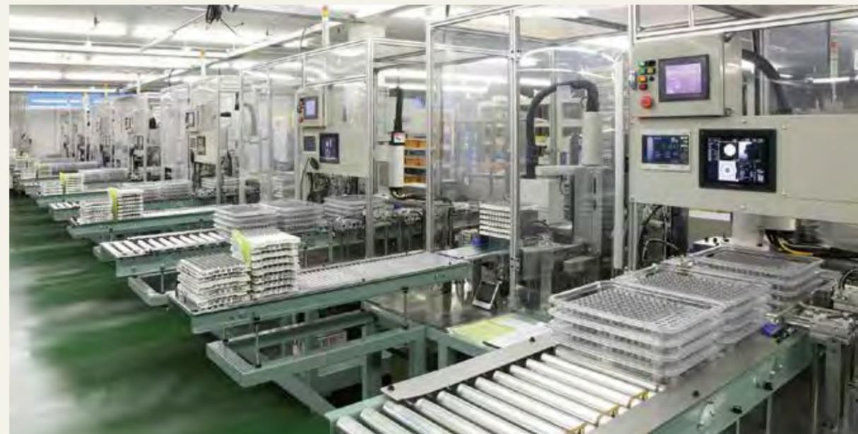
微小な表面のキズや寸法公差を検査するレーザー、リーク、カメラの技術を活用した自動検査機。製品が並ぶ樹脂製のトレイは100℃にも耐える特注品で、熱や油などの加工環境に対応する。
