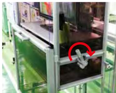
このレバーを押すと自動でテレビ枠が降下。(テレビ枠の方が重りより重く設定してある)
