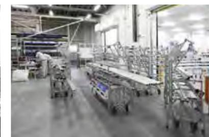
アルミパイプ構造材GFで製作した跳ね上げ台車。前段取りとして資材を計画的に備えています。
