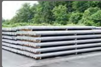
アルミ地金は、純度や成分によって普通純度地金、高純度地金、合金地金に分類されます。また、形状や用途からはインゴット(一般原材料用鋳塊)、スラブ(圧延用に調整された鋳塊)、ピレット(押出用に調整された鋳塊)などに区別できます。
