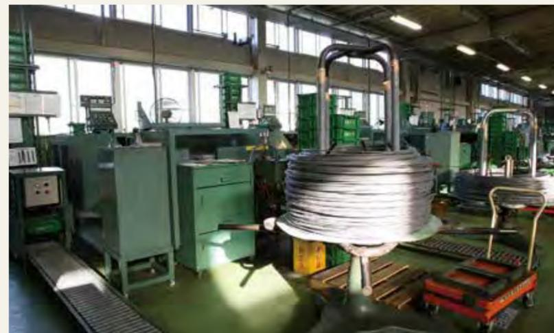
コイル材と呼ばれる金属素材が効率よくパーツフォーマーに供給される。素材はすべて国内メーカーから調達し、源流から品質を確保している。
