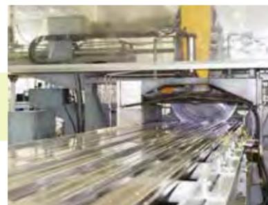
室内温度まで冷却されたアルミフレームを、それぞれの製品に定められた長さに切断します。ストレッチャーでけん引した端部など使用しない部分はカットし、再生ビレットとしてリサイクルされるので無駄がありません。
