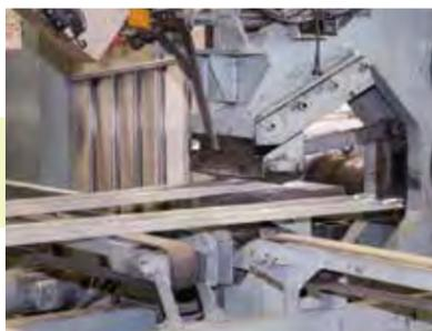
テーブルの上を移動する間に冷却されたアルミフレームを、ストレッチャーと呼ばれる機械で挟み、けん引することで、わずかに生じたねじれやゆがみをきっちりと矯正します。
