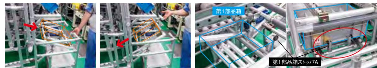
折り返しターンテーブルが下がった状態。作業が終わったら、空箱返却レバーを引きここに部品箱が流れてくる。 第1部品箱 ストッパAで箱を支えている。作業が終わったら、空箱返却レバーを引き上げ、箱を下段へ送る。
