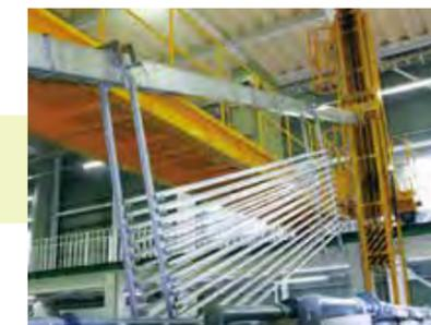
陽極酸化皮膜処理といい、電解液に浸して人工的に厚く強固な皮膜をつくる工程です。表面を保護し耐食性を高める効果もあり、硬度も素地より高くなります。この後、指定寸法の切断や穴あけ加工などの工程を経て完成品として出荷されます。
