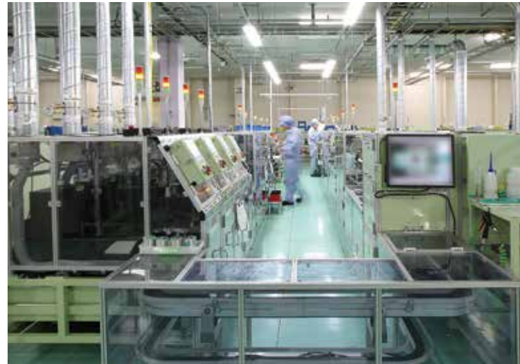
設備全高が1,350mmのライン。背の低い女性でもライン全体を見渡すことができる。
