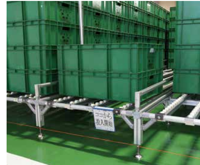
シュートの床上高さも150mm以上。床では掃除用ロボットが稼働しており、すみずみまで掃除が行き届いている。
