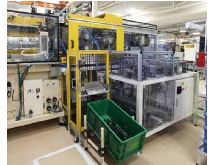
見える化のため装置カバーを鉄板からアクリルに変更。製造過程が見えるので、製品の理解が深まる。さらに、見られることを意識するため、5Sの徹底にも貢献。
