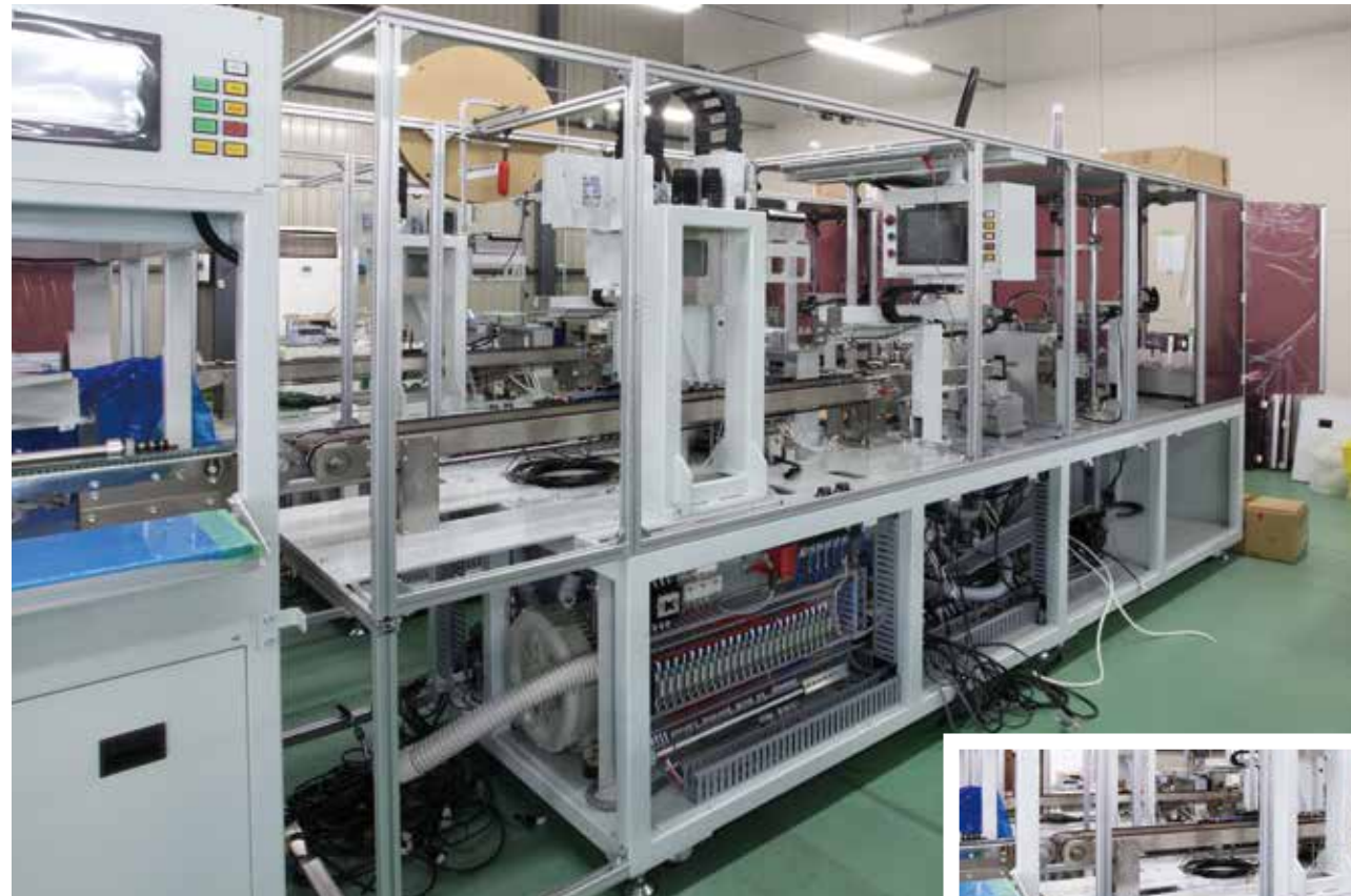
取材時、工場では主力製品であるDFシリーズの中でも古い型式のマシンについて改修作業が行われていた。カバーのほか、内部のパーツにもSFが使用されている。
