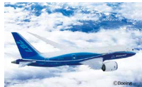
CFRP(炭素繊維強化プラスチック)が構造材の50%以上を占めているボーイング787
