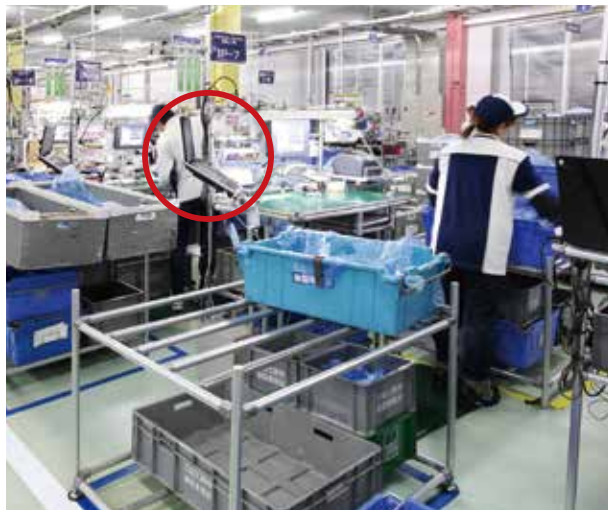
パソコンの取り付け角度や端材活用した工具入れなど、作業台には作業者ひとりひとりが使いやすいように工夫が施されている。
