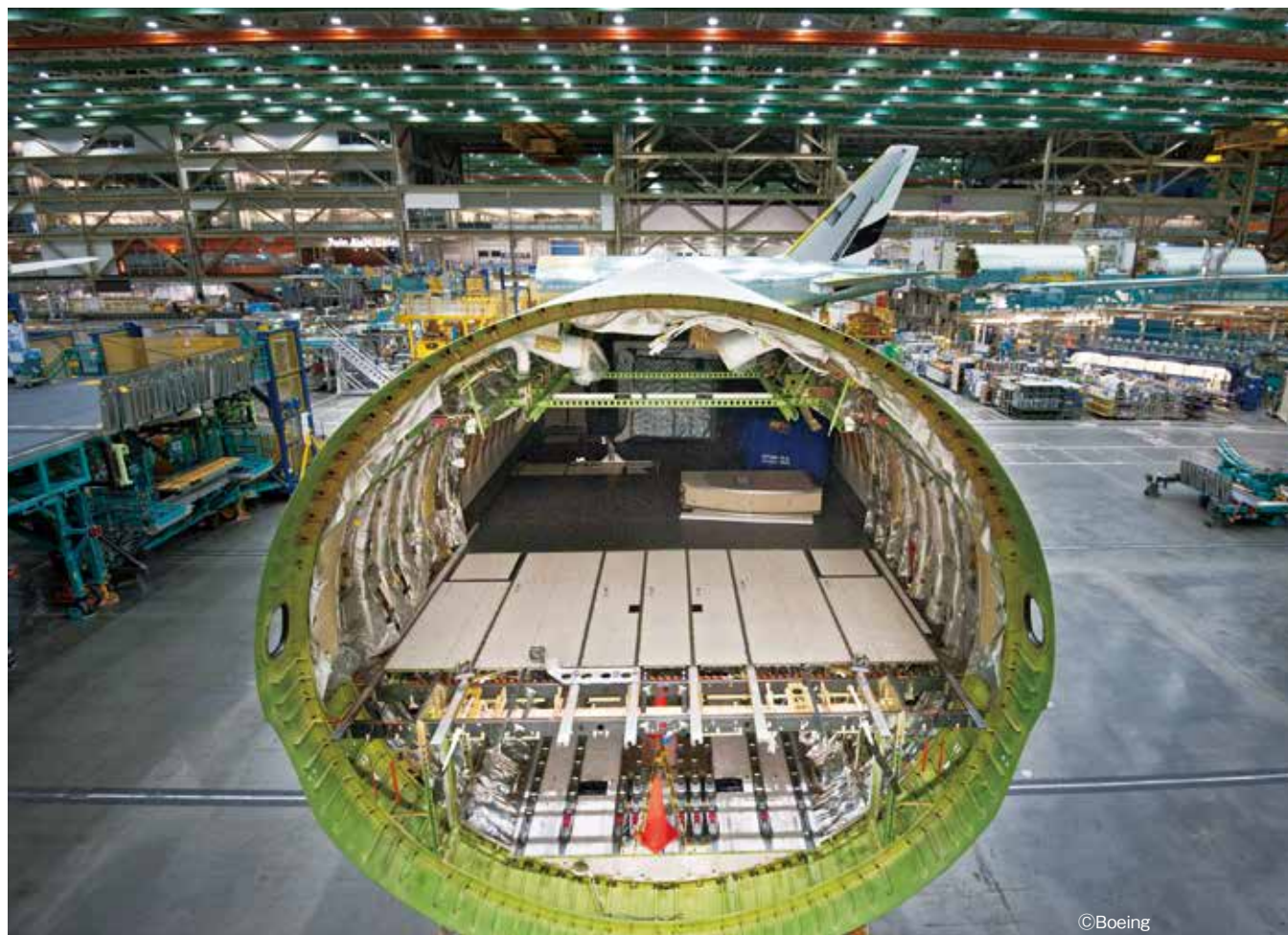
アルミニウム合金が構造材に多用されているボーイング777胴体部 断面。
