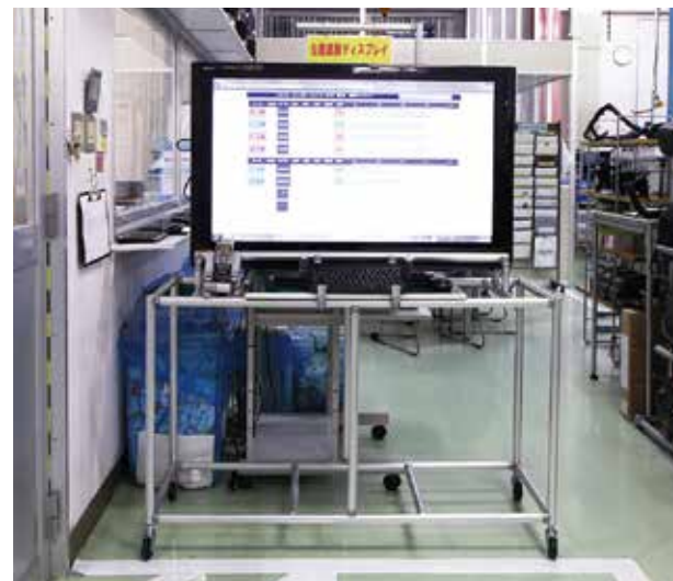
リモコンスタンドを付け、省スペース化と作業性を考慮しキーボードを斜めに設置するなど、アイデアと工夫が随所につまったディスプレイ台。
