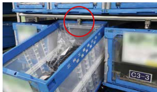
生産した製品が組立作業に使用されるまで保管しておく棚。上部に付いたコネクタが箱に引っかかるため、箱を取り出すことなくスムーズに製品の出し入れが行える。
