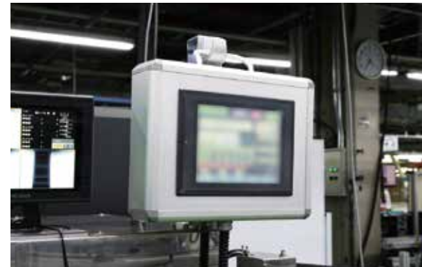
タッチパネルボックスにもSUS製品が採用されている。アルミボディは軽さや美観だけでなく、熱伝導率が高く、放熱性に優れるため、機器への負担を軽減する。
