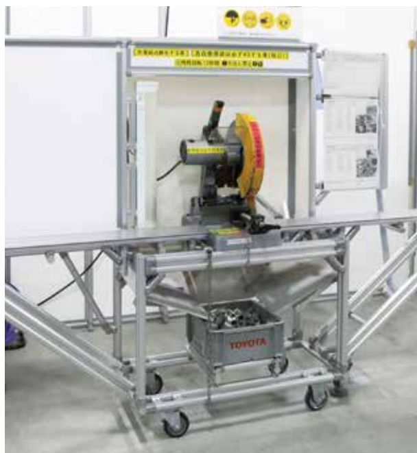
アルミ構造材SFとアルミパイプ構造材GFを用いてつくられたフレーム専用切断機。
