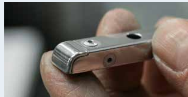
こんなに細い角管も手作業で組み立てる。目をつぶって触ると継ぎ目がわからない。
