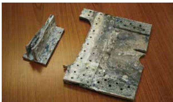
海水から引き上げられたゼロ戦機の一部（主翼桁）。押出材と板がリベット留めされている。
