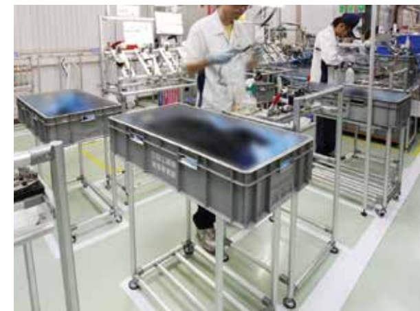
コネクタとチューブを圧入し接合部を確認する工程。水を使用するため、腐食に強いアルミフレームは最適とのこと。
