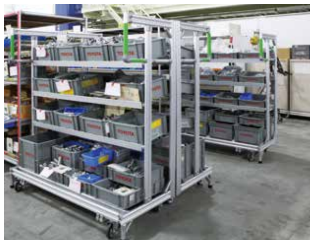
アルミパイプ構造材GFを用いたキャスター付収納棚。ここではGFの端材を分類して収納。作業のムダを省いている。
