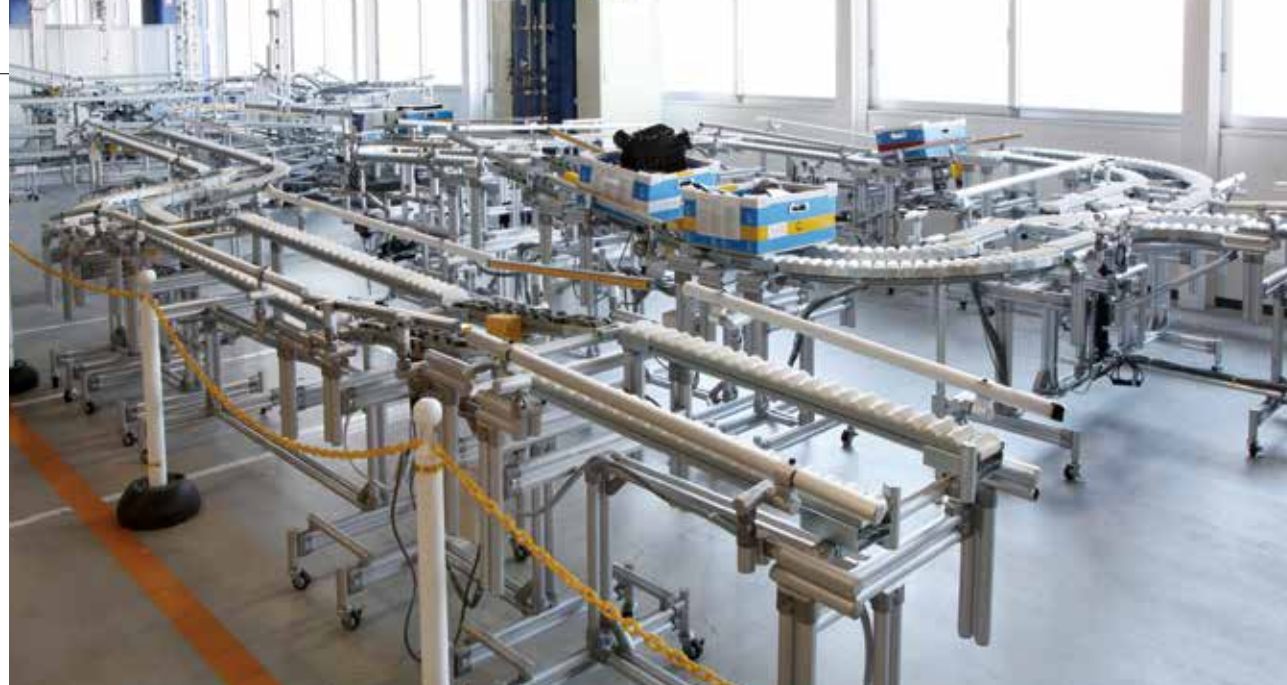
生産ラインをイメージしてつくられたモックアップ。ワークの自重を巧みに利用し、さまざまな機構が取り入れられている。
