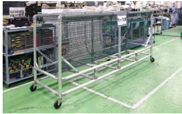
チューブを搬送するための台車。鉄製から切り換えることで、軽く動かしやすくなり作業効率が向上した。
