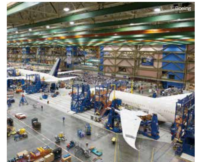
ボーイング787(CFRPが主要構造材)が組み立てられている様子。
