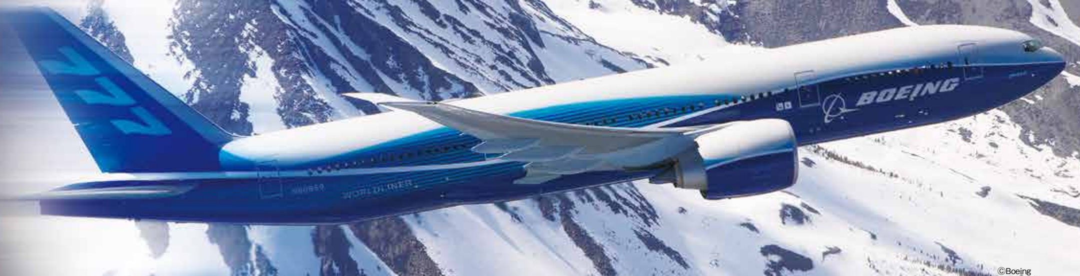
構造材料の70%をアルミニウム合金が占めるボーイング777。1995年6月の運航以降、全777型機の累計フライト数はなんと220万回以上にのぼる。
