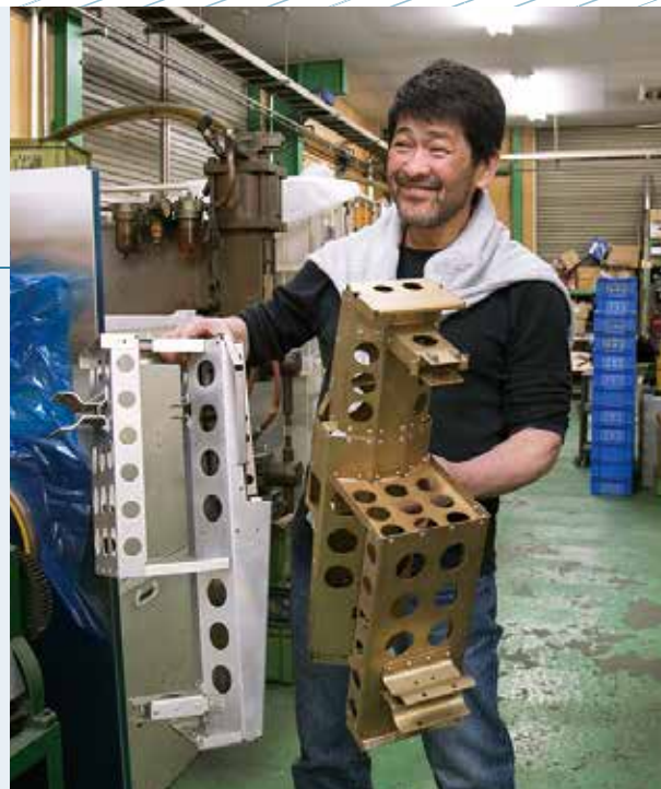
航空機の座席シート肘掛部分はジュラルミン製。片手で楽に持てるほど軽量だ。
