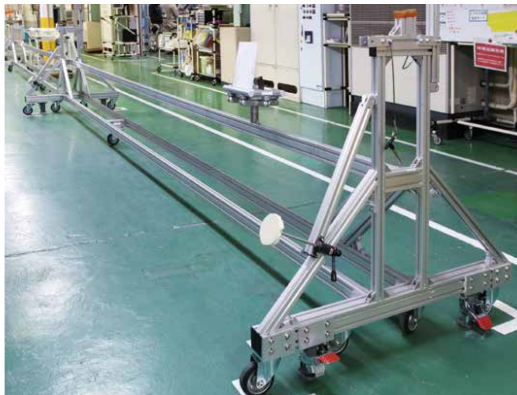
主翼桁（スパー）を取り付ける作業台ラック。 アルミ構造材SFを用いて社内内で内製化している。
