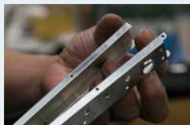
両端を折り曲げ、組み合わせる。寸分の狂いもないほど見事にぴたりと納まる。
