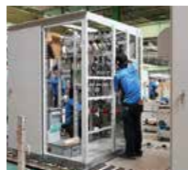
日東工業唐津工場内 キュービクルを組み立てている様子。
