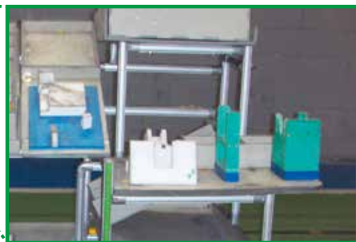
部品に合わせた台。間違ったアイテムは載せることができず、ボカよけになる。 A table with the stands matching shapes of the parts. This foolproof system prevents incorrect parts from being placed on the table by mistake.
