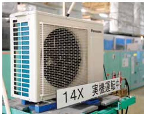
室外機の検査ライン。すべてのデータを蓄積し、不具合が生じた場合は後追いでトレーサビリティが導入されている。
