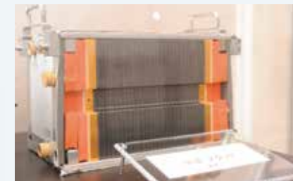
エネファームの中に組み込まれている「スタック」。電解質膜や電極触媒などによってセルが構成されている。
