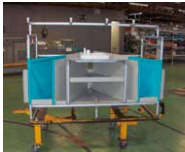
布を張り、パーツに傷がつかないよう工夫した台車。 A trolley with a cloth cover used for the areas where parts are loaded to avoid damage.
