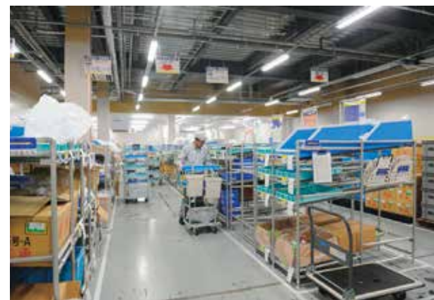
1階のピッキングエリア。掃除機で3階の組立工程に供給する台車などの埃やごみを吸取る徹底ぶり。
