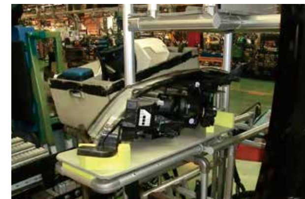
ライトを置く台にはボカよけの仕組みが使われている。 The rack for lamps also has an error-proofing system.
