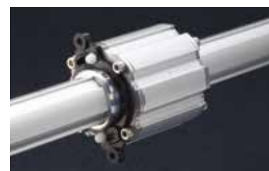
ワンウェイクラッチ 一方向にのみ回転するパーツ。巻き取り機構などを構成できます。
