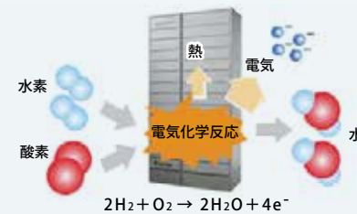
エネファームの中に組み込まれている「スタック」。電解質膜や電極触媒などによってセルが構成されている。
