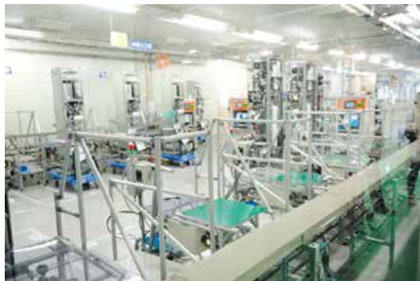
背丈のあるエネファームを組み立てるためにGFでつくられた専用の踏み台。現場スタッフが自分たちで製作しているとのこと。
