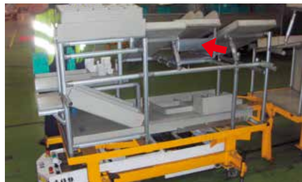
台車の裏側。トレーをスライドさせるためヒンジコネクタを用いている。 The back of the trolley. The tray is mounted with a hinge connector so that it can slide.
