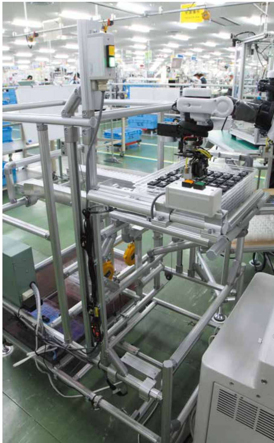
ハイブリッドセル生産ラインに組み込む予定で実験中の作業ロボット。からくり思想簡易自動機を駆使し、軽量ワークを次工程へと送り出す。
