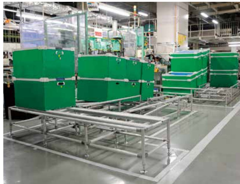
コロコンのついたシューターで大きな実箱に入った部材も随時積載され、現場内に搬送される。
