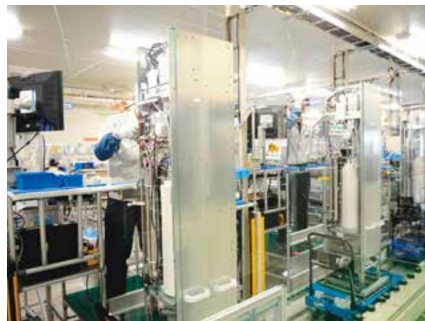
エネファームの組立は台車を移動させながら行われている。
