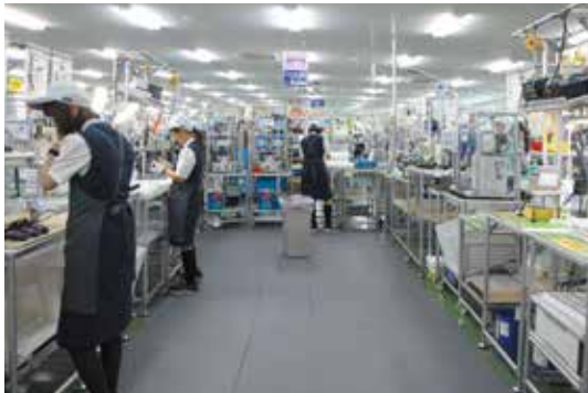
セル生産ライン全景。現在はオートメーションの機械で組み立てられたヘッド部の生産ラインと連動した仕組みになっている。
