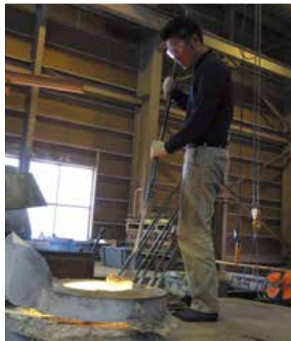
アルミ鑄造の中では難しいとされるAC7A。熟練した職人の手によって溶解される。
