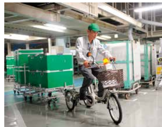
時速5kmの低速安全走行、1周200mの工場内を電動アシスト自転車で運搬。
