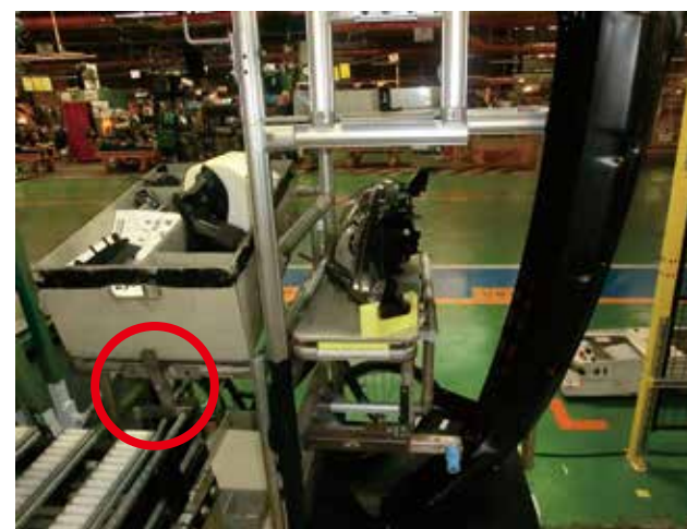
丸で囲んだストッパーが外れるとコンテナが払い出される。 When the stopper is released, the container is ejected. (The stopper is circled in red in the photo.)
