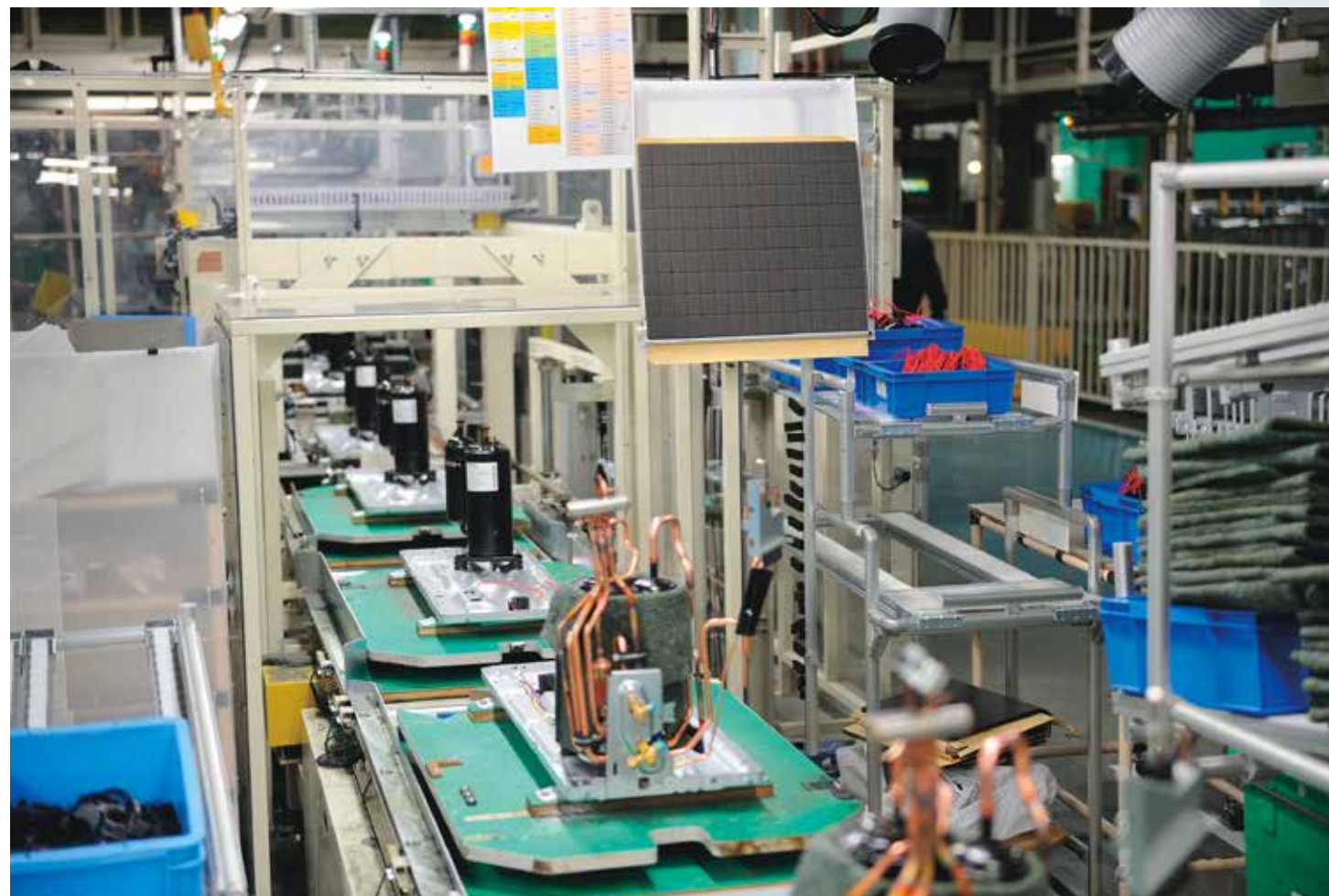
エアコン本体の組立ライン。10kg以上の重量物部品はここで取り付けられる。
