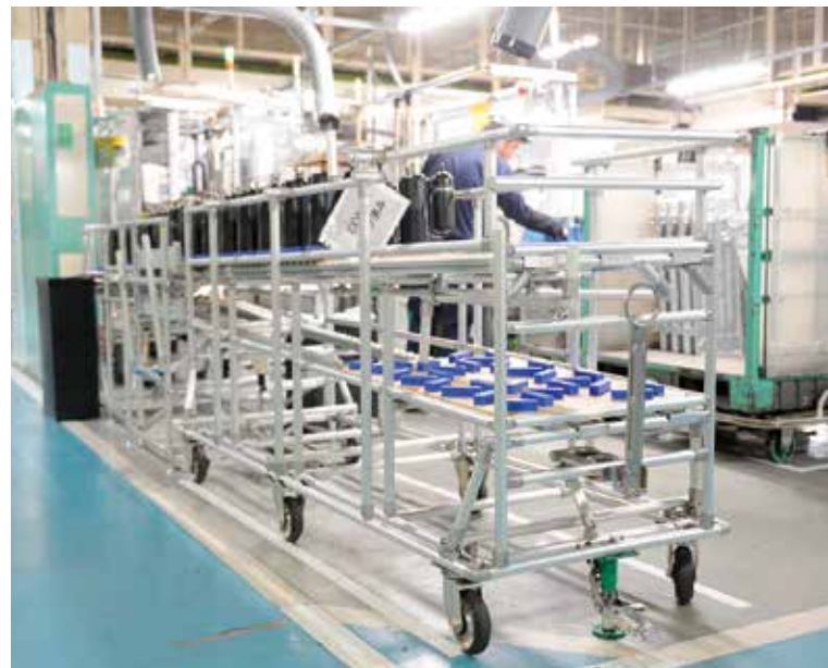
10kg/個の部材を25個積載し、台車込みで約300kgの重量物を自転車で運送するための台車。
