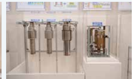
燃料処理器。「燃料改質部」「CO変性部」「CO浄化部」の3つから構成されている。
