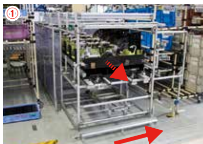
キット工程(写真奥)で必要なパーツをセットしたキットボックスをシューターに流しAGV台車が自動で回収。
