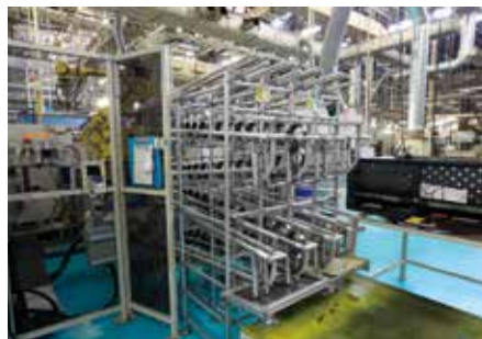
GFの曲げフレームを活用し、折り返し形状にしたことで1台に5段分のワークを保持できるストッカー。
