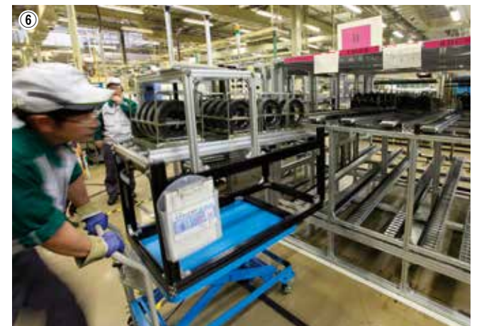
現在、ワークの投入は作業者の手で行われている。今後はこの作業も自動化して行く予定。
