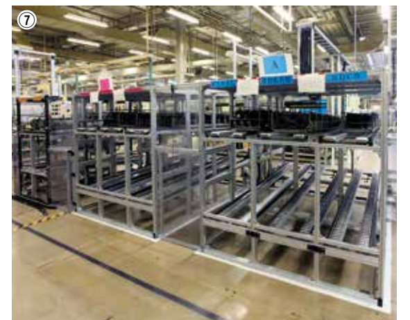
自動供給払い出し装置の全景。
