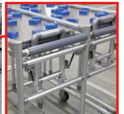
GF製の払い出し台車。運搬時は先端についているストッパー(右写真)を上げておく仕組み。
