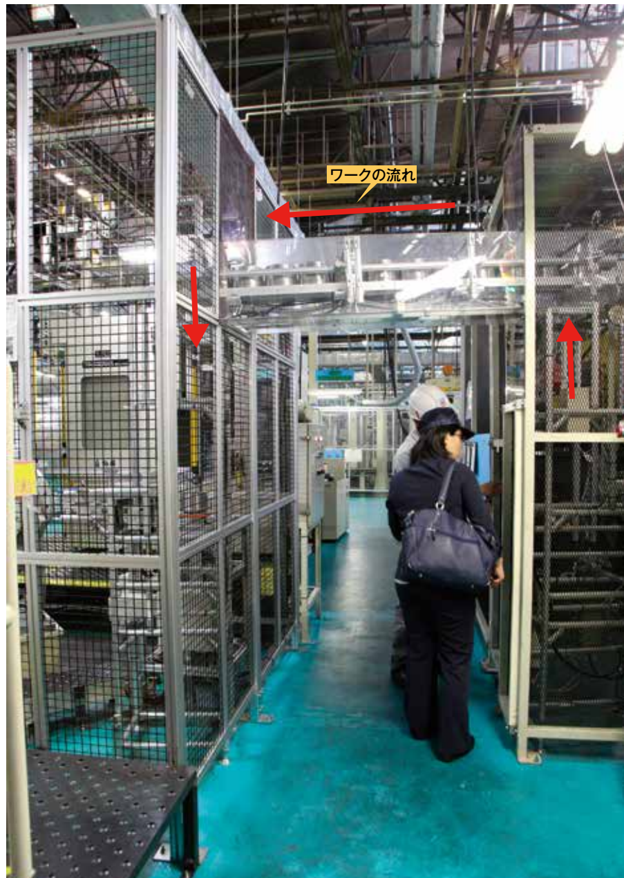
3地区に設置されたからくりエレベーター。加工が終わったワークを重りとロボットなどの動力を併用して上を持ち上げ、人の頭上を通して次の工程へ運ぶ仕組み。
