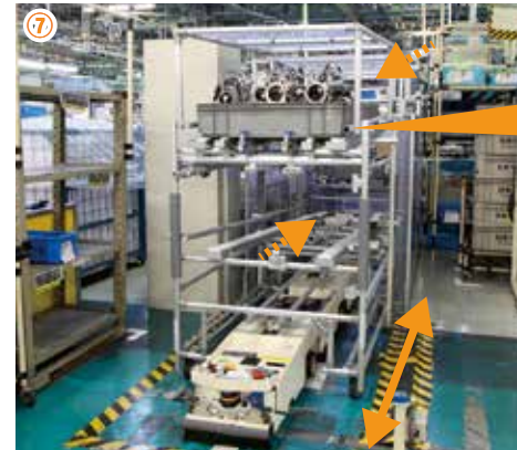
⑦人の背丈ほどの高さがあり、実箱を上段に、空箱を下段に積載するタイプのからくり台車。⑧供給するシューターへたどり着くと実箱を排出し、空箱を回収する。
