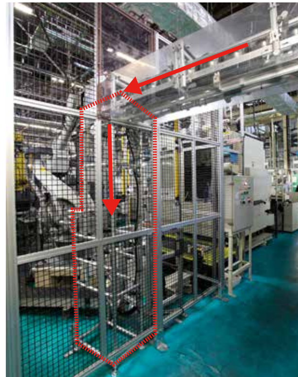
頭上を渡るシューターもGF製。安全柵の中にエレベーターが見える。
