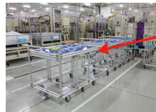
GF製の払い出し台車。運搬時は先端についているストッパー(右写真)を上げておく仕組み。
