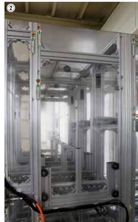
センサーが感知するとシリンダーが作動し、エレベーターでワークを上段まで持ち上げ、次工程へと流す仕組み。
