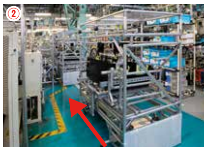
台車はAGVの磁気テープに沿って、パーツの入ったキットボックスを次の工程へと運ぶ。
