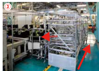
台車が組立工程側のシューターにたどり着くと、キットボックスが自動で払い出される。
