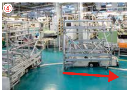
空になった台車は引き続き磁気テープに沿って場内を進む。
