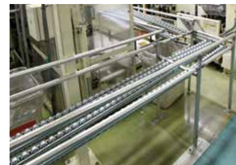
軽量な小型部品はGFを用いたシューターで運ぶなど、搬送物の大きさに合わせてフレームを使い分けられている。
