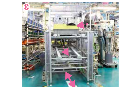
基本的な仕組みはからくり台車Bと同様。運搬するパーツの種類によって使い分けられている。
