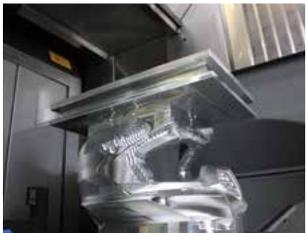
④ 第2工程開始。前工程で押さえていた四角い場所を削り取る。
