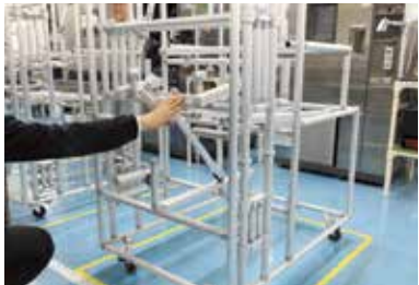
② 下段からワークが取り出されたことで、上段のワークが自重で下段へ流れ出す仕組み。
