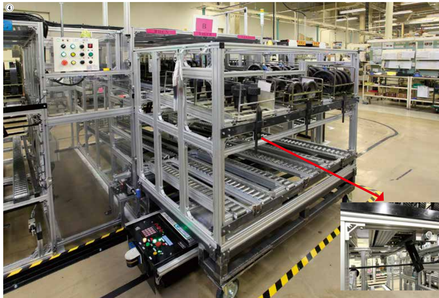
シリンダーが搭載されたことにより、AGV台車が所定の位置でぴたりと停まる。
