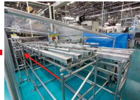
ワークごとに投入口が異なるシューターからパーツが供給される。
