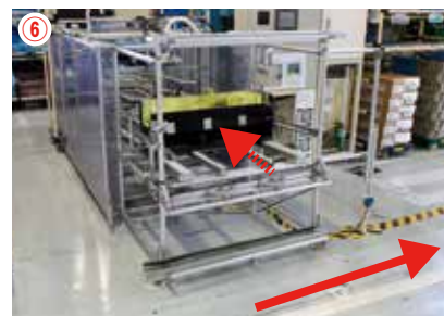
積載した空箱をキット工程側のシューターに払い出し、①に戻る。
