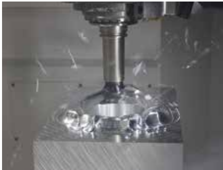
② まずは大きな工具を使って大胆に削っていく。
