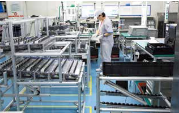
GFを用いた「からくり温度検査治具台車」を使って作業をする様子。限られたスペースを有効に使い、作業者の負担を最小限に抑えている。
