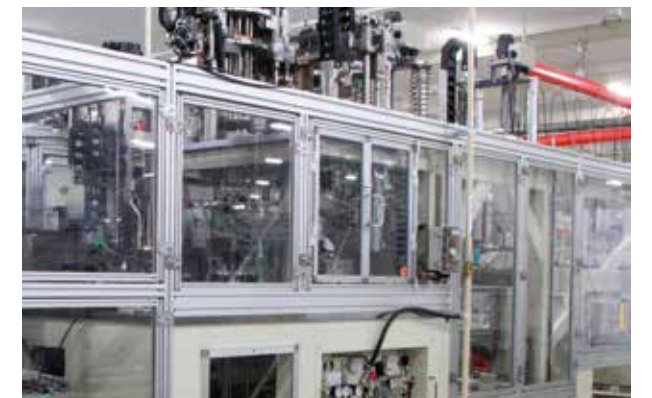
以前は月に2～3回ある調整作業のためにボルトをはずしていたという装置カバー。扉をつけ、作業性を向上させた。
