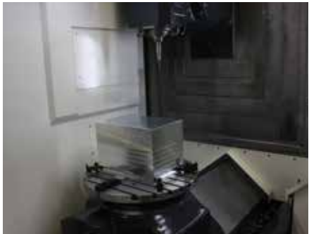
① いよいよ切削加工、開始。アルミの総重量はなんと120kg。
