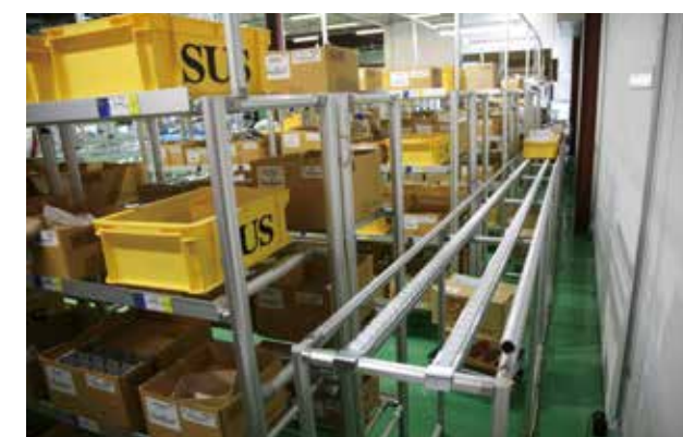
ピッキング棚の脇にはシューターをセット。写真の奥側にある検査工程へパーツを入れたコンテナを、そのまま流せる仕組みとなっている。
