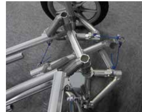
からくりのノウハウを生かしたワイヤーアクションによって、なめらかな操舵を実現。
