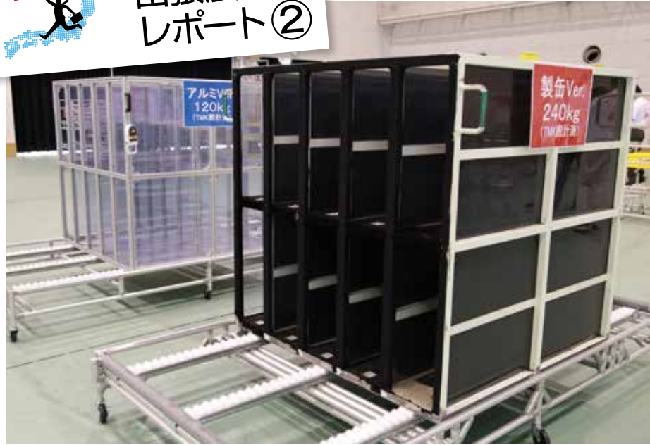
製罐をアルミフレームに置き換えることで、軽量化できることをアピールした比較展示。
