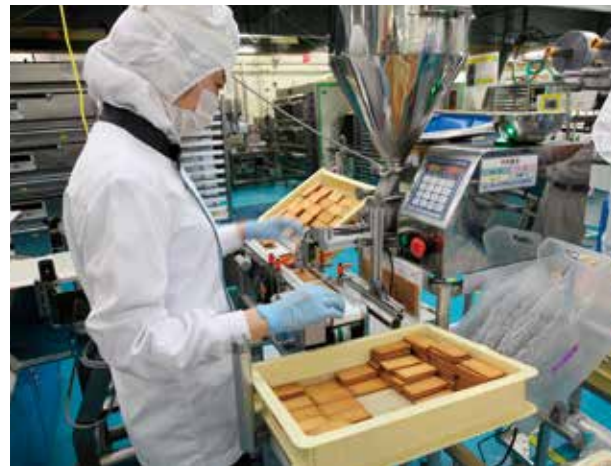
以前は充填機に合わせ、手動でサブレのクリーム充填を行っていたため、生産数に波が見られた。GFとコンベアを組み合わせ、運搬されたサブレに合わせて充填機を動かす仕組みを構築したところ、充填作業が安定した。
