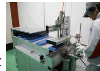
アルミ構造材SFを筐体に用い、社内で製作した端面タップ加工機。
