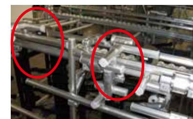
ブレーキローラーの押し付け力をウエイトで調整し、中子の搬送スピードを抑制
