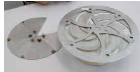
フリーサイズ落とし蓋をヒントに考案した「からくり回転台」。
