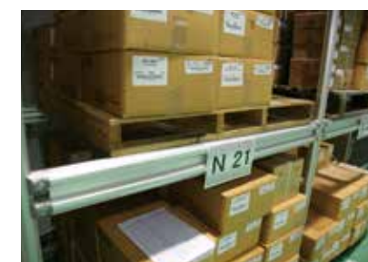
重量物であるパーツの保管ラックには、アルミパイプ構造材の新シリーズGF-L（外寸53mmタイプ）を採用している。
