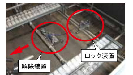
解除装置 ロック装置 空中子を搬出し終わるまでリフターの下降位置を保持させるインターロック機能
