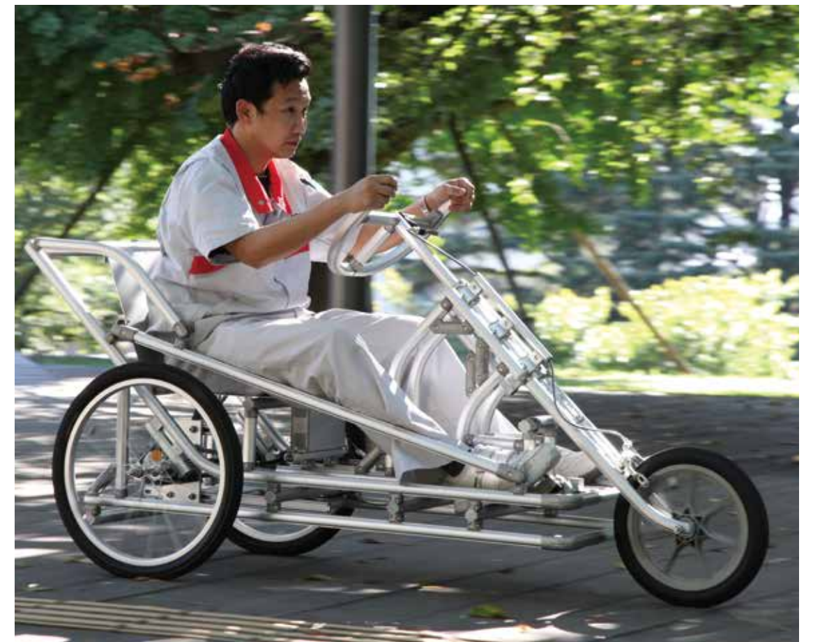
からくりのノウハウを生かしたワイヤーアクションによって、なめらかな操舵を実現。
