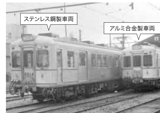
右:山陽電鉄2000系アルミ合金製車両。左:アルミ合金製車両と同じ仕様でつくられたステンレス鋼製2000系車両。同じ路線を走らせ、データ検証が行われた（写真提供:山陽電気鉄道）。
