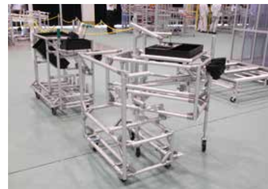
改善組の方が製作し、実際にラインで使用されている手元化同期台車も現場から持ち込まれ、特別に展示された。
