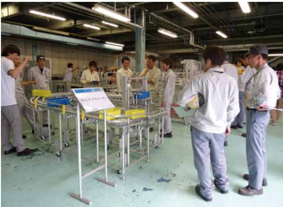
インデックスシューターには黄色と青で重さが異なるコンテナを自動で判別し、切り分ける仕組みが組み込まれている。
