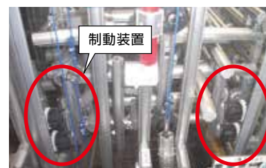
ウエイト重量と制動装置によるトルク差で動作させ、上昇スピードを抑制
