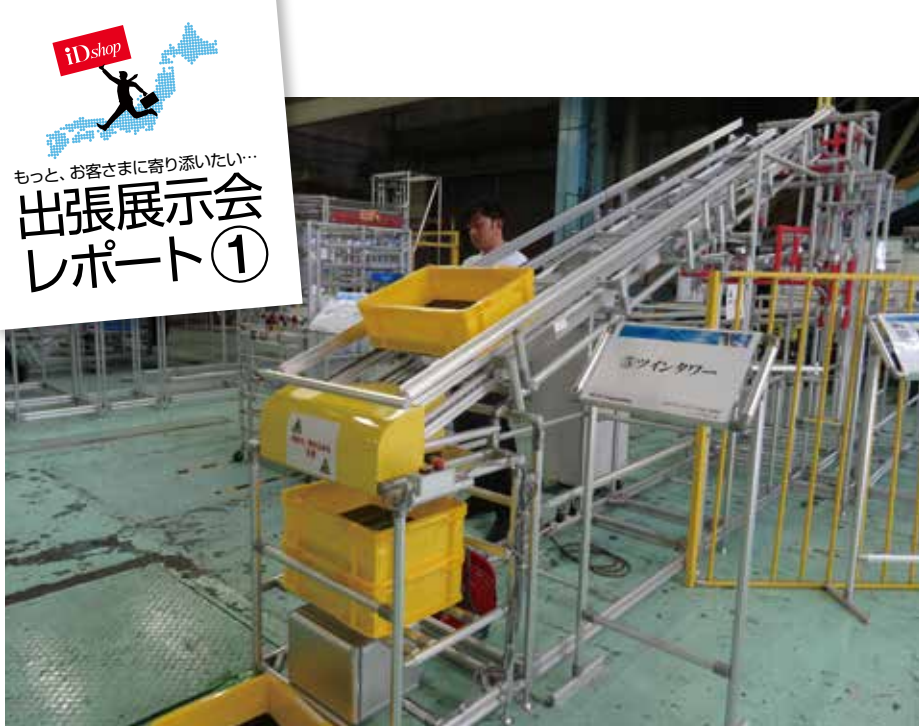
普段は九州事業所のショールームにあり、佐賀まで足を運んでいただかないと見ることができない“ツインタワー”。ターンや空中搬送などさまざまな機構を盛り込み、1台で多くのアイデアを見つけられるよう工夫した。
