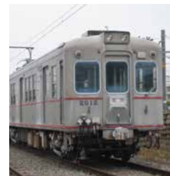
日本で最初につくられたオールアルミ合金製車両「山陽電鉄2000系」。1962年から1990年まで28年にわたって運用された（写真提供:山陽電気鉄道）。
