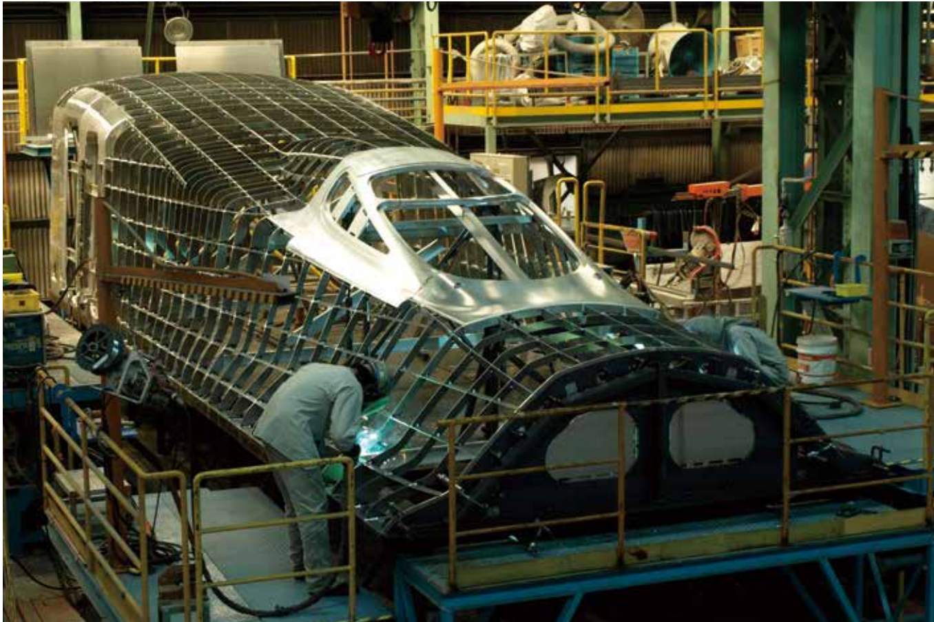
新幹線E5系先頭車両の製造風景。先頭構体を組み上げる基礎となる治具（じぐ）を製作し、その上に骨組を組み立てていく（写真提供：川崎重工業）。
