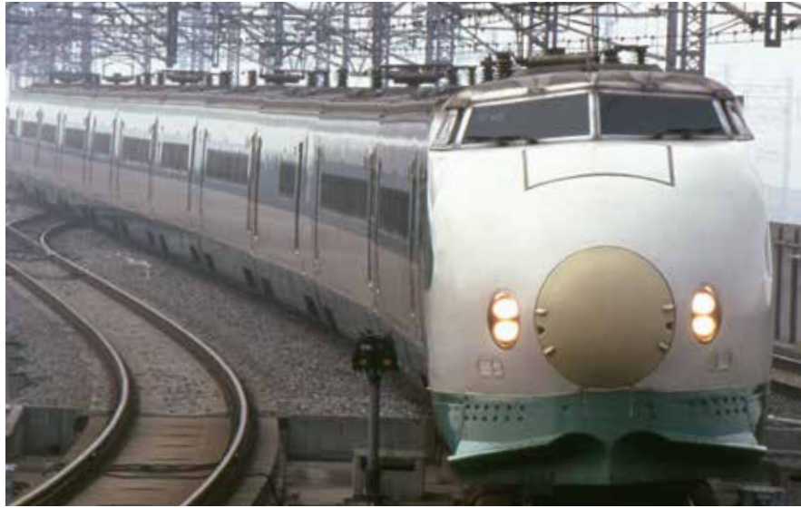
初めて新幹線にアルミ合金が用いられた200系車両（1982年）。さらなる軽量化を目指し、東北・上越新幹線に採用された。団子鼻が今となっては懐かしい（写真提供／JR東日本）。
