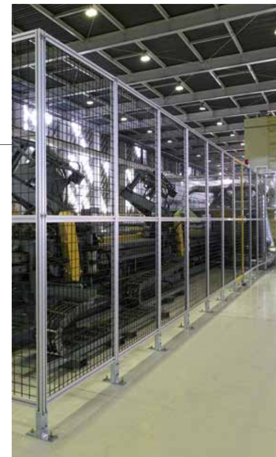
現場に設置された安全柵
