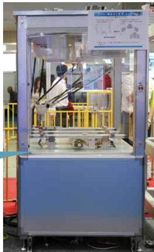
SUSブースで展示したデモ機。1,000×1,000×2,000 (mm)の筐体をZF80シリーズで構成しています
