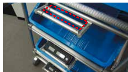
カートの手前に無線表示器を装着する台を設置。コンテナの出荷先に合わせた情報が表示される。
