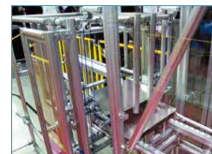
⑦ 段バラシユニット ⇒ 分ける 3段に積み重ねたパレットを 1 個ずつに切り分けます。
