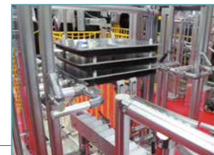
⑤ 段積みユニット ⇒ 積み上げる パレットを自動で積み上げて排出します。3段になるとセンサーが感知し、次工程へ送りだします。
