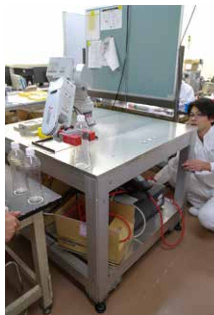
創談室では多関節ロボットを搭載した実験機の架台として、架台用構造材ZFも採用されていた。
