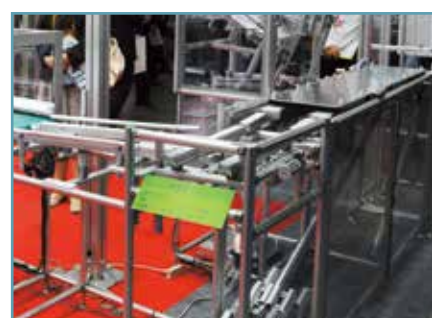
② 水平ターン ⇒ 方向を変える 基本モジュールの1つです。パレットを取り込むと自重によって傾き、進行方向を 90° 変えます。
