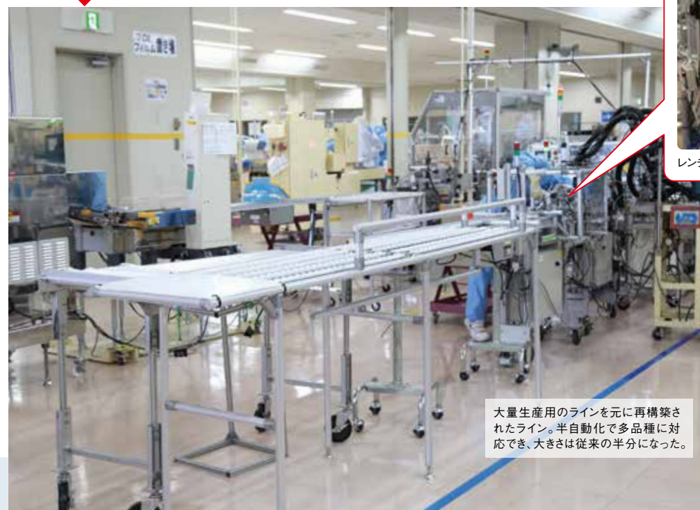
粉末アイテムの成形品を容器に詰める、大量生産用の大型ライン。1日に約4万個の生産が可能で、出荷数が多いアイテム・時期に使用される。
