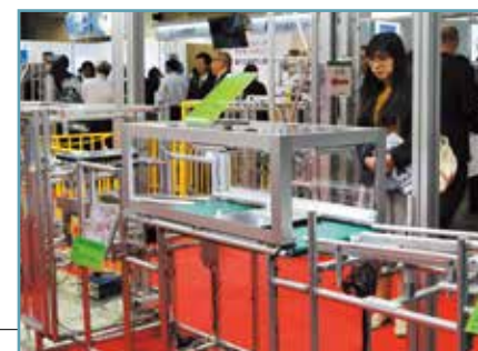
③ 検査ライン ⇒ 運ぶ ◆GFコンベア (開発中: 参考出品) GFをベースにしたベルトコンベアです。GFを使って架台やカバーを構成できるため、さまざまなラインを素早く構築できます。
