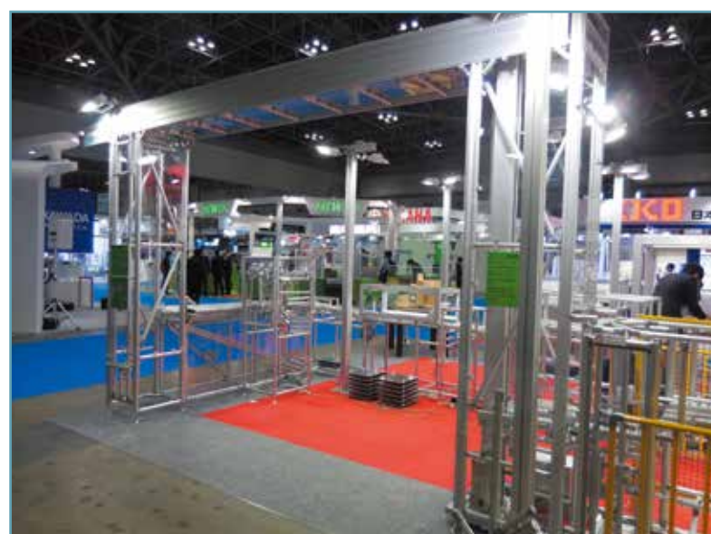
⑧ 空中搬送 ⇒ 上げる、運ぶ、下げる スペースを最大限活用するために、空中を利用した搬送システムです。高い位置にパレットを流し、作業者の通行や、他の物流の妨げになることを防ぎます。動力は、上昇部の電動昇降機 (開発中: 参考出品) のみ。下降は重力を利用しています。
