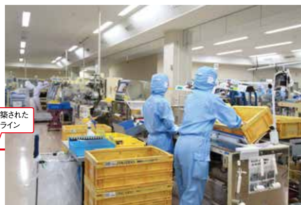
粉末アイテムの成形品を容器に詰める、大量生産用の大型ライン。1日に約4万個の生産が可能で、出荷数が多いアイテム・時期に使用される。
