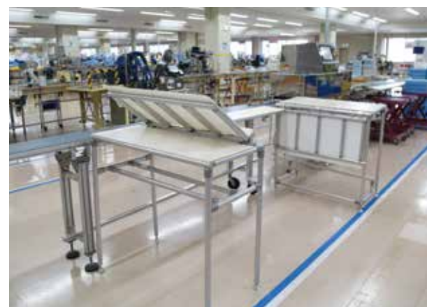
コンベヤの脇に設置されたGF製作業台。以前はコンベヤを用いたラインが多かったが、現在はコンパクトな形に変わってきているとのこと。
