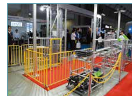
⑥ AGV台車 ⇒ 受け取る、運ぶ、渡す 段積みされたパレットを無人で搬送し、人の手を使わずに次の工程へ受け渡します。
