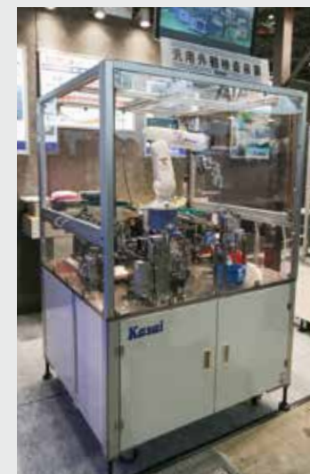
ボールやシュートなどのパーツを取り替えて多品種に対応する「クイックチェンジシステム」採用のパーツフィーダーやツールと、垂直多関節ロボットを組み合わせた汎用検査装置です。
