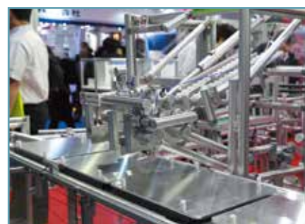
① ワーク供給機 ⇒ 掴む、運ぶ、離す 1つの電動パーツ (パワーユニット) によってシューターからパレットにワークを供給します。会場ではパレットの上に透明のプラスチックを載せる動きを実演しました。
