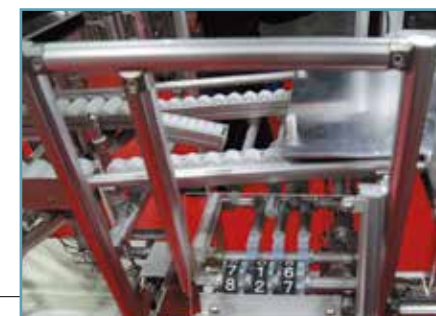
④ パレットカウンター ⇒ 数える パレットが通過する力を使い、動力を用いずに数量をカウントします。
