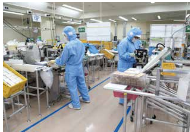
ワンピースフローラインは全部で14本。1本のラインに最大2名入ることができ、生産量に応じて人数が振り分けられている。
