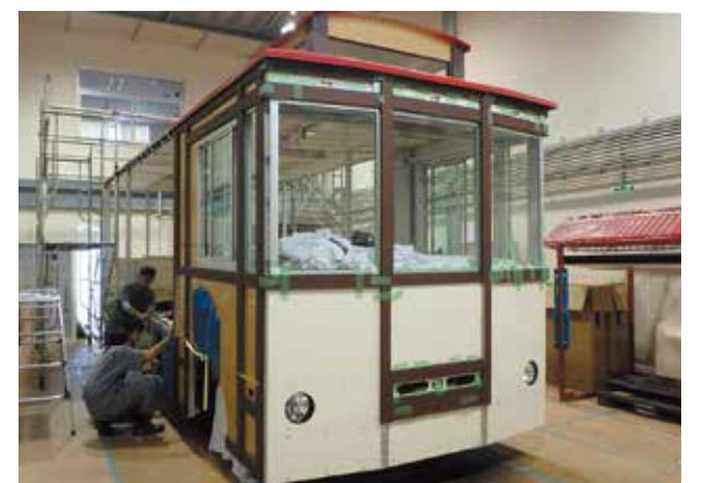
完成した骨組みに、アルミ製のパネルや人工木による装飾を施していく。塩害対策のため、シャシー以外に鉄は使用していない。
