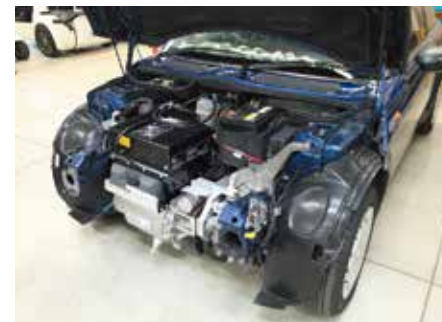
既存の自動車のエンジンを取り外し、モーターと電池を取り付けたコンバートEVは、ものづくりネットワーク沖縄が進めている研究開発テーマの1つ。
