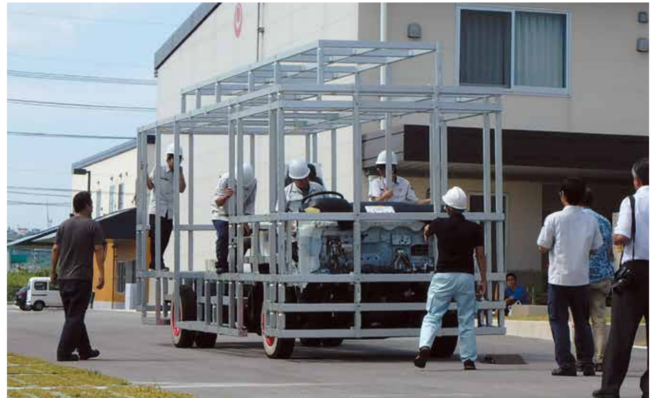
骨組みが完成した段階で行われた応力テストの様子。沖縄県金型技術センターと共同で、車体にひずみゲージを張り、実際に走行させて数値を測定している。装飾前のため、ZF製の骨組みが確認できる。
