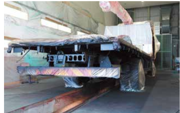
沖縄日野自動車の防錆塗装ライン。沖縄で販売する車は、塩害対策のためすべて塗装を施して納入しているが、5～6年使用すると再塗装が必要になる。
