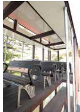
ベンチの側面にはアルミの削り出しによるレリーフ柄をデザインし、肘掛には屋外使用に配慮した樹脂を使用した。
