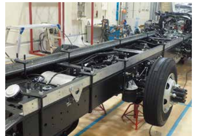
元のトラックからバスに必要な部分を取り外し、車体製作の準備を進めている。
