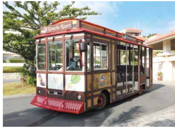
車体の化粧にかかった時間は1カ月ほど。ZF製の骨組みはアルミパネルや人工木による装飾の下に隠れているため、直接確認することはできない。
