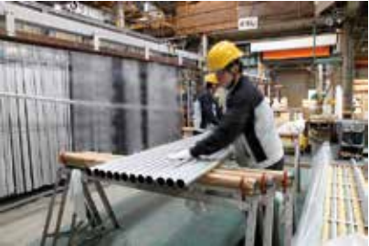
本社 第2工場の枠外し行程。処理が終わった形材を1本ずつ検査していく。
