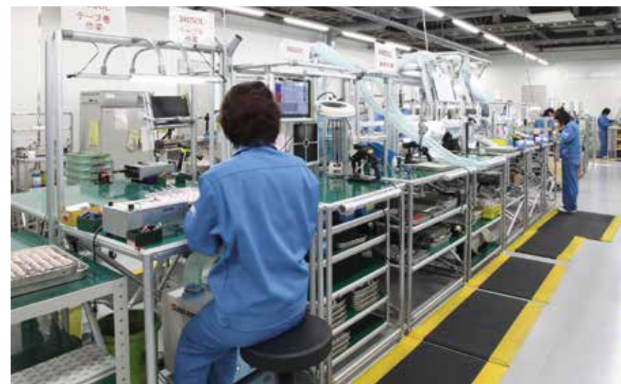
新工場の建設に合わせて作業台をGF製に一本化。奥行きなどの基本仕様を定めて統一感を出しつつ、作業に合わせたカスタマイズを行っている。
