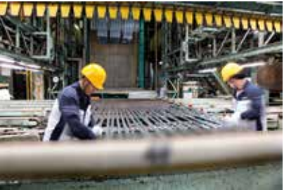
本社 第3工場の枠付け・枠外し行程。形材が手際よく治具に取り付けられていく。
