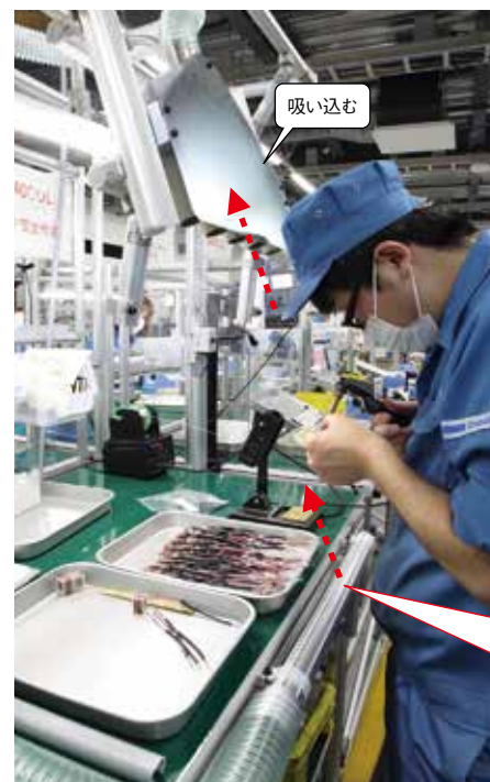
半田付け用の作業台。煙を吸い込まないよう、手元から風を送り、上部のダクトから吸い込む仕組み。
