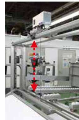
テーブルの昇降動作には電動ウインチを使用。
