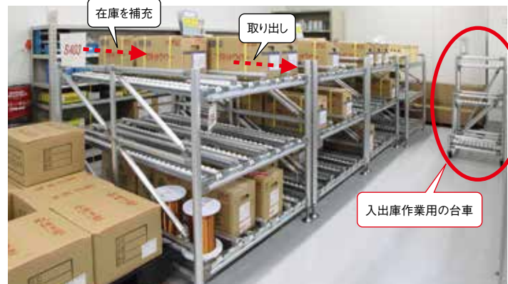
1箱20kgほどある重量部品の保管棚。補充・取り出しの方向を決め、積み替え不要で先入れ・先出しが可能となった。3段構成の台車を使うことで、滑らせるだけで取り出しができ、出庫時の負荷も低減した。
