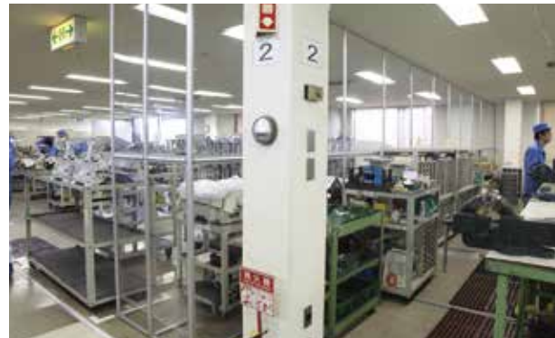
隣の工程で発生する異物が混入しないように設けられたパーティション。以前は鉄板を立てていたが、見通しが悪く高さも十分ではなかった。GFにより大掛かりな工事の必要なく設置でき、ものの流れも改善した。
