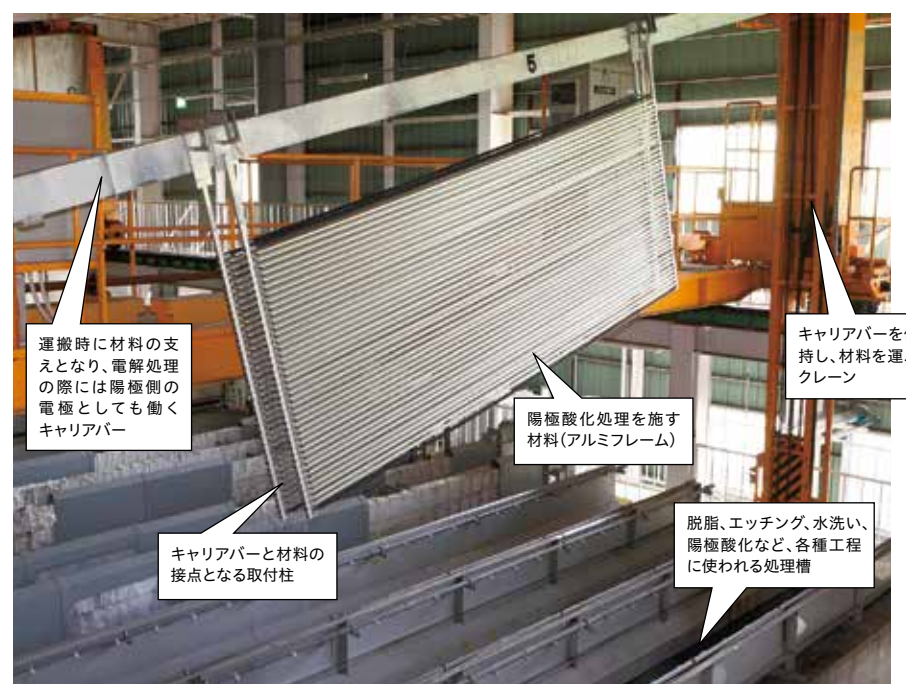
SUSの福島事業所にあるアルマイト工場の様子。キャリアバーに枠付け（ラッキング）された材料は、硫酸などの薬品で満たされた処理槽へ順番に運ばれ、処理が施されていく。
