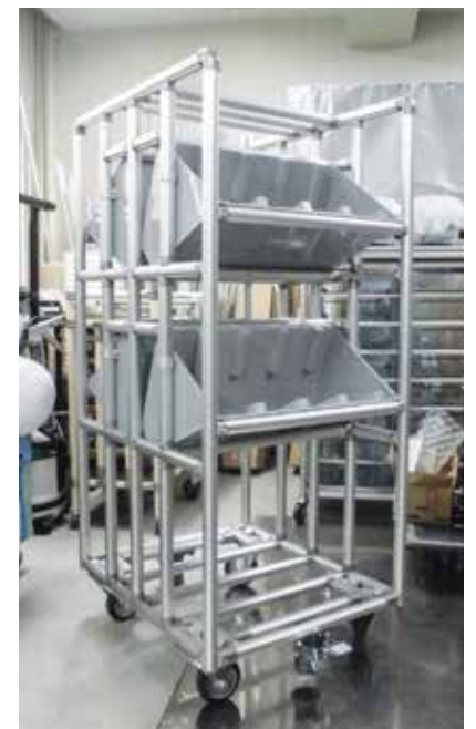
台形型の耐火容器を収める台車。鉄製と比べて非常に軽量となり、扱いやすくなった。
