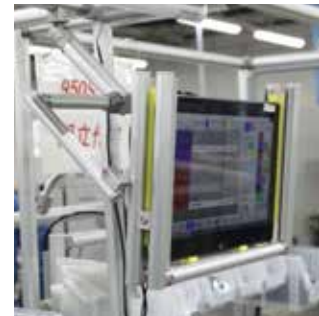
新工場の建設に合わせて作業台をGF製に一本化。奥行きなどの基本仕様を定めて統一感を出しつつ、作業に合わせたカスタマイズを行っている。
