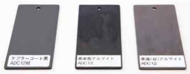
左端のケブラーコートの美しい仕上がりに対し、通常のアルマイト処理をした板には湯流れの模様が見える。
