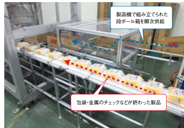
段ボール箱はラインの外側から、製品は内側から別々のコンベヤで箱詰め用のロボットへ運ばれる仕組み。
