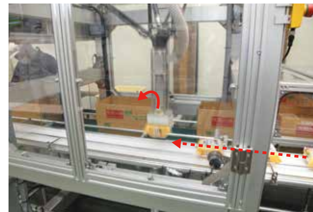
箱詰めはパラレルリンクロボットが得意とする作業。ロボットのハンドで吸着された製品が箱の中に整然と詰められていく。
