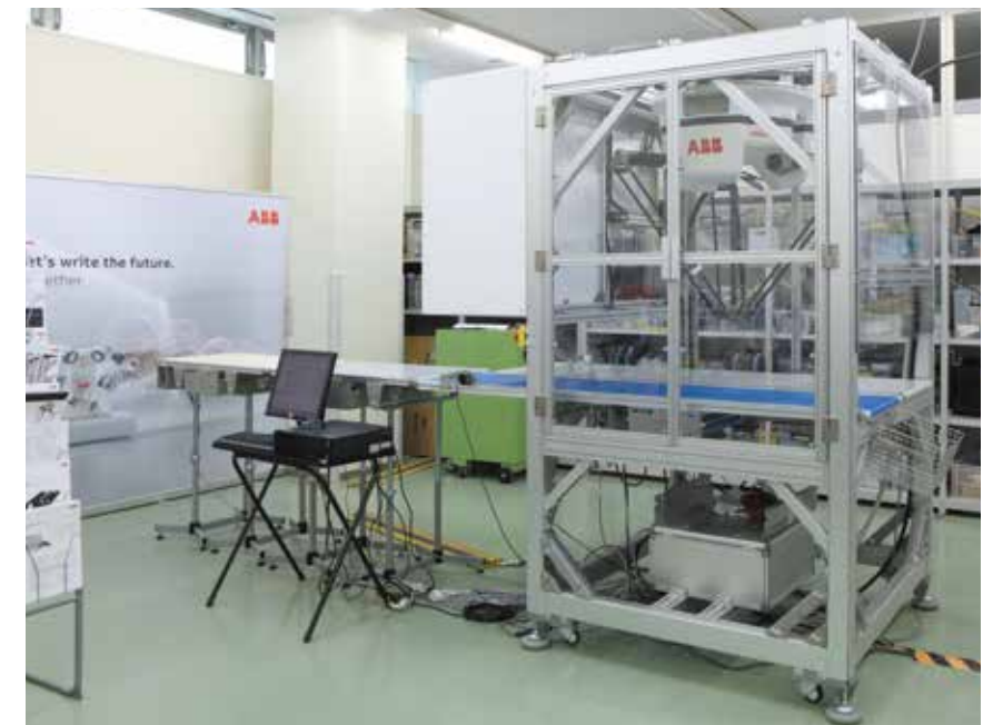
ロボット・コンベヤ・安全機器・コントローラ・ビジョンシステムなど、必要なものが一通り揃ったFlexPicker オールインワン。日本国内向けに販売している。
