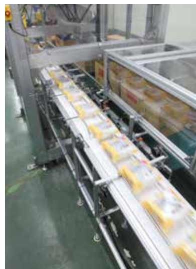
コンベヤ周りはアルミパイプ構造材GFなどを中心に製作されている。
