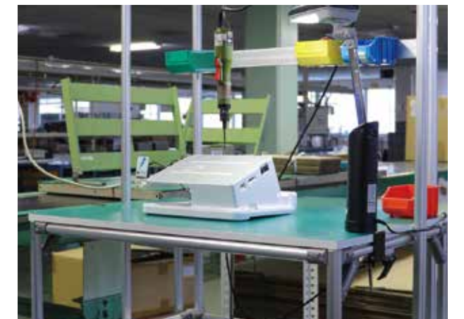
作業台の高さを調整し、ネジを締める位置のすぐ近くまで持ち上げることで、最小限の動作での組立が可能になる。
