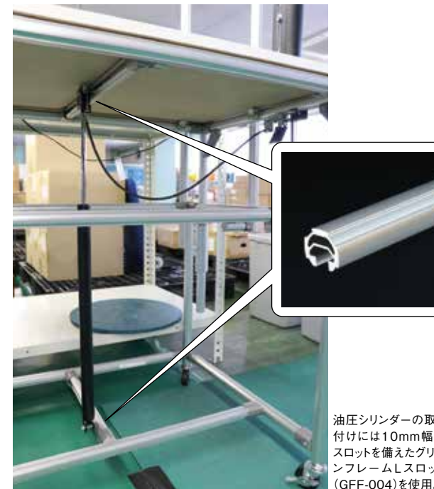
作業台の高さを調整し、ネジを締める位置のすぐ近くまで持ち上げることで、最小限の動作での組立が可能になる。
