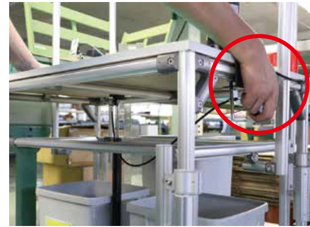
端にあるレバーを握り、台を押したり引き上げたりするだけで高さの変更が可能。音も静かなため周囲に気兼ねなく使用できる。
