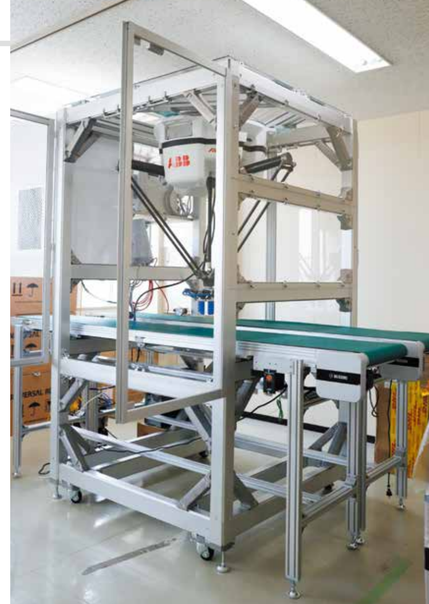
現在も食品産業での活用が多い平行リンクロボットには、架台にZFを用いたABB社製の「FlexPicker オールインワン」を採用。
