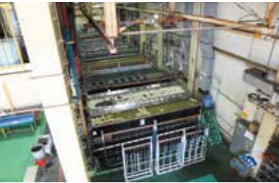
アルマイトライン。鉄道車両の窓枠や広告を掲示するための枠、新幹線N700系グリーン車の中木、またエレベータの接触棒などの表面処理を行っている。実際には白（普通）アルマイトではなく染色アルマイトで、白色に近い微妙なカラーリングを施す。処理の前にバフ研磨することがほとんどとのこと。
