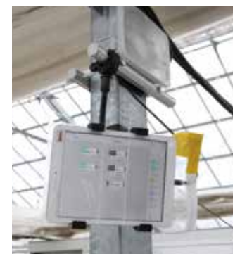
収穫時間を調べるシステムは、市販のプログラミングキットを活用し、手づくりしたもの。100円均一のケースを利用するなど、コストを抑えている。
