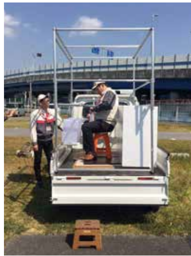
駐車場の隅で行われたという検証の様子。荷台にGF製の骨組みを載せて、中に人が乗り込み、サイズ感を確認しつつレイアウトを検討した。
