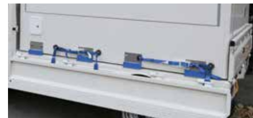
側面あおりを開けた様子。軽トラックには手を加えず、店舗となる荷箱を積み、固定するだけでキッチンカーが完成する仕様。
