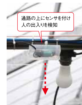
収穫時間を調べるシステムは、市販のプログラミングキットを活用し、手づくりしたもの。100円均一のケースを利用するなど、コストを抑えている。
