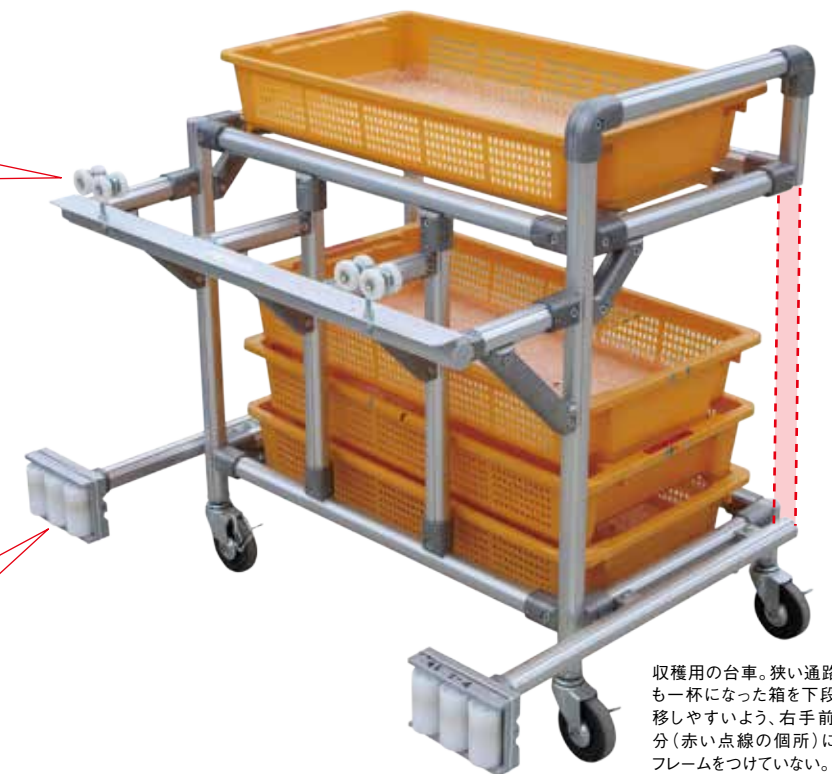
短いコロコンをフレーム側面に当て、動きを安定させる。
