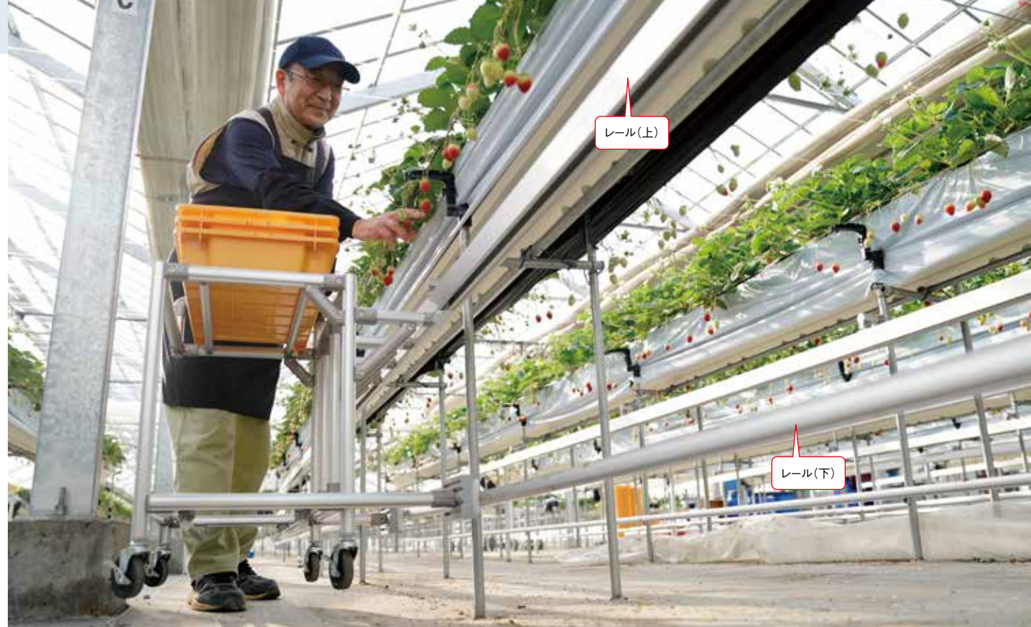
収穫用の台車は、栽培用ベンチの脚に取り付けたGF製のレールに沿って走らせることでタイヤが浮き上がる仕組み。地面の振動が伝わらず、イチゴに傷がつかない。
