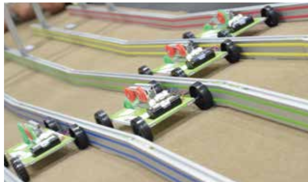
完成した模型でのレースの様子。プーリーの組み合わせ方はもちろん、丁寧に作られているかどうか結果に影響する。
