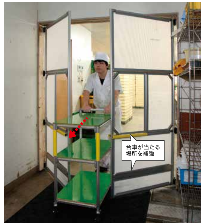
ドアを手で開ける必要はなく、台車を押したまま通行可能。通った後はバネの力で自然に閉まる。
