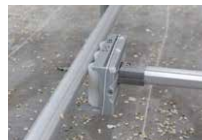
短いコロコンをフレーム側面に当て、動きを安定させる。
