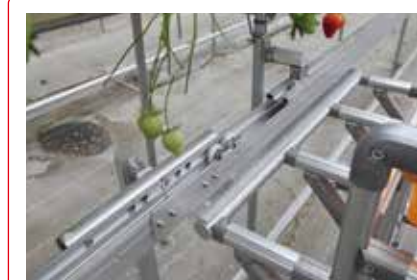
角度が変わる個所で滑車が引っかかるのを防ぐため、連結部分のレール上部に切り欠きを施している。
