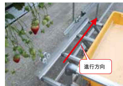
連結部と同様に切り欠きをしたレールの端。滑車が入るよう、台車を寄せて前進する。
