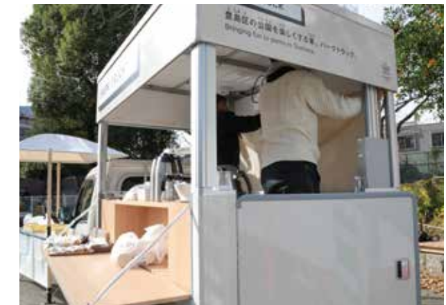
売店以外の開口部はマジックテープで布を張ってふさぐ(現在は作業性向上のため、パネルはめ込み式に変更)。
