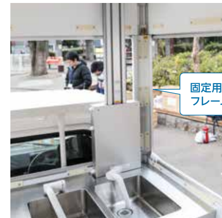
天井を一番上まで上げたら、四隅にフレームをセット。店舗として使用している間、天井の重さを支える。
