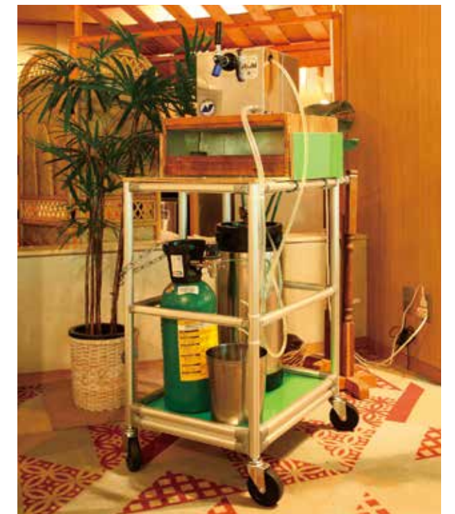
中のタンクやボンベが取り出しやすいよう、台車の上段は開閉可能となっている。
