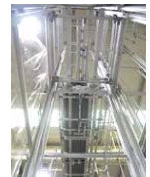
昇降装置の中から上部を見上げた様子。返送レーンから戻った空箱はロックを解除すると一つずつ切り出されて、地上へ下降する。
