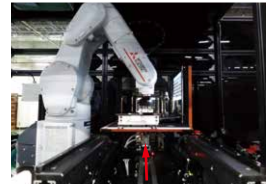
ロボットがキーボード検査などを自動で実施する。
