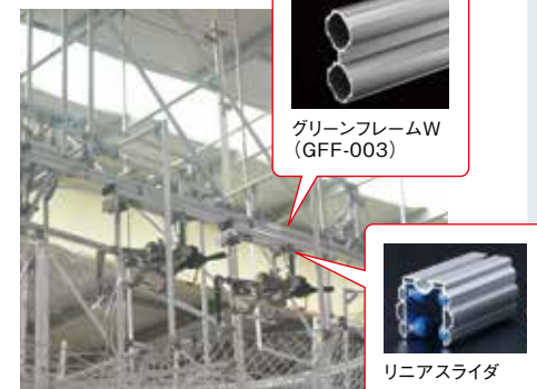
曲げ加工を施したグリーンフレームWを縦に使い、下側にリニアスライダを滑らせている。ベアリングローラーによりスムーズな動きが可能となった。
