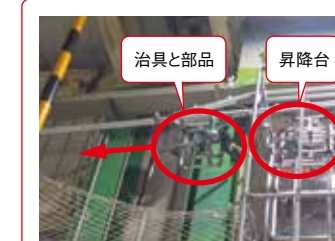
上端に達すると、昇降台から部品が載った治具を排出する。
