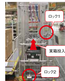
手元と足元のロック機構が連動しており、誤操作を防止する。
