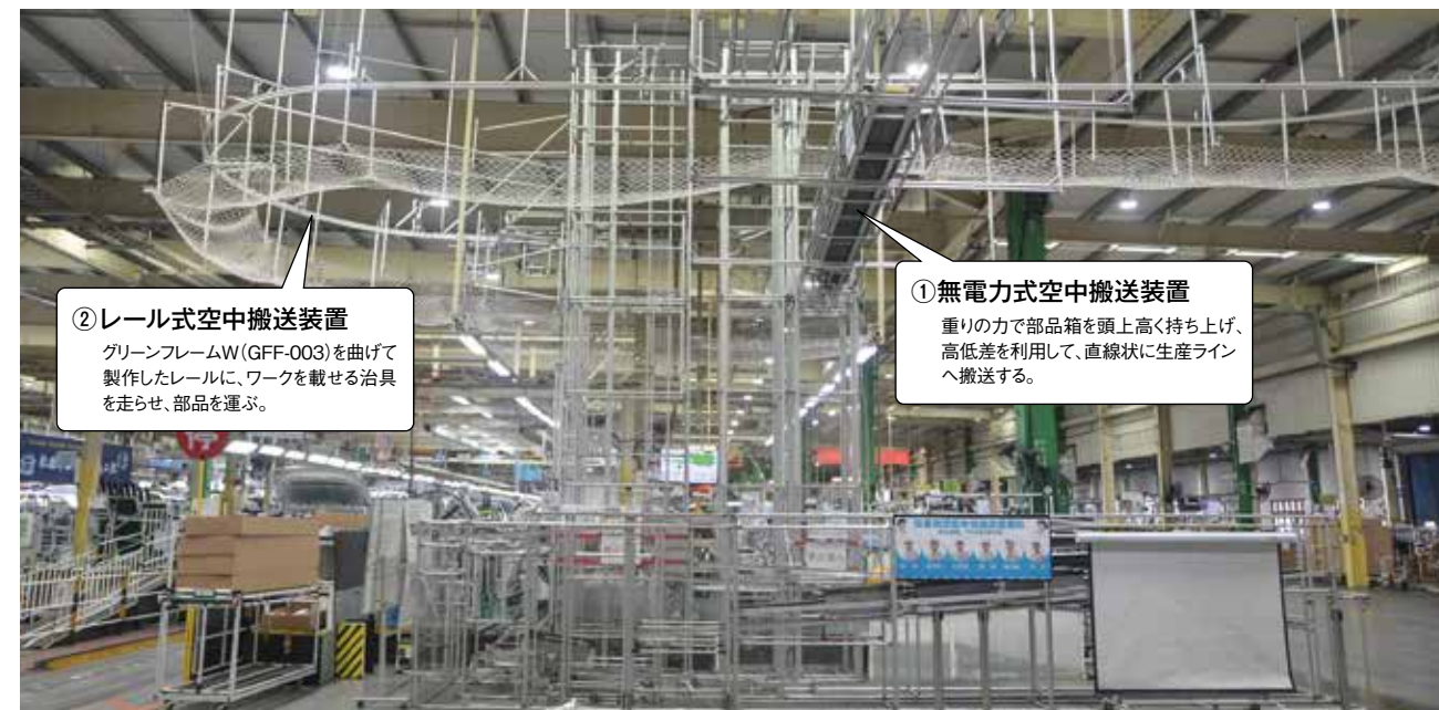
運ぶワークの種類や重さなどに応じて、異なる形・仕組みでつくられた2種類の空中搬送。どちらも最大高さは7.5mと非常に大型。
