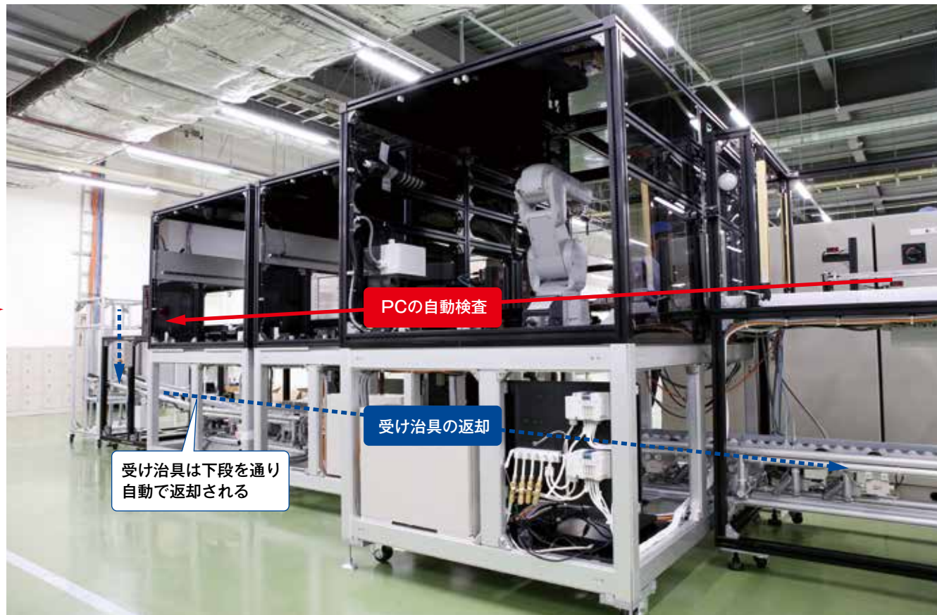
PCの各種機能検査や無線検査を自動で実施する。
