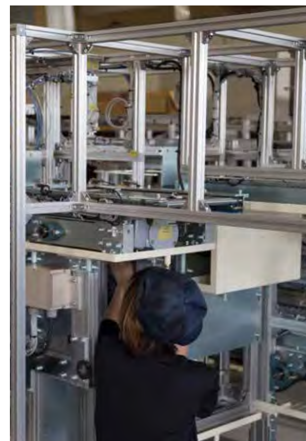
SFとさまざまな機器・アイテムを組み合わせ、設備を製作していく。
