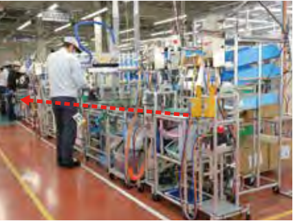
写真右手前から奥側へと続く組立のライン。4つの島に分かれており、それぞれに組立順に光るピッキング棚が設置され、部品の付け忘れなどを予防する。
