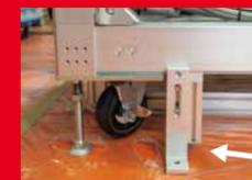
レイアウト変更・移動に対応するキャスター付き。使用時はアンカーにて固定します。
