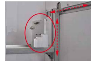
ボルトを緩めてずらすだけで、ワークに合わせてカメラ位置・高さの変更が可能です。
