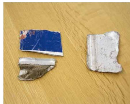
塗料や断熱材が付着したチップ材(左)と、高精度選別によって異物の除去が完了したチップ材(右)。
