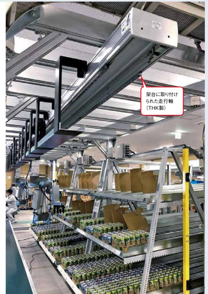
奥と中央に見える2台のロボット。ロボット先端の缶飲料用ハンドは、缶のピック以外にフローラックに残る空段ボールを掴む機構も備えている。
