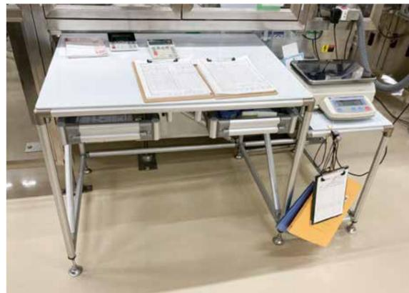
使用する機器、道具に合わせて作業机も内製。キャスターを付けた移動式(上)と、固定式(下)など、作業によって形を変え、使いやすいようオリジナルの仕様で組み上げている。
