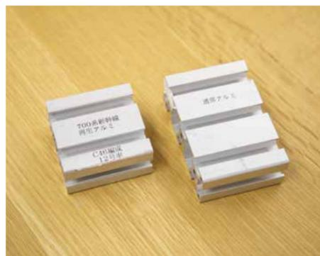
700系の再生アルミを用いた押出材(左)と、通常の原料を使用した押出材(右)。外観では違いはほとんど分からない。
