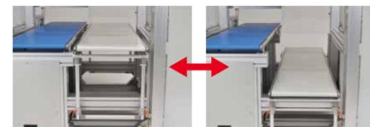
コンベヤの高さ調節機構を付けることも可能。ノブボルトを緩めるだけで希望の位置へ上げ下げできます。
