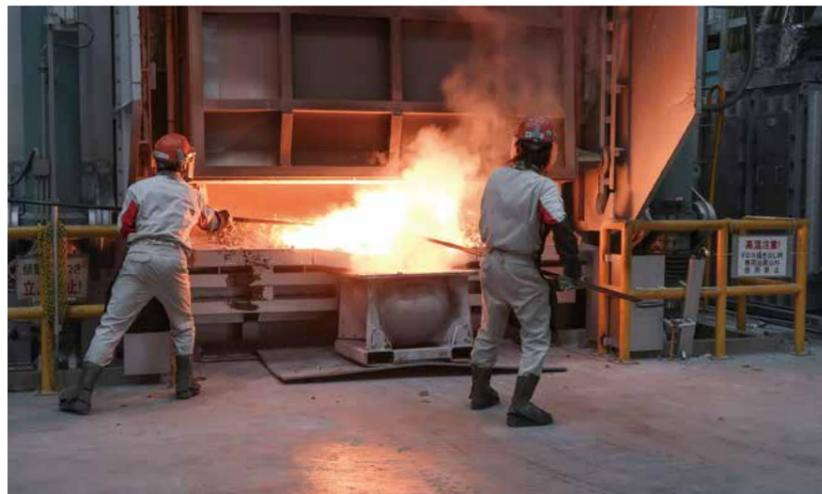
SUS福島事業所の鋳造工場の様子。ここで、新幹線の車両だったアルミのスクラップ材が溶かされ、再生された。
