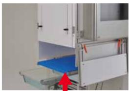
2カ所のネジを緩めて上下にスライドさせるだけで、位置調整ができます。
