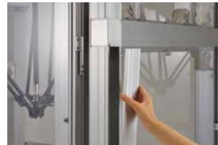
架台側面にケーブル収納用のダクトを設置。フタを外して配線を収めることが可能です。
