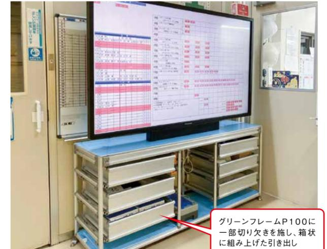
●グリーンフレームP100に一部切り欠きを施し、箱状に組み上げた引き出し
