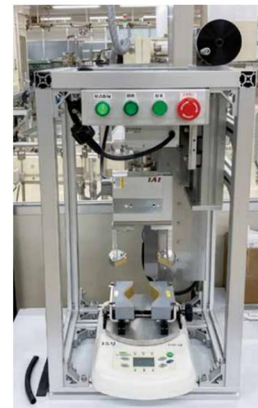
中央にボトルをセットし、スイッチを押すと自動でキャップの締め付けトルクを測定。検査用の設備などにおいても、自動化を進めている。
