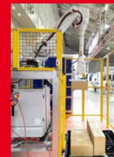
垂直多関節ロボットで段ボールを持ち上げ、写真奥のデモ機へ供給します。
