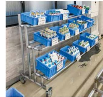
混載されて返品される製品を、種類ごとに分ける作業エリア。仕分け後の製品を載せるラックは、作業性を考え、コンテナを斜めに設置できるようにつくられている。
