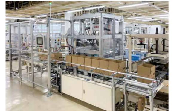
空段ボール供給部分のガイドには、アルミパイプ構造材GFも活用されている。
