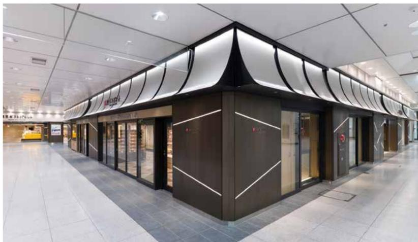
完成した東京ギフトパレットの様子。手前に見えるブロンズ色の壁装飾は、新幹線再生アルミ材100%の押出材を組み合わせてつくられている。
