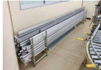
現場にストックされているSF、GFなどのアルミフレーム部材。
