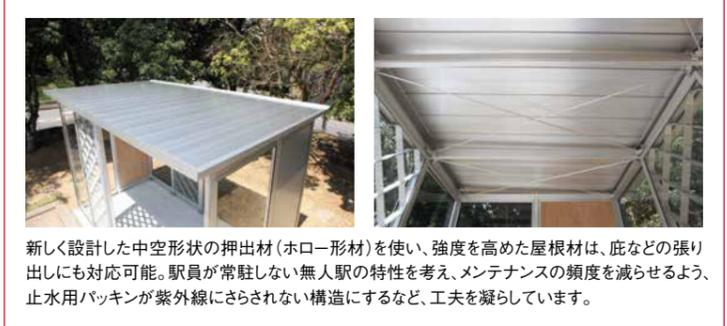
新しく設計した中空形状の押出材(ホロー型材)を使い、強度を高めた屋根材は、庇などの張り出しにも対応可能。駅員が常駐しない無人駅の特徴を考え、メンテナンスの頻度を減らせるよう、止水用パッキンが紫外線にさらされない構造にするなど、工夫を凝らしています。
