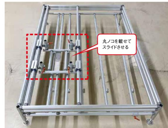
作業台の天板など、板材の切断に使用する治具もGFで製作。板を挟み、赤枠の部分に丸ノコを載せてスライドさせることで、直線でのカットを簡単にできる。
