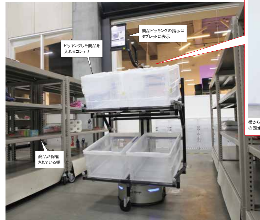
GF製の台を取り付けて4個のコンテナを搭載可能としたPEER。撮影は、見学者向けのデモンストレーションや導入前のテストを行うplayGROUND内の実証実験エリアで行った。
