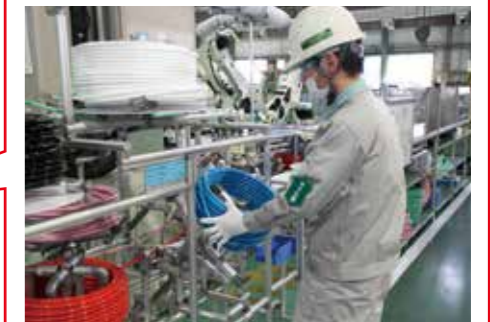
傾いたGF製のリールにホースを載せてセッティングする。
