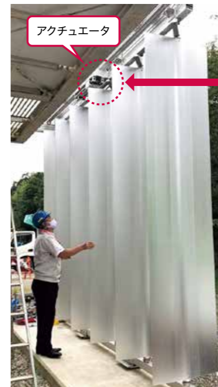
モックアップにて6枚の羽板をつなげたユニットの動きを確認。アクチュエータの動きと連動し、複数の羽板が回転する。
