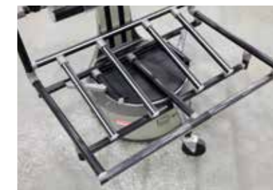
手前のフレームにはポリカーボネートのパイプを付け、コンテナの出し入れをやすくしている。
