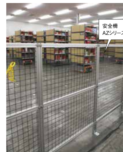
ロボットが動き回る移動棚の保管エリアは安全柵で囲われ、作業者が入れないよう明確に分けられている。
