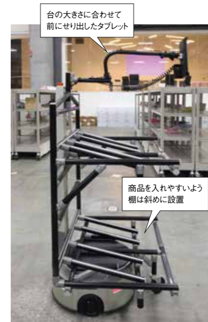
さまざまな工夫が施されたGF製のコンテナ台。棚の補強は作業の邪魔にならないよう考えて設計されている。
