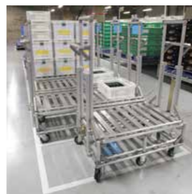
物流管理エリアで出番を待つけん引台車。ステーションごとに運ぶものと量が異なるため、複数のサイズを用意している。
