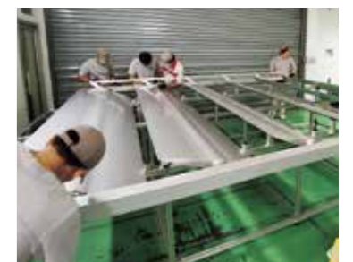
羽板が滑らかに動くよう調整しながら1つのユニットを組み上げていく。
