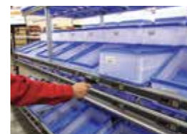
① 仕分け用コンテナとステーションの間口をバーコードで紐づける。
