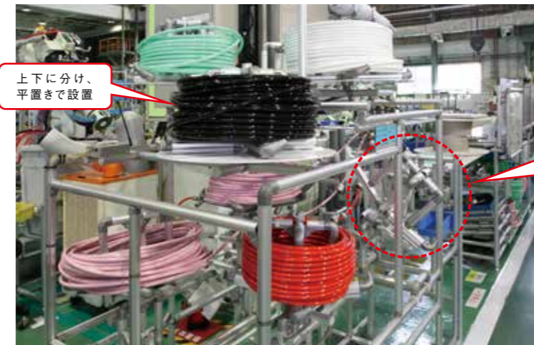
ホースの引き出し方を考えて互い違いに段を付けた2段構成で、1度に8種類の積載が可能。
