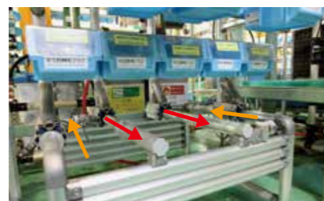
リニアスライダで棚を互い違いに移動させる仕組み。
