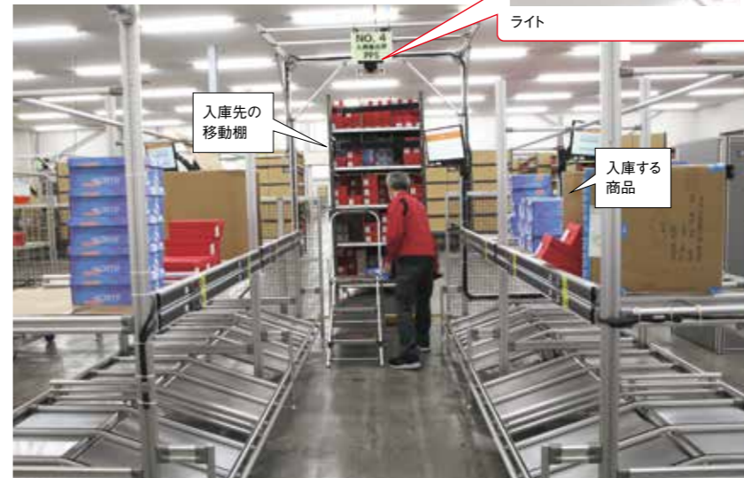
ステーションの頭上にはライトが設置され、モニターでの指示のほか、光の照射でも間口の位置を知らせる。
