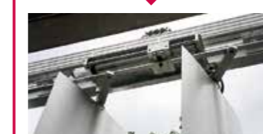
モックアップにて6枚の羽板をつなげたユニットの動きを確認。アクチュエータの動きと連動し、複数の羽板が回転する。
