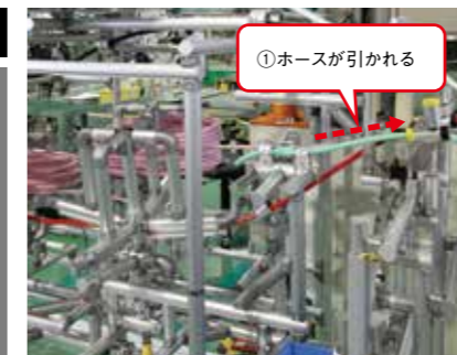
ホースがなくなると、ホースによって止められていたストッパーが外れてバネの力でトリガーが作動し、リールの根元についているアンチバックが外れてリールが傾く仕組み。
