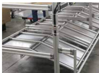
曲げフレームがレールの役目を果たし、載せた箱をスムーズに滑らすことが可能。
