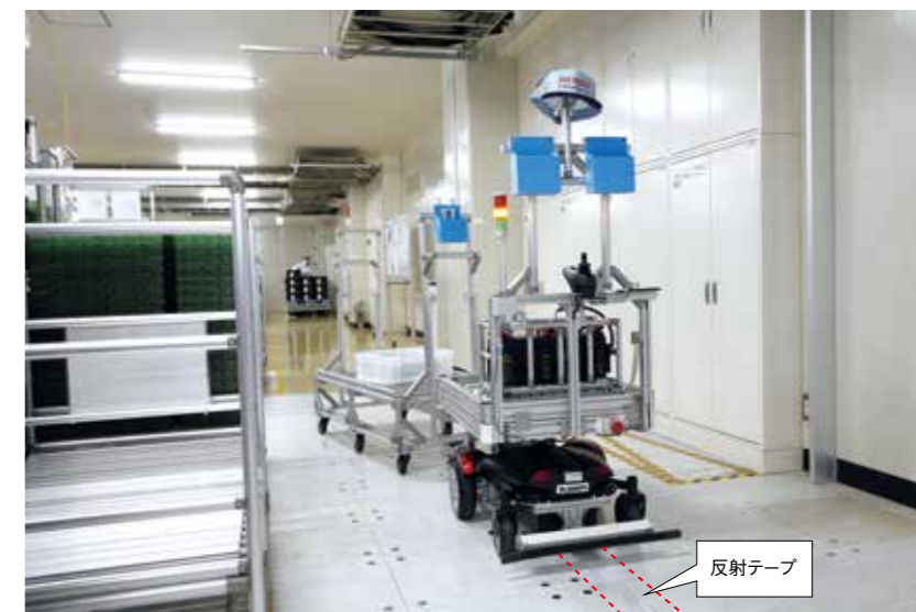
床の反射テープに沿って生産エリアを走るTHOUZER。壁が近すぎると障害物として判定し、止まってしまうためルート設計は重要。到着後は近くにいる作業者が台車を入れ替え、発進操作を行う。
