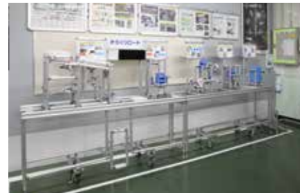
からくりロードに並ぶミニチュアからくりは、現場で使用するものと同じ外寸28mmのGF-Nフレームで製作されている。
