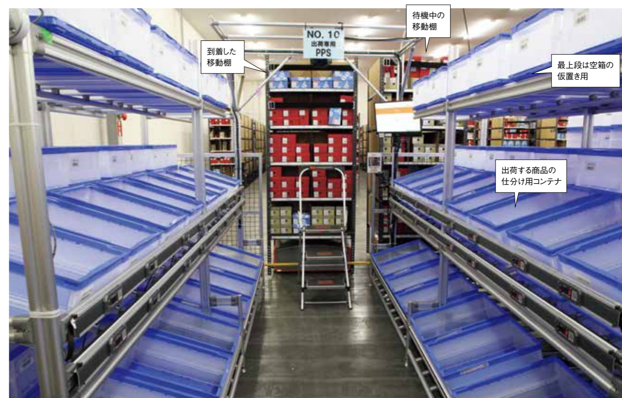
インターネット通販用の出荷を行うGF製のステーション内部。作業者は到着した移動棚の指示された開口から出庫する商品を取り出し、コンテナへと仕分けしていく。
