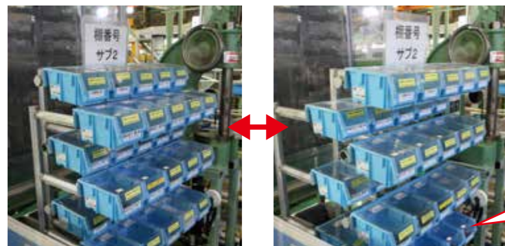
使用しないコンテナを後ろに下げることで取り間違えを予防するパーツ棚。
