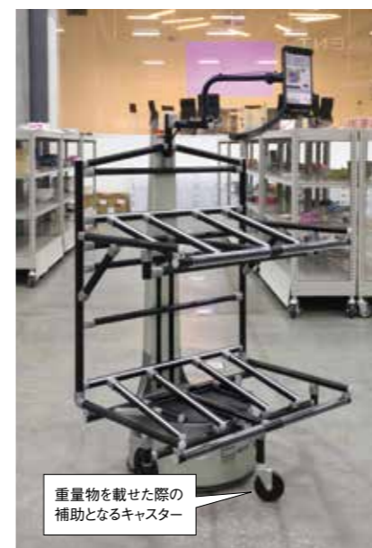
さまざまな工夫が施されたGF製のコンテナ台。棚の補強は作業の邪魔にならないよう考えて設計されている。
