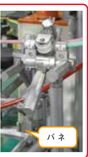
ホースがなくなると、ホースによって止められていたストッパーが外れてバネの力でトリガーが作動し、リールの根元についているアンチバックが外れてリールが傾く仕組み。
