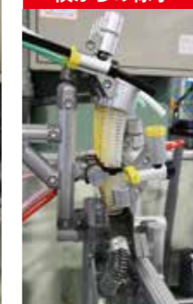
8カ所ある引き出し口にはそれぞれ鉄製のボールが仕込まれており、ホースがなくなると落下。転がったボールがセンサを作動させ、ブザーが鳴る。
