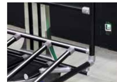
スタート位置のQRコードを読み、自分の場所を認識した後は、オーダーに従って自律走行する。
