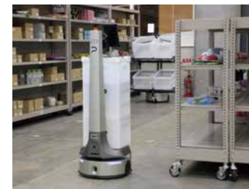
作業員1人に対して複数台のPEERが動きピッキングをサポートする。
