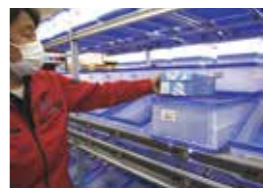
② 移動棚の指定された間口から出荷する商品を取り出し、対応するコンテナへ入れる作業を必要なアイテムがそろうまで繰り返す。
