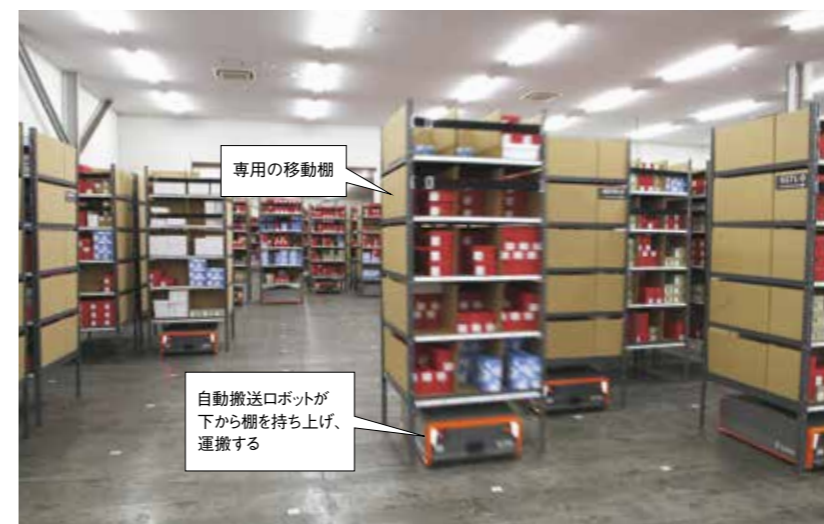
写真奥の部屋にも続く移動棚の保管エリア。ロボットは床のQRコードを読みながら場内を走行する。
