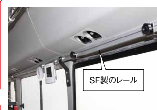
写真右側のレールには小物類を配置。好きな場所への移動も簡単に行える。
