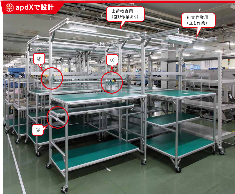
新工場への移転に向けて製作された作業台。基本の形をベースに、用途に合わせて足回りやサイズなどの仕様を変えて設計されている。
