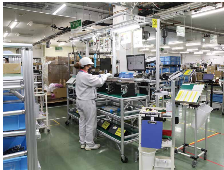
パソコンやライトが設置された正面の台と、製品を載せた手前の台車は分かれており、作業が完了したら載せ替えをせず、そのまま次の工程へと運ぶことが可能。
