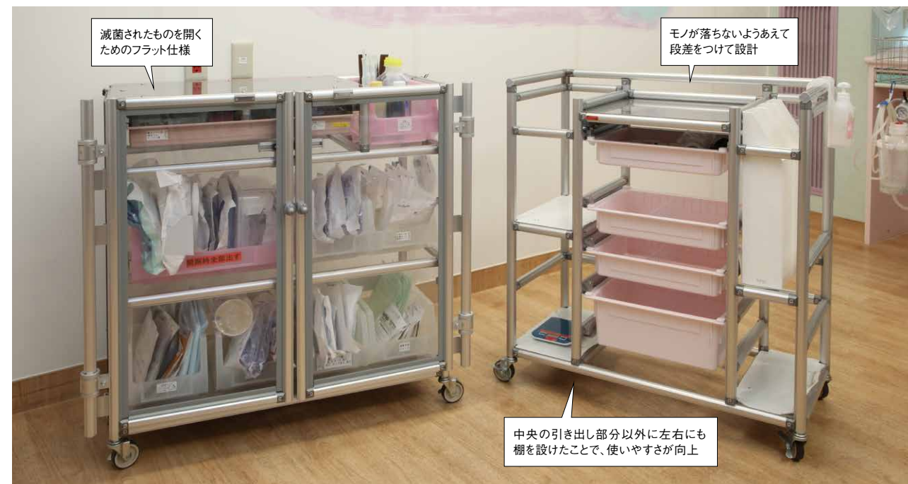
主に緊急時に使うアイテムを収納した開胸ワゴン(左)と、日常的に使用されるベッドサイドワゴン(右)。開胸ワゴンの扉は清潔さの観点で後から取り付けられた。
