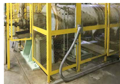
原料となるアルミニウム粉末を、硬質なボールと混ぜて回転させ、粉碎するボールミル。
