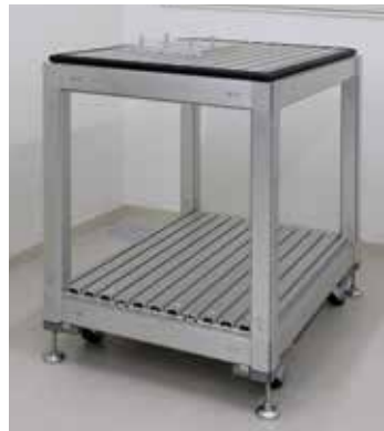
少し前まで、初号機用のロボットが載せられていたZF架台。上下の天板の溝を活用しオプションの取り付けが可能。
