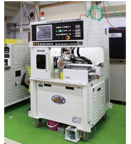
小型円周自動溶接装置の外観。溶接中は上のモニターに様子が映し出されるようになっている。
