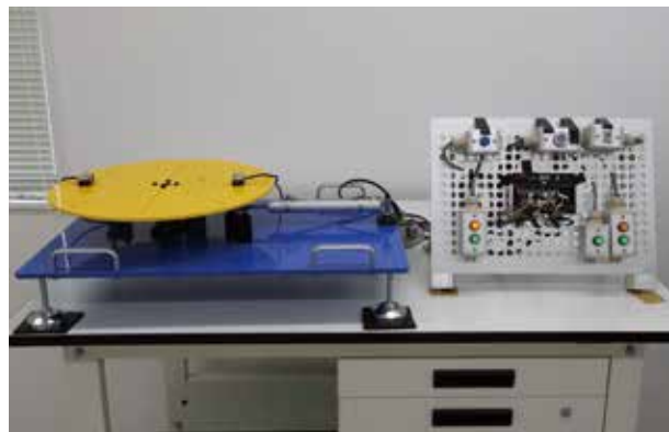
鋳造品が載っているか否かを判定した上で、テーブルを回転させる装置のテスト機。SiOで制御し、動きを確認しながらプログラミングを進めた。
