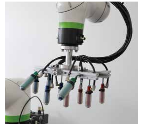
エアで先端のゴムを膨らませ、ワークを把持する独自開発のMKグリップ。ゴムだけの交換が可能なたまらぬランニングコストも抑えられる。
