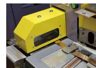
初めに素材となる薄板の端を切断し、突き合わせ面の状態を整える。
