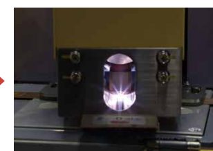
スイッチを押すとカバーが前進し、設定された条件で自動溶接を実施。
