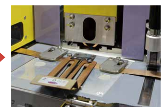
溶接時の熱吸収などの役割も果たす治具を素材の上にセットする。
