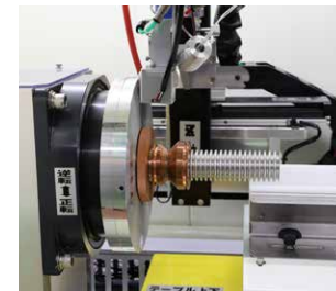
エアチャックでチューブと継手を適切な位置で加圧密着させる。
