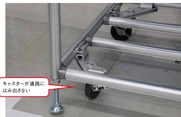
他拠点での作業者の転倒災害を機に足回りの設計を変更した棚車。四隅のアジャスターで、棚車自体の転倒も予防する。現在、新規で導入されるものはこの仕様で統一されている。
