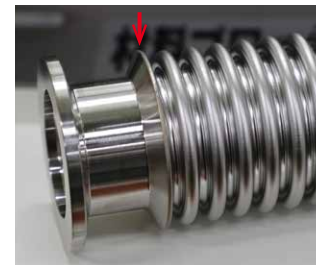
溶接が完了したワーク。チューブと継手が均一に溶接されている(赤印印部)。
