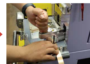
固定されていた薄板を外し、溶接した個所に圧延をかけたら一連の作業が完了。
