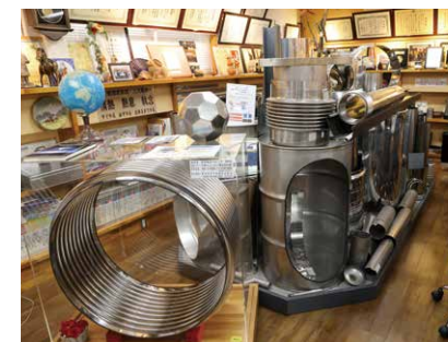
板材を円筒状に溶接したものを中心とする大型のサンプル。その後の加工に耐えられるよう均一な品質が求められる。
