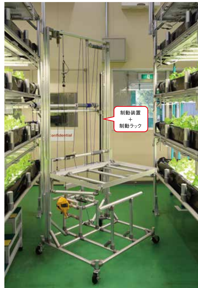
台車全景。バランサーやバネ、動滑車、制動装置などを組み合わせて昇降の機構を構築している。
