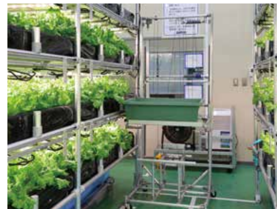
トレーを載せた台車を収穫する棚の横へ運び、からくり機構で高さを合わせる。
