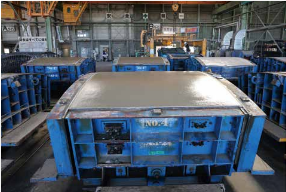
型枠に生コンを流し込んだ後は、3時間ほどかけてセグメントの表面を整えていく。
