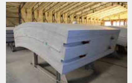
検査ヤードに運ばれ、次の工程を待つセグメント。写真右手前側の端面には鋳物製の継手金物が埋め込まれている。
