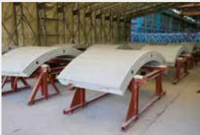
水路に使用されるセグメント。用途や規模に応じて、厚みなどが大きく異なることが分かる。
