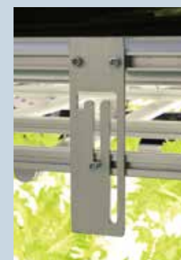
シンプルな仕組みでLEDの高さ調節を実現。LEDはSF製の枠に取り付けられており、プレートにかけられる位置を変えることで、まとめて上げ下げが可能となっている。
