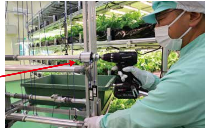
1方向のみに回転する可動パーツ、ワンウェイクラッチで、巻き上げた状態を保持。リリースプレートを解除した後はゆっくり下がるよう、制動装置などと組み合わせて使用している。
