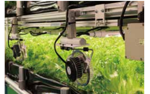
熱がこもらないように棚の側面に設置された小型扇風機。GFのコネクタを活用し、機器を固定している。
