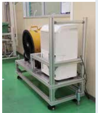
栽培室内の空気を循環させる送付機などを載せたSF製台車。
