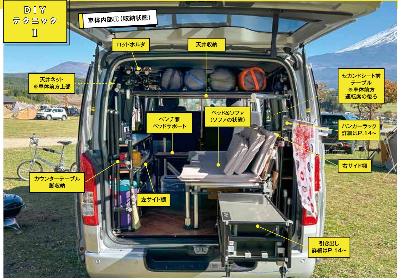
車体内部に突っ張るような形で取り付け、骨格となる「メインフレーム」を中心に天井部分も有効に活用し、設備を配置しています。
