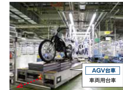
載せている車種に合わせてルートを自動選択。次工程の空き具合によって進むタイミングも調整する。
