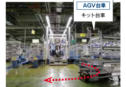
空になったキット台車は車両用のAGV台車とは別のルートを通り、部品の段取り工程へ戻る。
