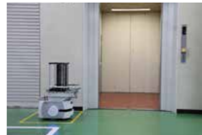
プリント板を載せたAMRは所定の場所で止まってエレベータに信号を送り、自動で乗り込んで移動する。
