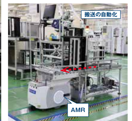
光電センサがAMRの到着を検知すると、電動ストッパを下げ、プリント板が載ったマガジンラックを排出する。
