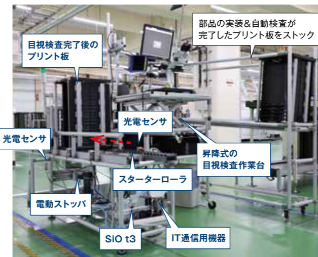
光電センサがAMRの到着を検知すると、電動ストッパを下げ、プリント板が載ったマガジンラックを排出する。
