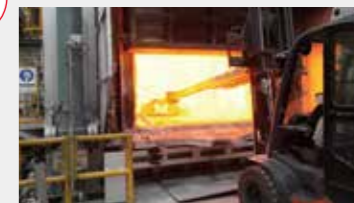
高温の炉でアルミを溶かし、ビレットに再生します。
