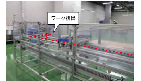
製作中の搬送設備。レールの傾きによってワークの積載面を傾け、ワークの排出方向をコントロールする仕掛けとなっている。
