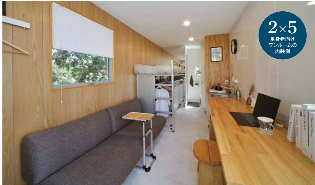
玄関側から見た新型t 2 -01モックアップの内装。シャワールームとトイレを突き当たりの位置にまとめ、広い居住空間を構築しました。窓には室外側にアルミを、室内側に樹脂を使用した複合サッシを採用し、断熱性能を高めています。ミニキッチン側の様子は、本誌52号 P.15-18「G-Fun DIYテクニック2」に登場していますので合わせてご覧ください。
