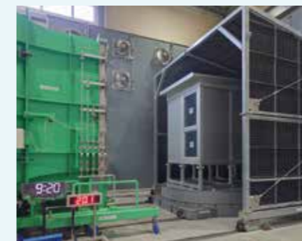
ターンテーブルを回転させて試験体の角度を変え、各側面および斜め方向から、水と風を噴霧しました。
