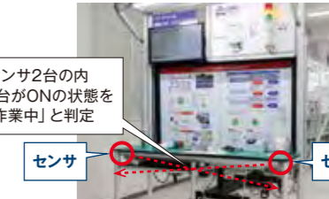
AirGRID WDシリーズの仕組みや作業台の構成を確認できる展示用の作業台。
