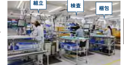
GFで標準化された作業台が並ぶライン作業の現場。各作業台に1台ずつ信号灯と送信機が設置されている。
