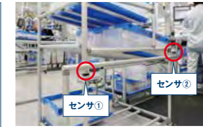
通路の前後に取り付けられたセンサが反応する順番によって作業者の出入りを検知している。
