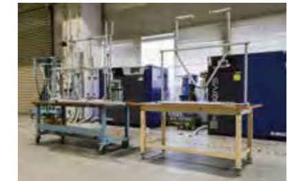
試作中のからくり。左は重量のある製品の持ち上げを補助する昇降装置、右は折り畳みコンテナを自動で置く機構を検討中。
