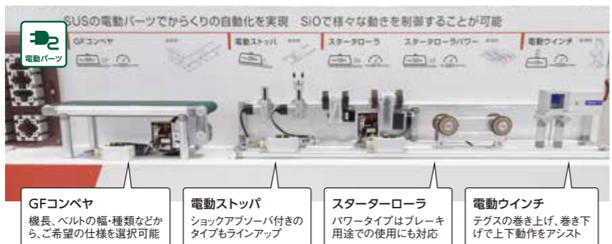
シンプルな電動化でからくりをアシストする電動パーツは、ストロークの長さや方向、可搬質量などが異なる多様なアイテムをラインアップ。いずれもGFへ簡単に取り付けことができ、SiOやセンサなどを併用し、必要に応じて複数の電動パーツを組み合わせることで、手軽に自動化を実現できます。
