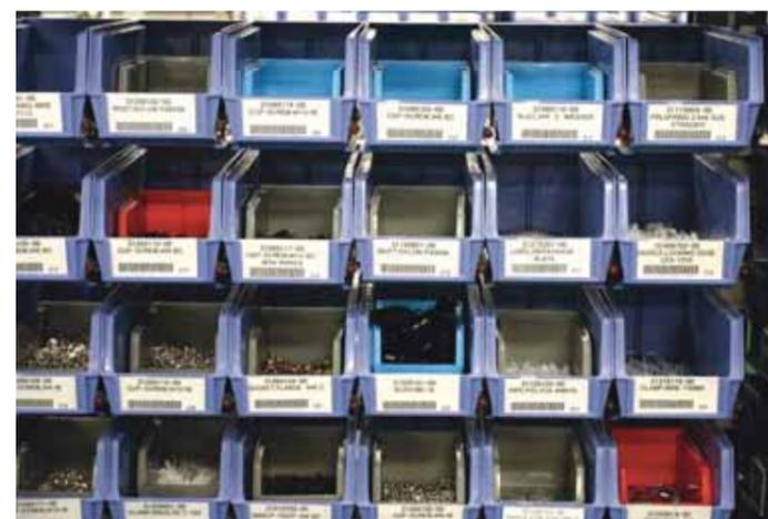
ツールボックスのランプが点灯して作業員に必要な部品を指示する。取り出す部品数も管理している。
